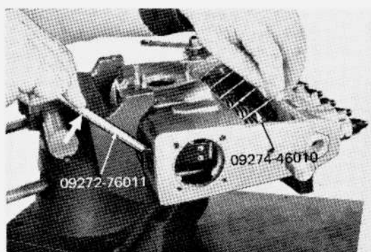
Fig. 3-61 Removing Tappet Insert
