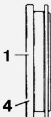
Ensamblado del sincronizador de 1ª-2ª. 1. Desplazable - 2. Cubo de sincronizador - 3. Ranura de engrase a orientar hacia el lado del piñón de 1ª - 4. Cara a orientar hacia el piñón de 1ª.
