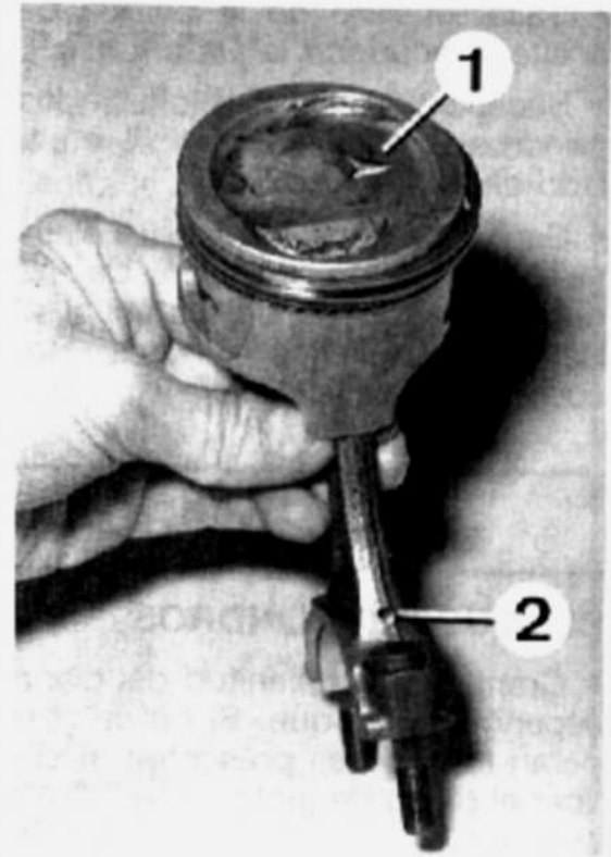
Sentido de montaje de biela y pistón 1. Flecha hacia la distribución - 2. Surtidor de aceite.
