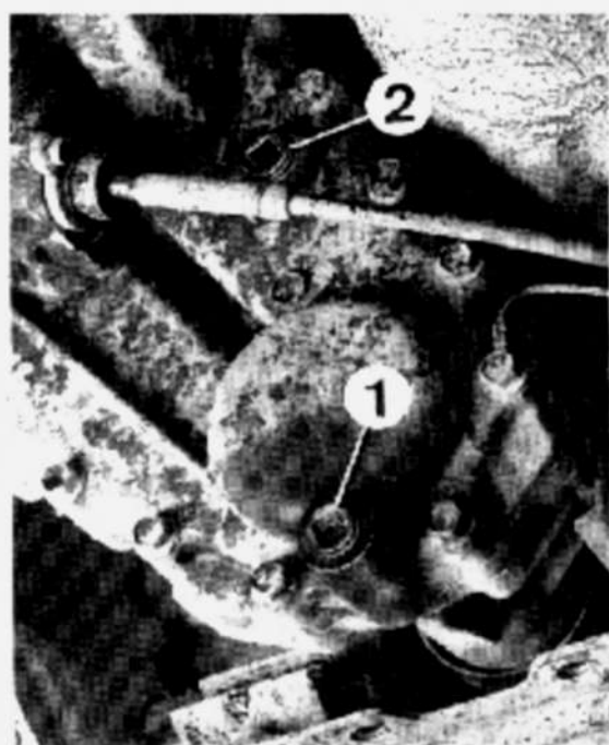
Caja de reenvío. 1. Tapón de vaciado - 2. Tapón de llenado y de nivel.
