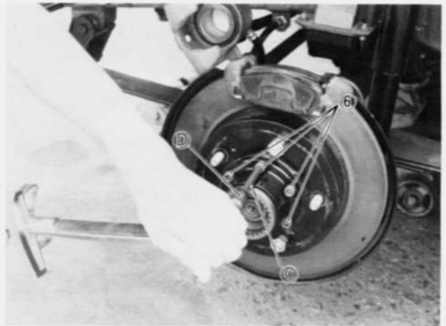
Fig. 17-5-28 Special Tool (C) (Hexagon Bit 6mm 09900-00414) Special Tool (D) (Hexagon Socket 09900-00411)
