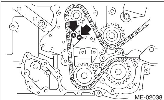
14) Remove the idler sprocket (upper).
