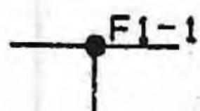
分岐点付近の記号は分岐点のロケーションを示すためのタイトル記号です。分岐点のロケーションは別冊の「分岐点配置図集」を参照。
