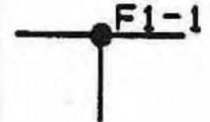
分岐点付近の記号は分岐点のロケーションを示すためのタイトル記号です。分岐点のロケーションは別冊の「分岐点配置図集」を参照。
