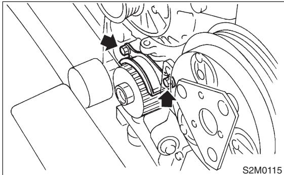
14) Remove crankshaft sprocket.
