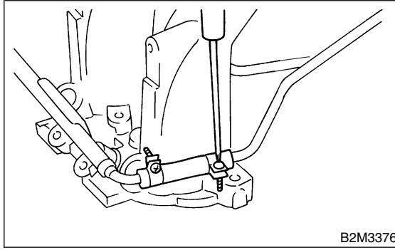
23) Remove fuel injector pipe.
