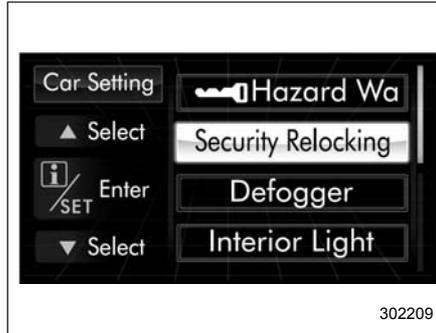
2. Выберите пункт "Security Relocking" (Повторное запираение дверей в целях безопасности) при помощи клавиш "▲" и "▼", а затем потяните клавишу "[i]/SET" на себя.
