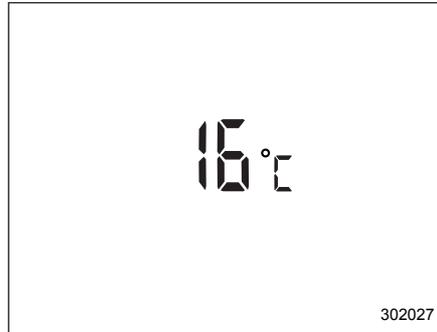
Индикатор температуры наружного воздуха показывает температуру наружного воздуха в диапазоне от -40 до 50 °C.
