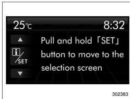
Если потянуть и удерживать клавишу "[i]/SET", отображается экран выбора. Содержание экрана можно задать или изменить на экране выбора. За более подробной информацией обратитесь к разделу "Экран выбора" 3-58.
