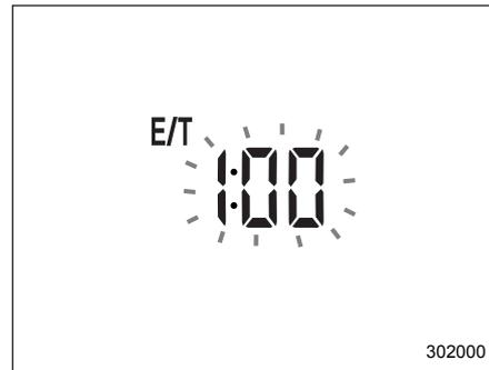
Индикатор длительности поездки мигает по истечении каждого целого часа. Если на дисплей выдаются другие показания, вместо длительности поездки, то дисплей переключается на длительность поездки, мигает в течение 5 секунд и возвращается к изначальным показаниям по истечении каждого целого часа.
