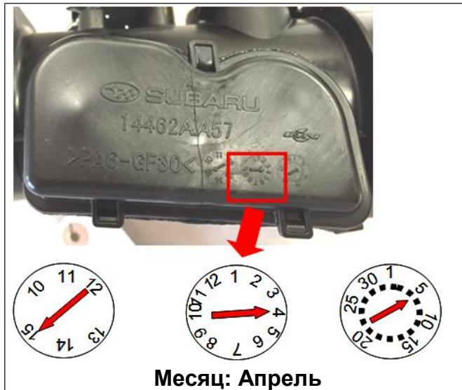
Примечание: Не проверяйте показанный ниже номер, который виден со стороны передней части автомобиля.
