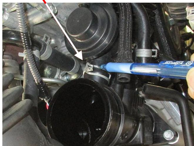
1.9 Отверните болты, которые крепят впускной патрубок №1 к турбонагнетателю, и снимите впускной патрубок №1.
