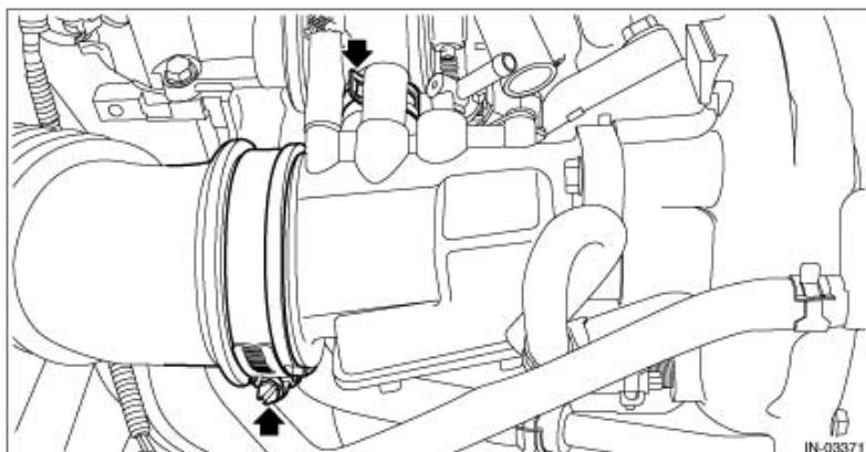
2.-4 Подсоедините трубку вентиляции картера (A) и вакуумный шланг (C) к впускному патрубку №1, и подсоедините шланг вакуумного управления (B) к электромагнитному перепускному клапану турбонагнетателя.
