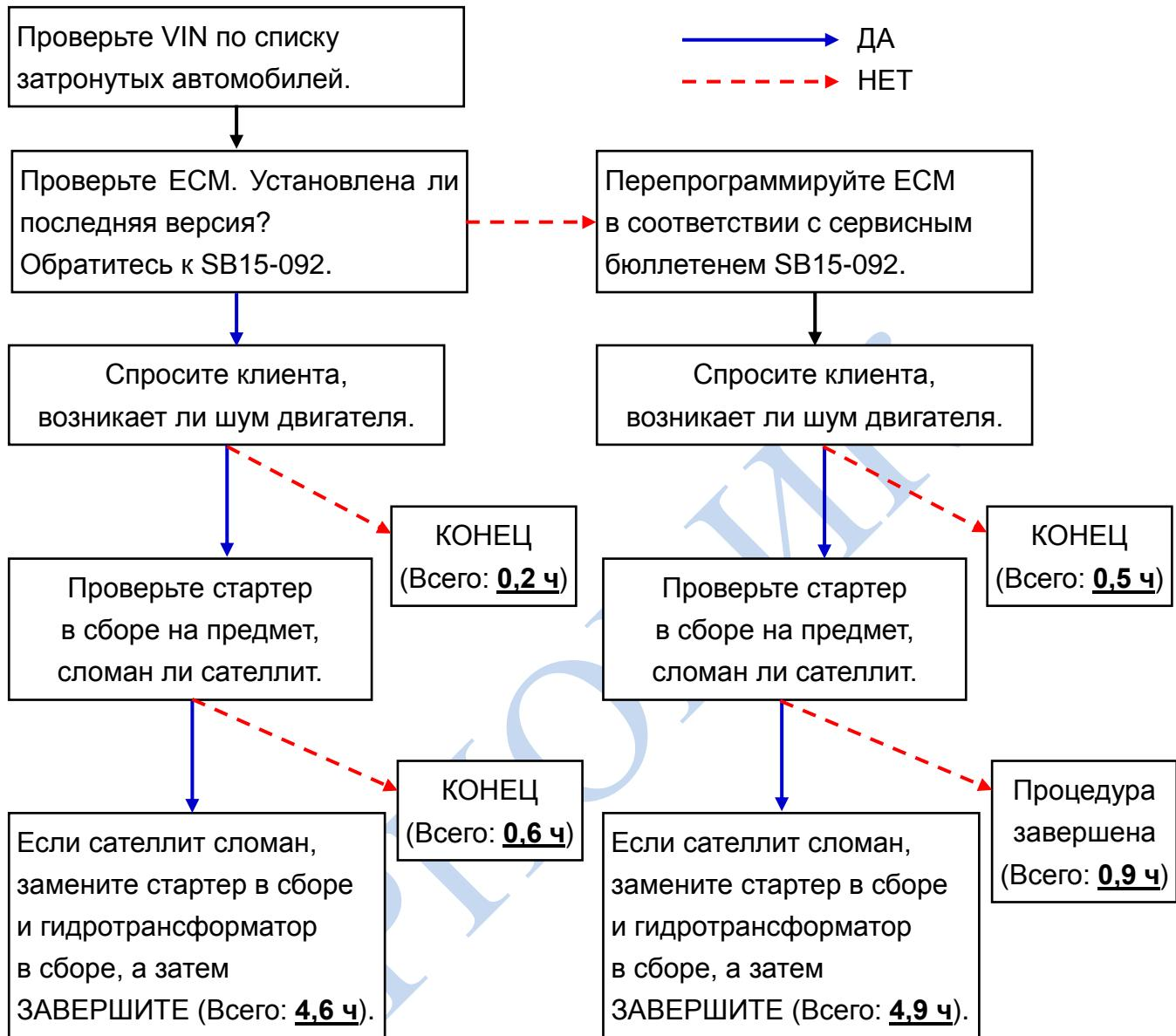
Примечание: Метод замены стартера в сборе и гидротрансформатора в сборе приведен в соответствующем руководстве по обслуживанию.
