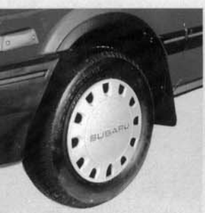
Kunststoff- Schutzschalen in den vorderen Kotflügeln
