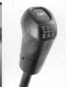
Schalthebel für Allrad- und 5-Gang- Getriebe
