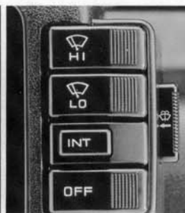
Intervall-Scheibenwischer mit elektrischer Wisch-/Wasch-Anlage und Intervall-Schaltung
