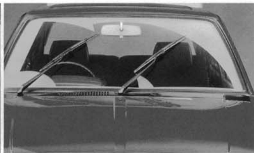
Intervall-Scheibenwischer mit elektrischer Wisch-/Wasch-Anlage und Intervall-Schaltung
