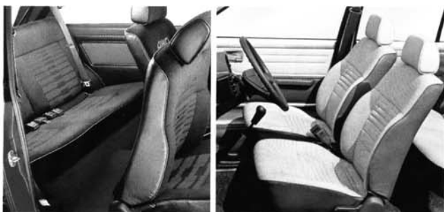
2 Automatik- und 1 Becken-Höhenverstellbare Kopfstützen gurt auf den Rücksitzen vorne
