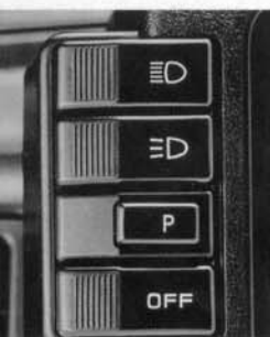
Übersichtliche Armaturen mit Drehzahlmesser und zündunabhängiger Lichtschaltung
