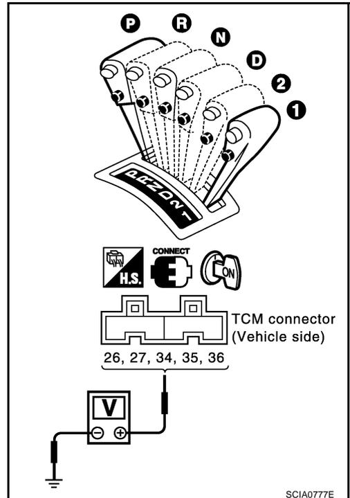
3. CHECK OVERDRIVE CONTROL SWITCH CIRCUIT
