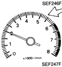
Motorhaube öffnen und den Motor mit ungefähr 2.000/min etwa 2 Minuten lang ohne Last betreiben.
