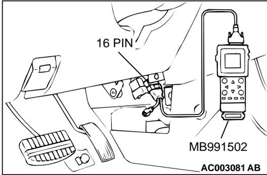
**DTC P0755: Shift Solenoid B Malfunction**
