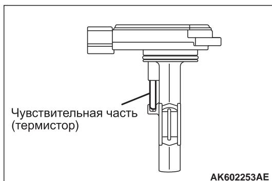
Датчик температуры всасываемого воздуха встроен в датчик расхода воздуха. Датчик температуры всасываемого воздуха определяет температуру всасываемого воздуха по изменению сопротивления термистора и выдает в ЭБУ двигателя напряжение, соответствующее температуре всасываемого воздуха. ЭБУ двигателя использует данное выходное напряжение для компенсации управления впрыском топлива и управления опережением зажигания. Свойства датчика приведены на рисунке.
