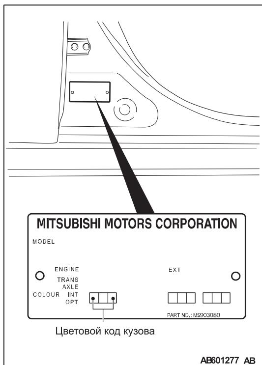
Код цвета кузова нанесён на паспортную табличку, установленную под центральной стойкой (справа)
