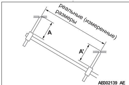
Тип "В" (фактические размеры, полученные при измерении) – это фактическое расстояние между точками измерения. Измеряется с помощью штангенциркуля, рулетки и т.п.
