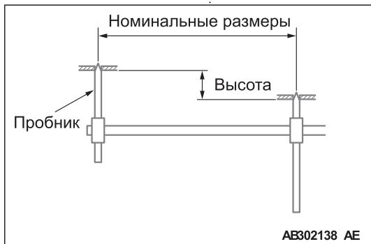
Тип "А" (размеры проекций) – это размеры отображения измеряемого участка на плоскость.
