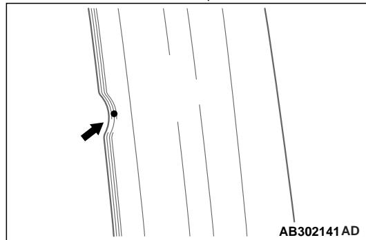
При использовании рисок для измерения размеров установите точку измерения в центре риски.
