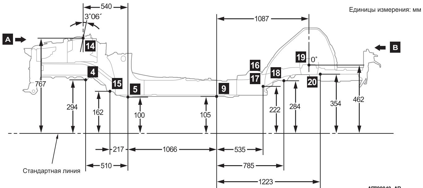
ПРИМЕЧАНИЕ. Предполагаемый стандартный уровень устанавливается на отметке 100 мм под точкой измерения №5.
