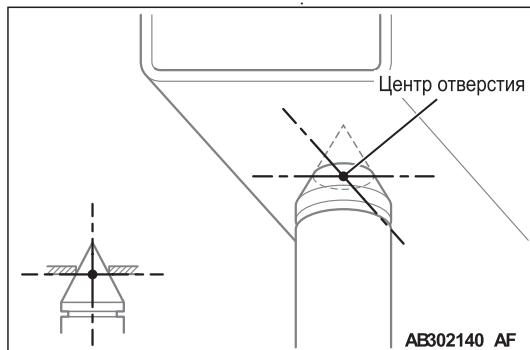
Плотно вставьте щупы штангенциркуля в отверстия измерения.
