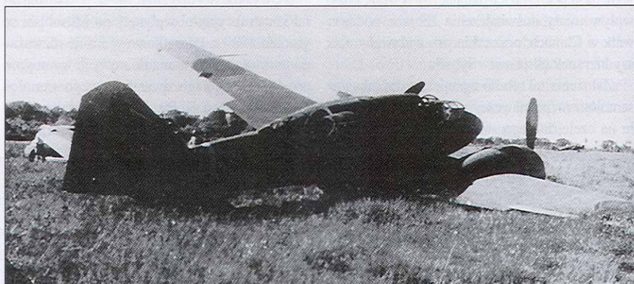
Podczas gwałtownego lądowania nagminie dochodziło do samoczynnego składania się goleni podwozia głównego.
