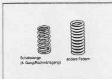
1. Die Feder und die Kugel (5. Gang/Rückwärtsgang) in das Lagergehäuse einbauen.
