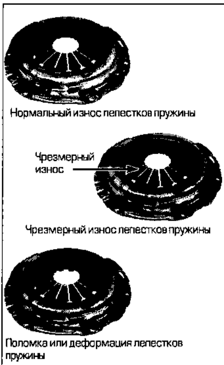
Рис. 3.12, б. Замените нажимной диск при следующих неисправностях
