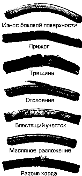
Рис. 8.3,а. Типичные повреждения приводного ремня
