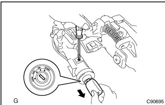
**25. REMOVE IGNITION SWITCH LOCK CYLINDER ASSY**
