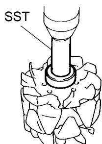
(d) Using SST and a press, press in a new bearing.
