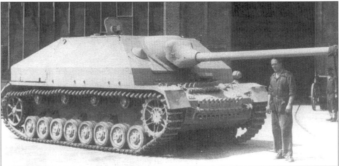
Прототип Jagdpanzer IV/70(A) с рубкой, разработанной фирмой Alkett. Отсутствует подпорка под стволом, опорные катки с резиновым бандажем.
