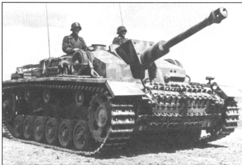
Sturmgeschütz Ausf.F, машина вооружена пушкой «7,5cm Sturmkanone 40 L/43». Первым получил такие штурмовые орудия (№№ шасси 91037-91045) Sturmgeschütz-Abteilung дивизии «Великая Германия».
