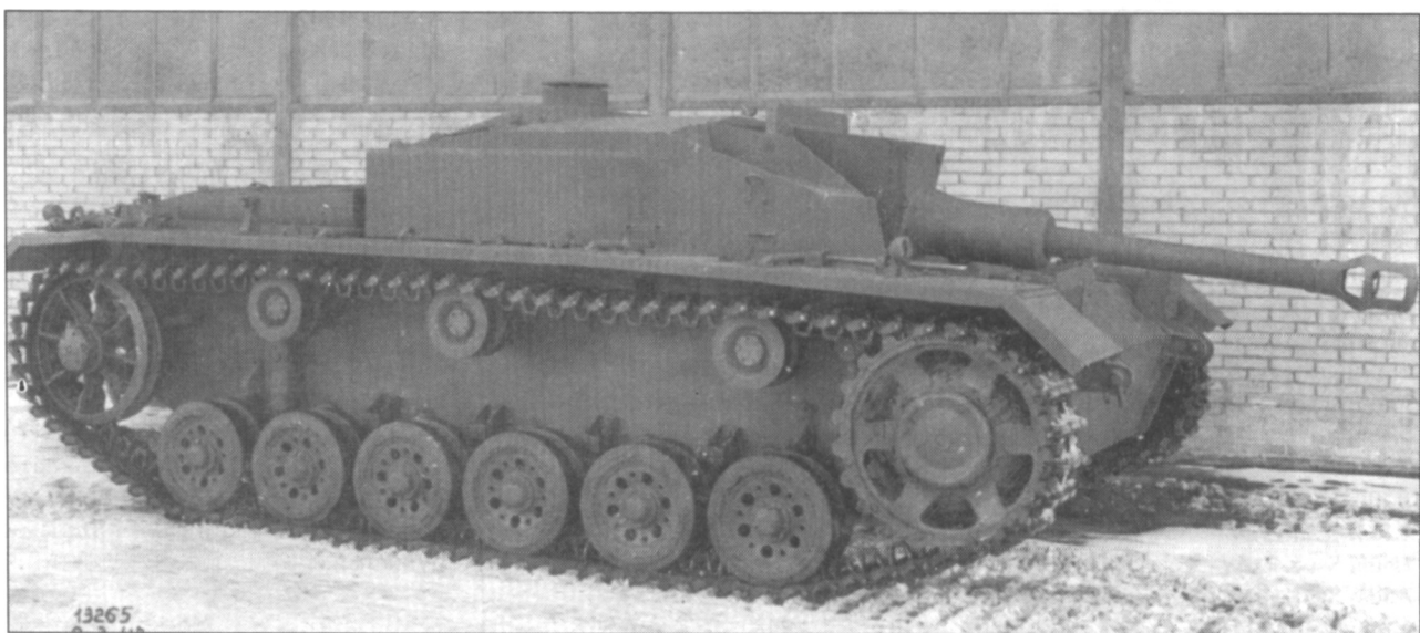
Опытный образец штурмового орудия модели Ausf.F, вооруженного пушкой «7,5cm Sturmkanone 40 L/43», машина оборудована прицелом Rundblick-Fernrohr, предназначенным для стрельбы с закрытых позиций.
