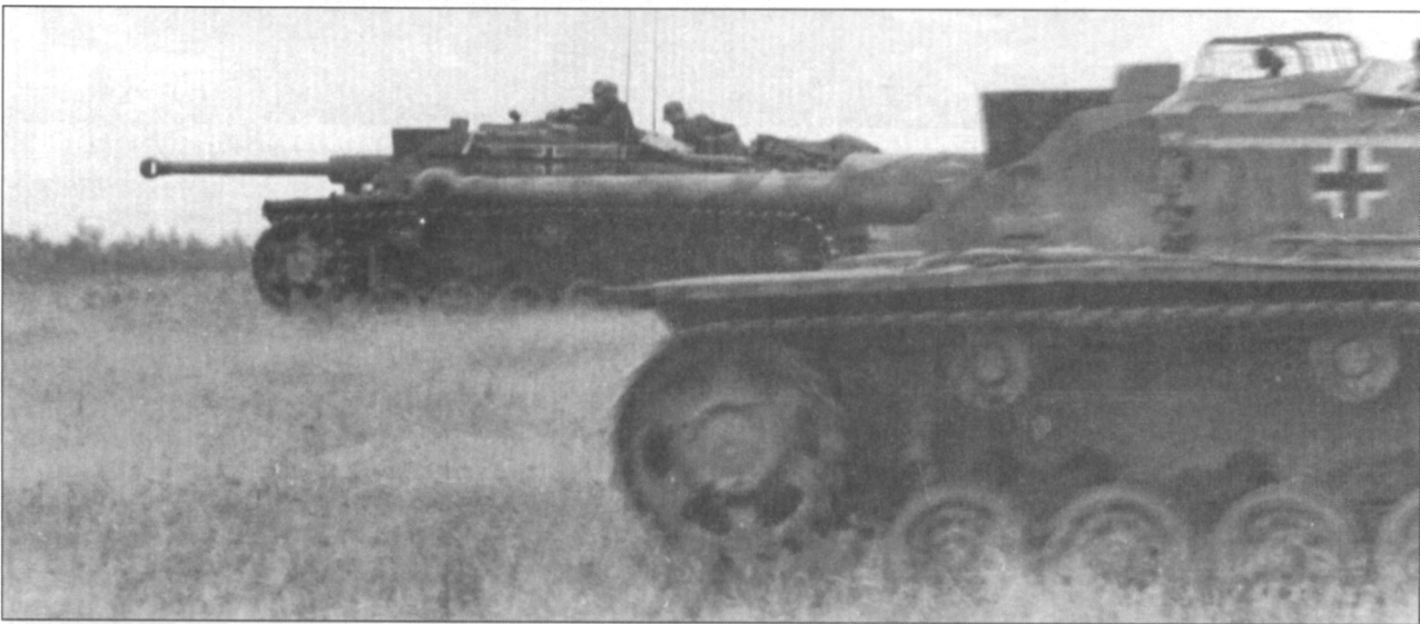
Sturmgeschutz Ausf.F/8, из-за нехватки материалов часть машин продолжала комплектоваться однокамерными шаровидными дульными тормозами старого образца.
