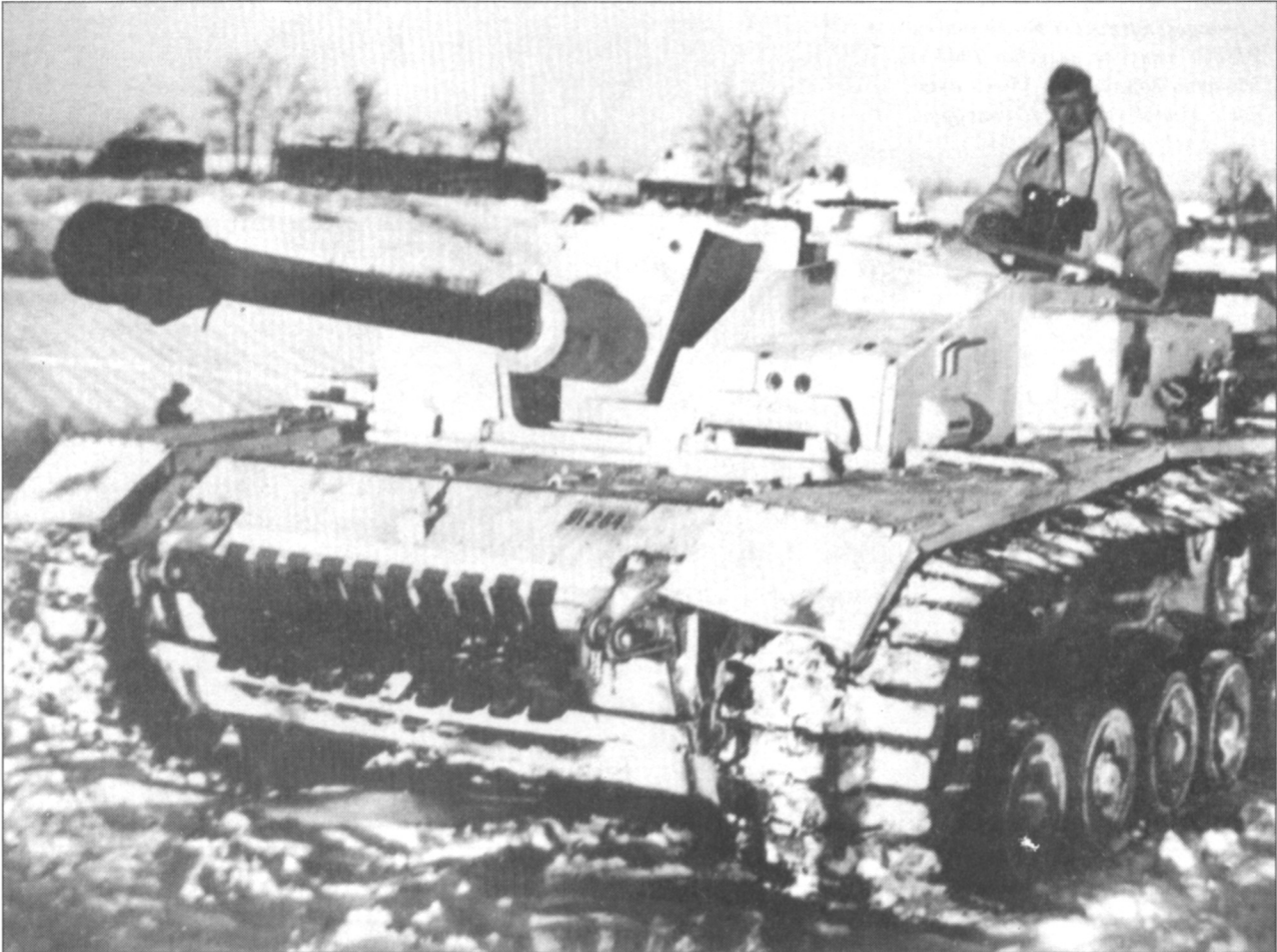
Sturmgeschütz Ausf.F, обратите внимание на зимние траки гусеницы и 75-мм орудие с длиной ствола 48 калибров.
