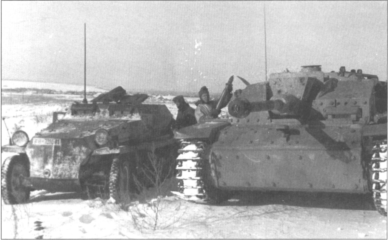
Погрузка боезапаса в штурмовое орудие. Обратите внимание на установленную на болтах дополнительную лобовую броню.
