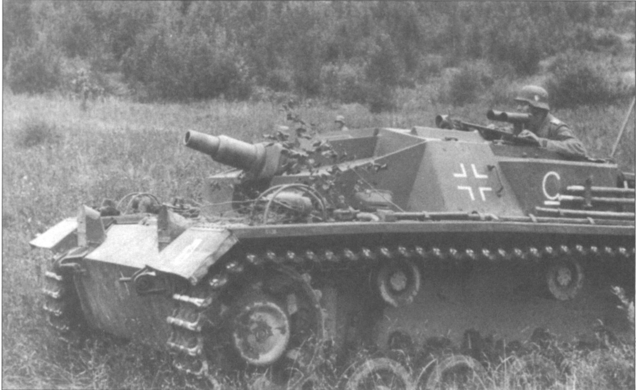
Хорошо видны изменения, произошедшие во внешнем облике штурмовых орудий StuG III Ausf. C/D по сравнению с предыдущими вариантами. В лобовом листе рубки отсутствует вырез под прицел, оптическая головка которого теперь выводится через верх боевого отделения. Командир использует для наблюдения обычный артиллерийский бинокулярный перископический прибор. По написанному на крыле номеру шасси (90630) можно установить, что на снимке - штурмовое орудие StuG III Ausf. D.
