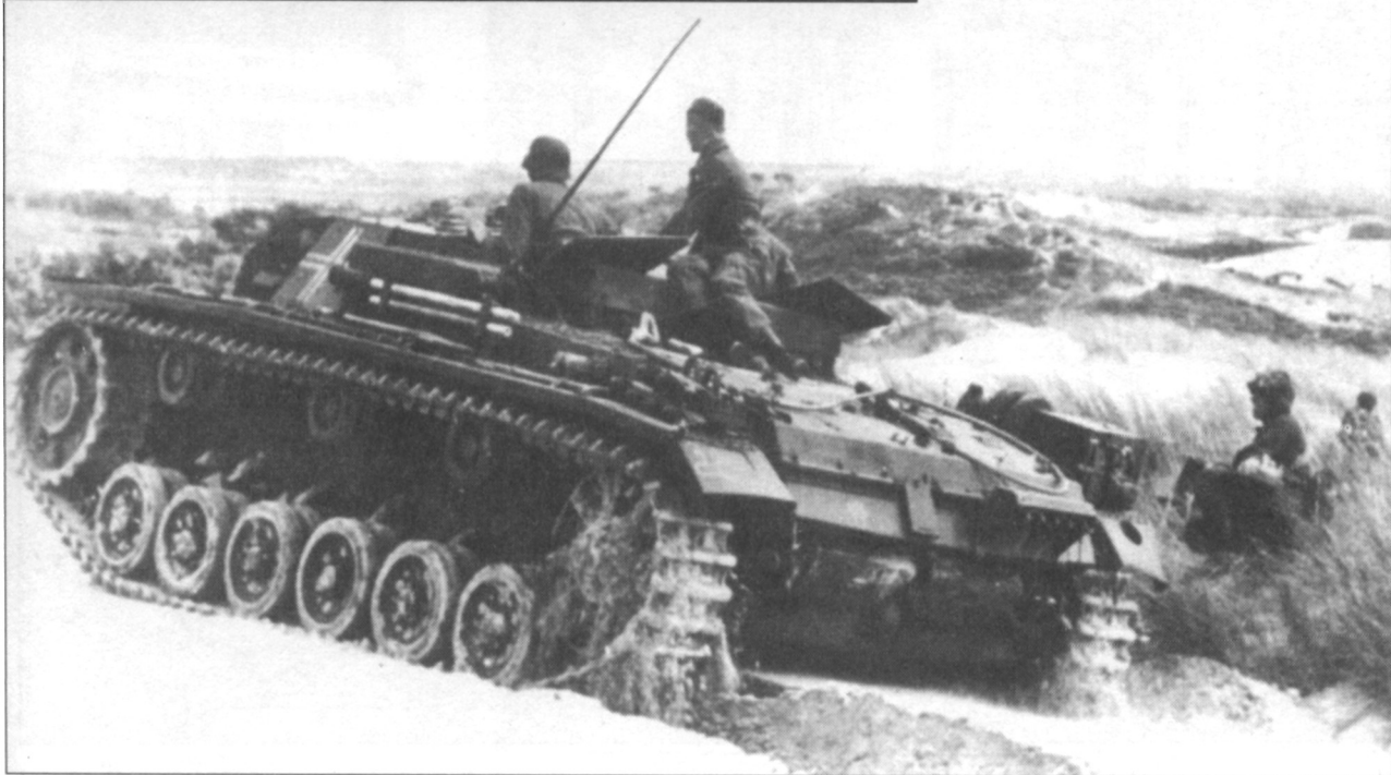
Одно из первых штурмовых орудий Sturmgeschutz Ausf.B 667-й батареи, снимок сделан 12 сентября 1940 г. Ведущее колесо старого образца доработано под гусеницу с траками Kgs 61/400/120 шириной 400 мм.
