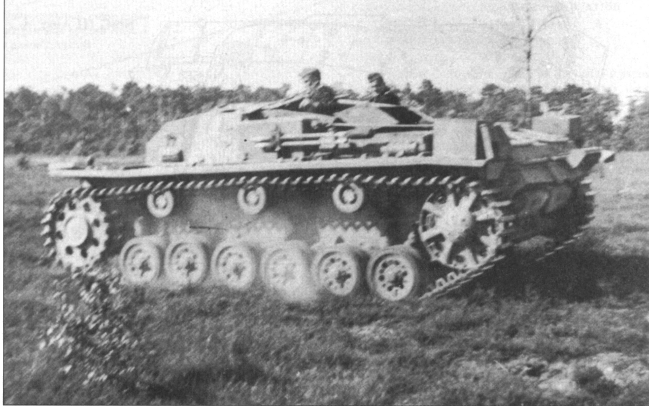
Штурмовые орудия модели Ausf.A строились на базе шасси танков PzKpfw III с гусеницами шириной 360 мм. Отличительной чертой шасси являлось наличие бронекорпака на кормовом бронелисте корпуса, закрывающим отверстие под инерционный ручной стартер.
