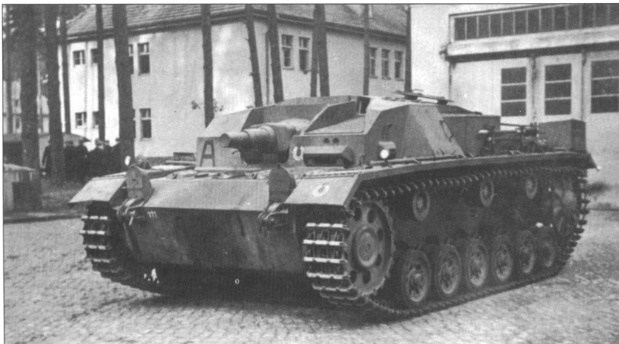
Штурмовое орудие модели Ausf. B, номер шасси этой машины, изготовленной фирмой Алкетт, - 90111, снимок сделан в Ютеборге в июле 1940 г. Машин пока еще несет характерные для Ausf. A черты: ведущее колесо и ящики для инструментов в кормовой части бортовых крыльев.
