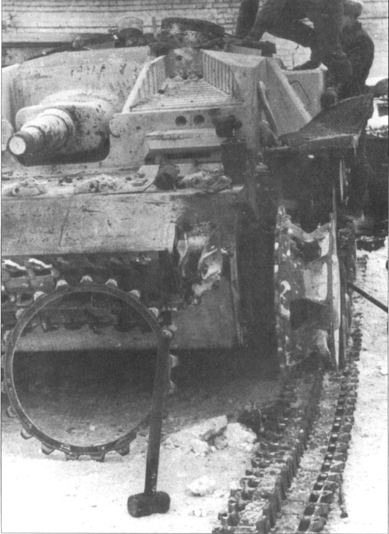
Ремонт установки Sturmgeschütz Ausf. B, на этой машине установлен в ходе модернизации прицел Sfl. ZF1, прицелами данного типа изначально комплектовались штурмовые орудия модели Ausf. C.
