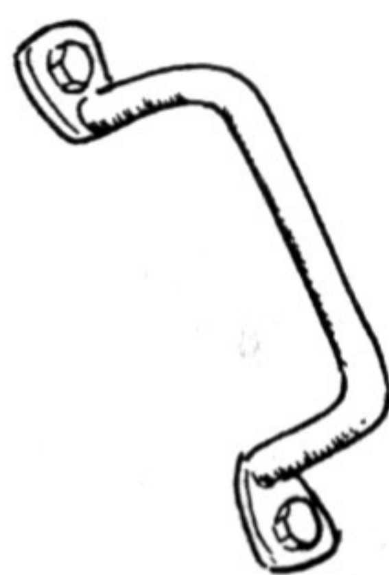
Ручка на боковой стенке рубки
