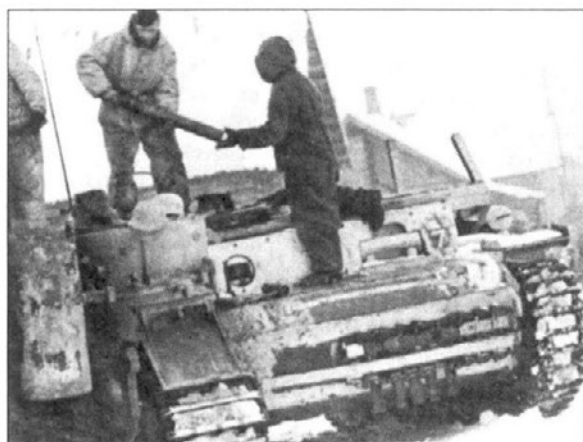
Для подвоза боезапаса к тяжелым танкам Тигр в качестве транспортеров боеприпасов часто использовались переоборудованные устаревшие танки, которые могли непосредственно сопровождать Тигры. Такой переоборудованный танк PzKrfw III ausf L, сфотографированный зимой 1943-1944 года, закамуфлирован белой каской, под ней видна темно-желтая базовая окраска. Белый номер, означает 7-ю машину подразделения штаба батальона.
