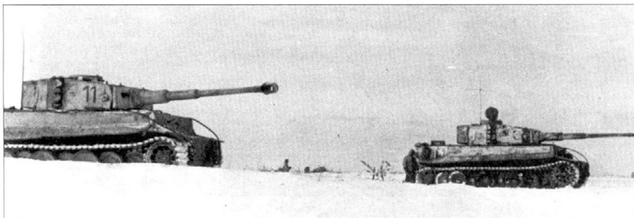
Другой снимок тех же самых двух Тигров демонстрирует результат различного выполнения белой камуфляжной окраски. Тактический номер на башне левого Тигра - черный. Машина справа - командирский танк с дополнительной радиостанцией и звездообразной антенной.
