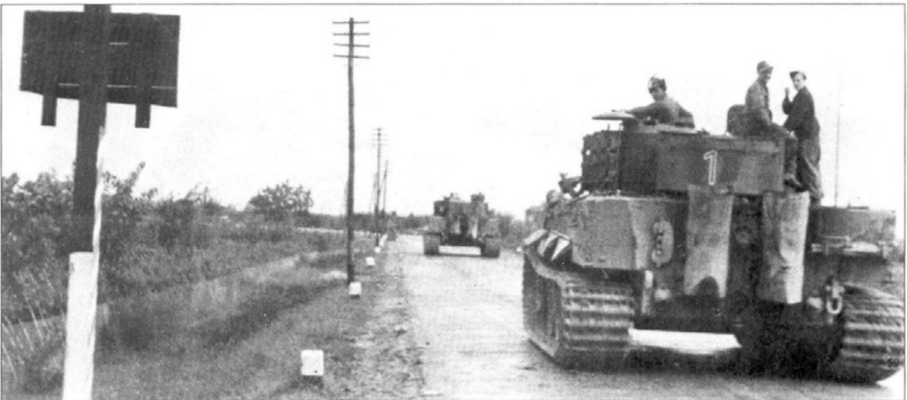
Типичный вид танка Тигр I поздних производственных серий из 503-го тяжелого танкового батальона полка «Баке». Запасные гусеничные траки, укрепленные на башне, служат для повышения эффективности бронирования. Цвета камуфляжной окраски часто используемой этим подразделением - темно-желтый и красно-коричневый. Обратите внимание на контраст между влажными и сухими участками грязи, которой забрызган танк.
