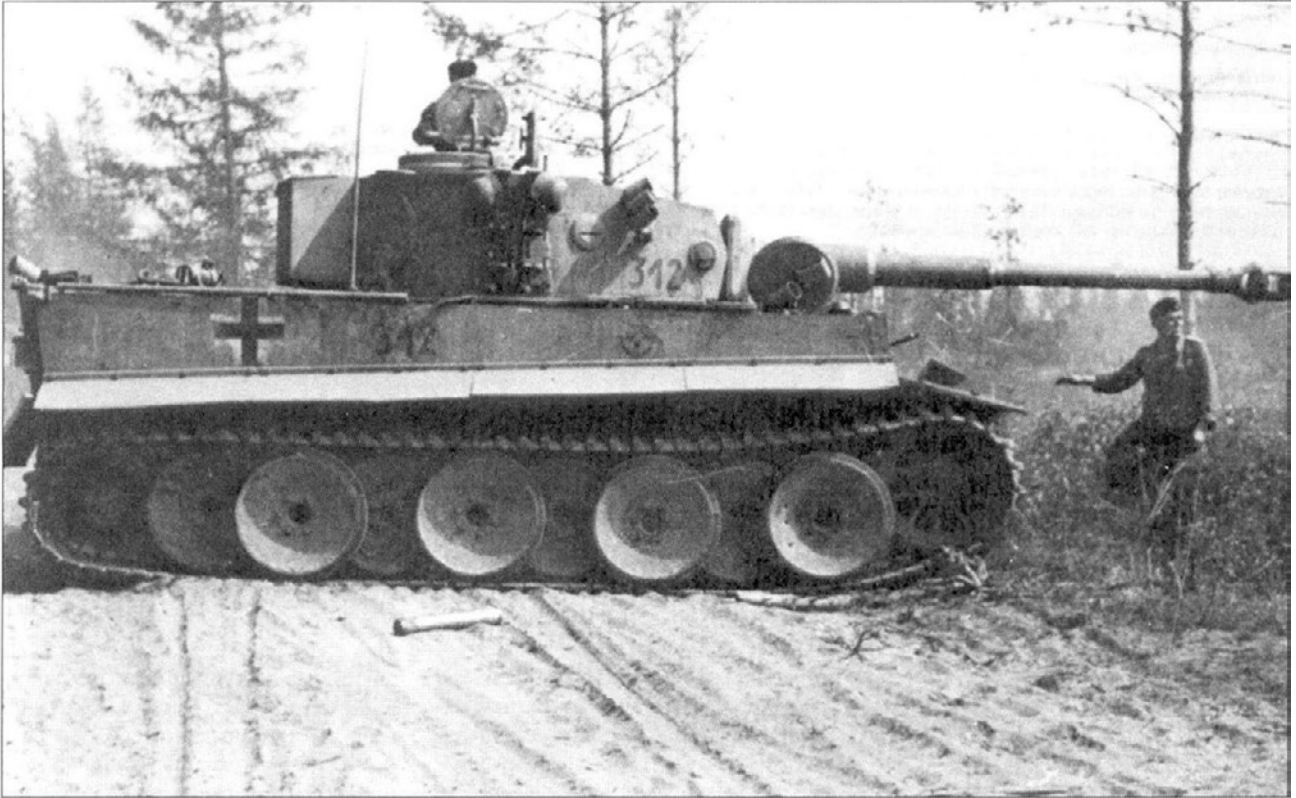
Позднее лето 1943 года. Машина на фотографии имеет вид, типичный для тяжелых танков Тигр I из 502-го тяжелого танкового батальона. Цвет камуфляжной окраски - темно-желтый, на башне черный тактический номер небольшого размера. Воздушные фильтры Feifel уже сняты.
