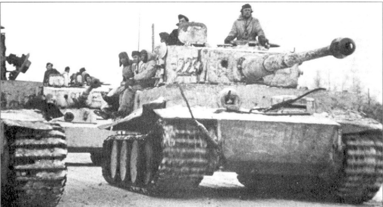
Танк Тигр I на фотографии несет очень грубо выполненную зимнюю камуфляжную окраску. Экипажи часто использовали щетки и тряпки для нанесения временной схемы камуфляжа. Тактический номер на башне - желтого цвета с черной окантовкой. Тактические номера часто рисовались мало контрастными цветами, для того чтобы не портить эффект камуфляжа.
