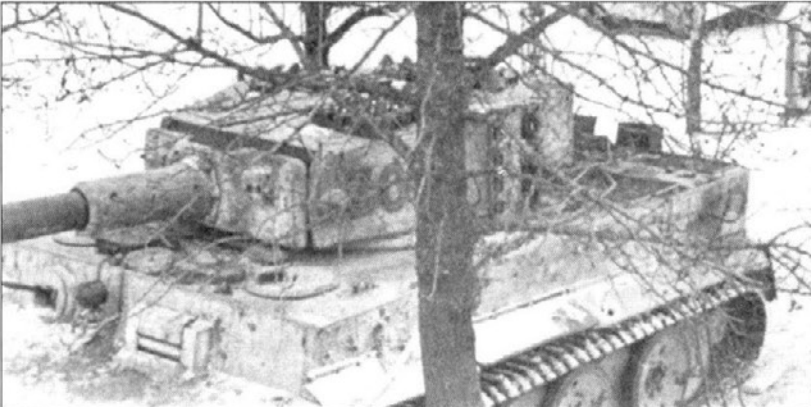
Зима 1943-1944года - тяжелые танки Тигр в белой зимней камуфляжной окраске. Эти танки имеют командирскую башенку позднего образца (унифицированную с башенкой танка Пантера) и единственную фару на переднем броневом листе. Белая краска временного камуфляжа дала довольно грубое покрытие, это было обычным явлением. Тактические номера на башнях - желтые с черной обводкой.
