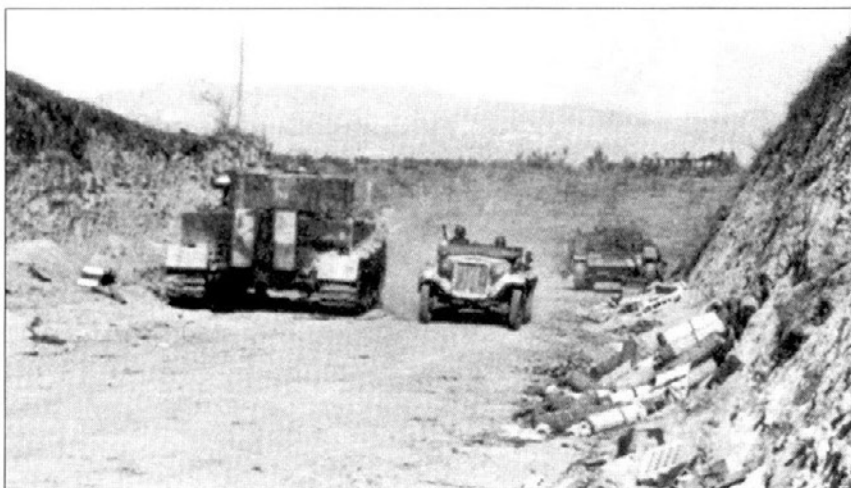
Тигр I из 508-го тяжелого танкового батальона. На кормовом башенном ящике для снаряжения белый номер «112». Цвета камуфляжной окраски - темно-желтый (базовый) с большими пятнами оливково-зеленого. Более светлые области вокруг гусениц - высохшая грязь.
