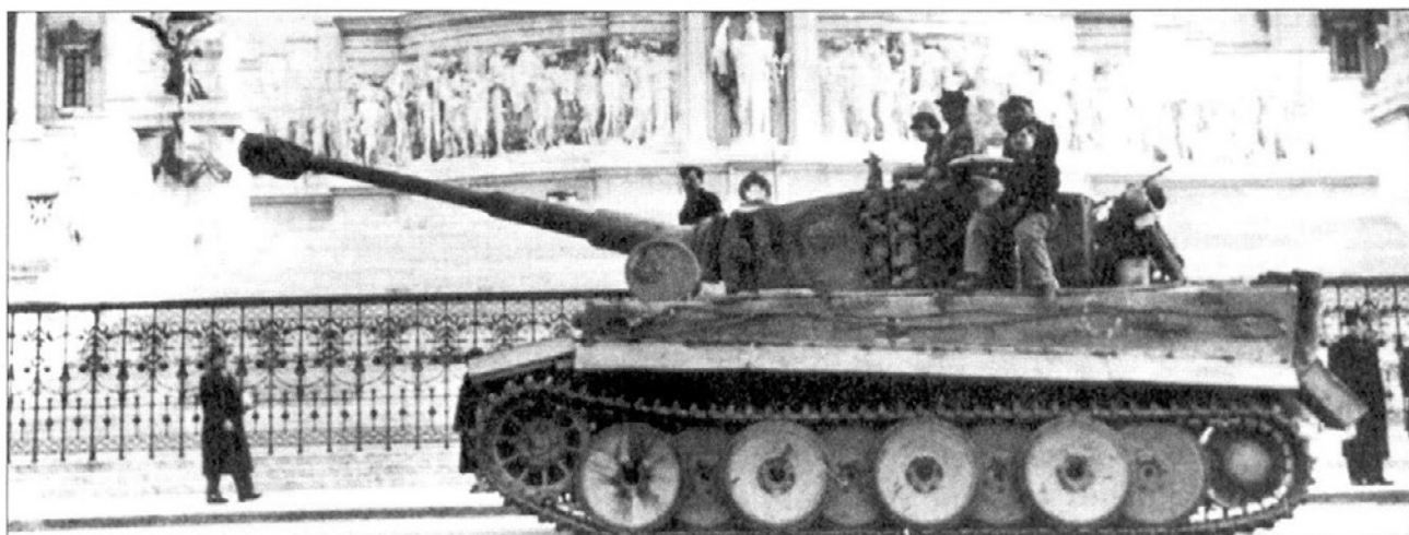
Тигр I из 508-го тяжелого танкового батальона проходит перед памятником Виктору Иммануилу в Риме, следуя на фронт в район Анцио. Это один из танков пополнения, полученного батальоном после начала боев в первые месяцы 1944 года. Машина имеет трехцветную схему камуфляжной окраски - красно-коричневый и оливково-зеленый (нанесенные распылителем краски) поверх базового темно-желтого цвета.
