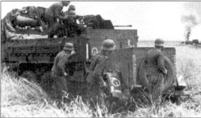
Немецкие войска использовали большое количество легких зенитных установок, смонтированных на грузовиках. На фотографии такое самоходное 20-мм зенитное орудие Flak 38, окрашенное полностью в темно-серый цвет. Эмблема полка «Генерал Геринг» с дубовым листом и желудем - белая. Тактический знак 5-й батареи белого цвета, также как и литера «К», обозначающая принадлежность к группе Клейста во время операции Барбаросса.
