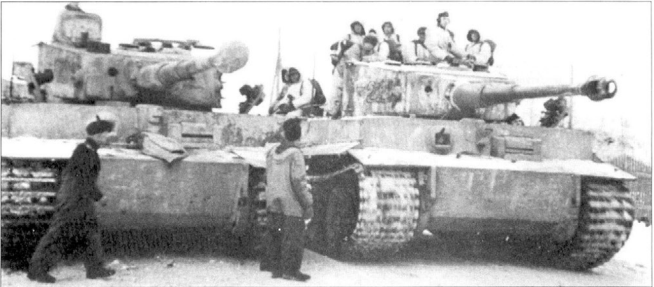
Зима 1943-1944года - тяжелые танки Тигр в белой зимней камуфляжной окраске. Эти танки имеют командирскую башенку позднего образца (унифицированную с башенкой танка Пантера) и единственную фару на переднем броневом листе. Белая краска временного камуфляжа дала довольно грубое покрытие, это было обычным явлением. Тактические номера на башнях - желтые с черной обводкой.
