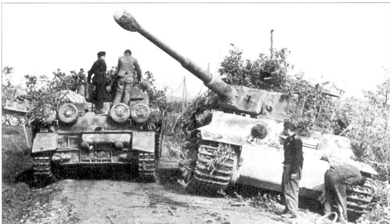
Еще один Тигр 508-го тяжелого танкового батальона сфотографирован к северу от Анцио. Схема камуфляжной окраски - красно-коричневый и немного оливково-зеленого поверх темно-желтого (базового) цвета. И этот танк не имеет тактических номеров на бортах башни. Укрытие из листьев и веток, которое улучшало маскировку, стало в этот период обычной (более того - необходимой) практикой. Обратите внимание на толстый слой пали, который существенно осветлил переднюю часть корпуса.
