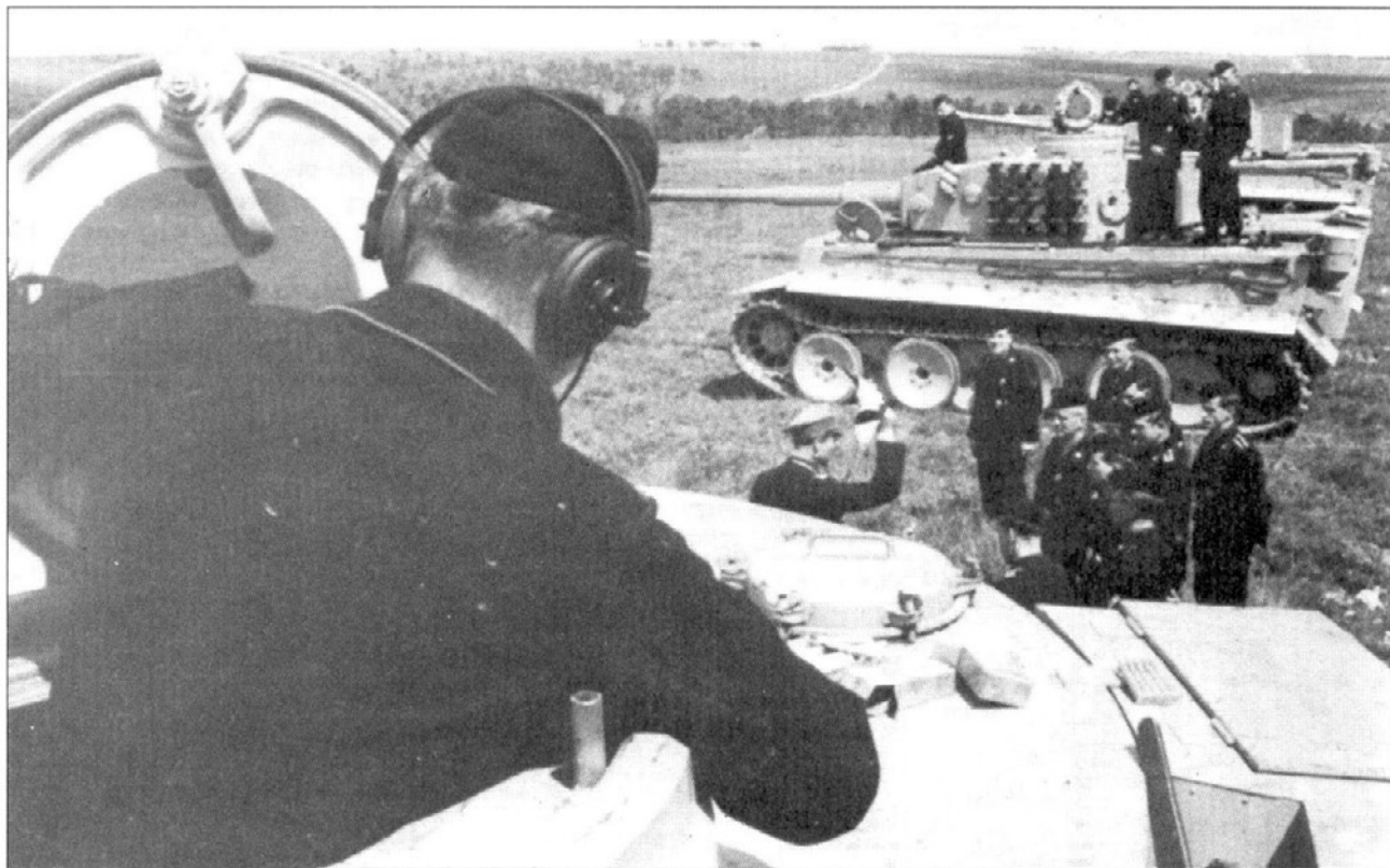
Ранней весной 1943 года 502-й тяжелый танковый батальон получил пополнение - новые танки Тигр I. На этих машинах ранних выпусков еще устанавливались воздушные фильтры Feifel (которые видны на корме). Тигры на фотоснимке окрашены полностью в темно-желтый цвет и еще не имеют эмблем и тактических номеров, так как только что прибыли в подразделение.
