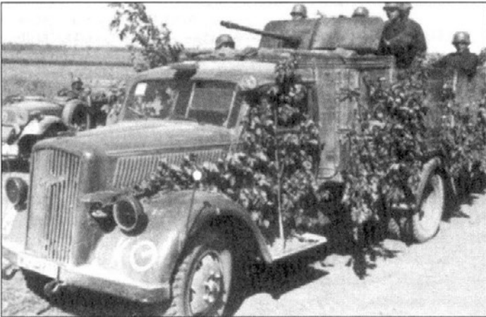
Трехтонный грузовик Opel Blitz с установленной на нем зенитной автоматической пушкой. Машина окрашена полностью в темно-серый цвет. На правом переднем крыле белая эмблема полка «Генерал Геринг», на левом крыле тактический знак 2-й батареи.
