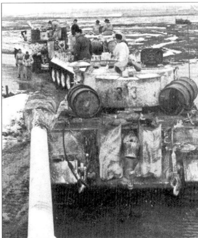
Сфотографированные в конце 1944 года, танки 502-го тяжелого танкового батальона несут грубую белую камуфляжную окраску поверх своей основной - темно-желтой. Тактические номера - красные. Обратите внимание на топливные бочки, укрепленные на каждом танке, они сбрасывались, когда танки шли в бой. Перебои в поставках топлива и недостаток топливозаправщиков вынудили большинство подразделений нагружать на свои танки и другую боевую технику такое количество топлива, насколько это было возможно.
