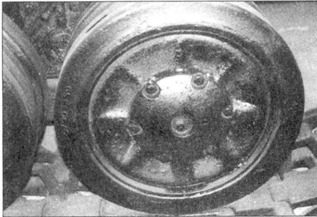
Один из шестнадцати опорных катков самоходки «Насхорн», такие же катки стояли на танках Pz.Kpfw.IV модификаций Ausf.E-Ausf.H. Снимок сделан в Кубинке.
