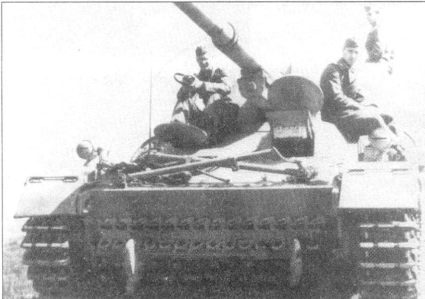
Захваченная в качестве трофея советскими войсками самоходная артиллерийская противотанковая установка «Насхорн» раннего выпуска. Машина принадлежит s.H.Pz.Jg.Abt. 560. Хорошо виден бронированный подвижный щит орудия.
