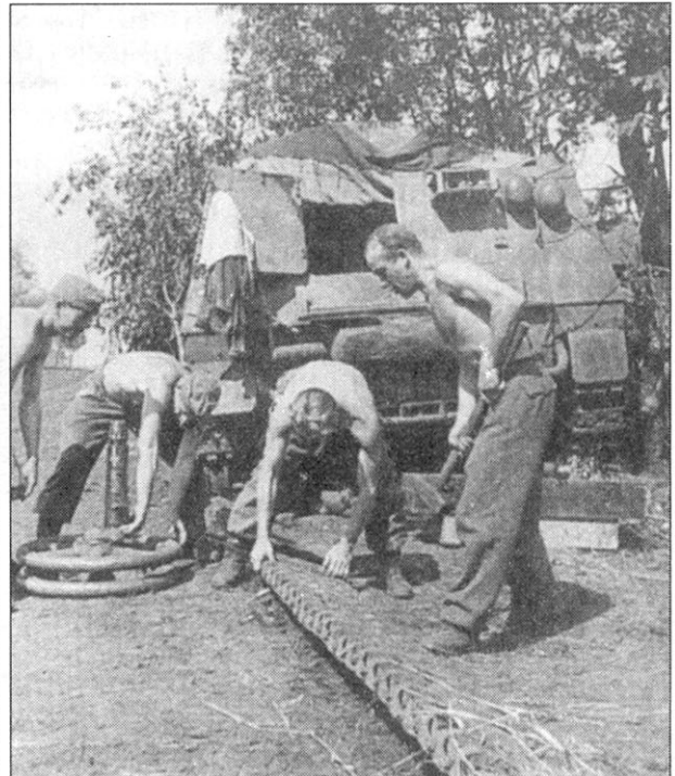
Замена гусеницы на самоходной установке «Насхорн», машина принадлежит к одной из самых первых производственных серий. Это истребитель танков командира подразделения - «Насхорн» оснащен второй радиостанцией FuG-8.
