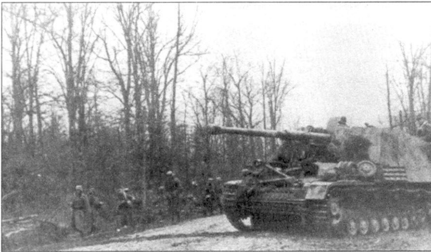
Самоходная артиллерийская противотанковая установка «Насхорн» на марше. Машина оснащена стойкой для крепления ствола орудия по походному аналогичной используемой на САУ «Хуммель». Такими стойками оснащались «Насхорны» первых производственных серий. Ведущее колесо - от танка Pz.Kpfw. III. Обратите внимание на несколько запасных опорных катков, закрепленных на корпусе машине. Скорее всего, «Насхорн» принадлежит s.H.Pz.Jg.Abt. 655.
