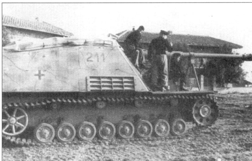
Самоходка «Насхорн» с тактическим номером «211» из 2./s.N.Pz.Jg.Abt. 525, Италия, март 1944 г. Ведущее колесо - такое же, как у танков Pz.Kpfw.III ранних выпусков. На борту боевого отделения навязана паутина веревки, которые служат для крепления маскировки.
