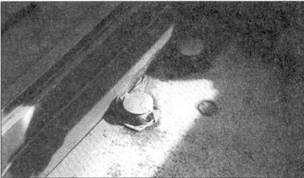
Пол левой части боевого отделения, заливочные горловины топливных баков.
