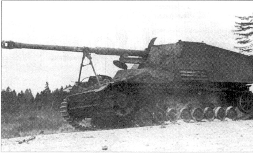
Вид сбоку на подбитую самоходку «Насхорн», стойка для крепления ствола орудия в положении «по походному» характерна для машин ранних производственных выпусков. На стволе видны отметки о победах - три вертикальные полоски и силуэт танка.
