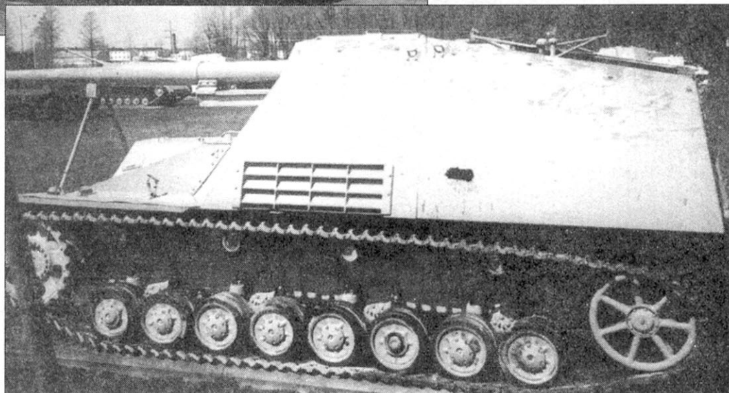
Вид сбоку слева на самоходку из Абердина. Темное пятно на стенке боевого отделения - пробоина от снаряда.
