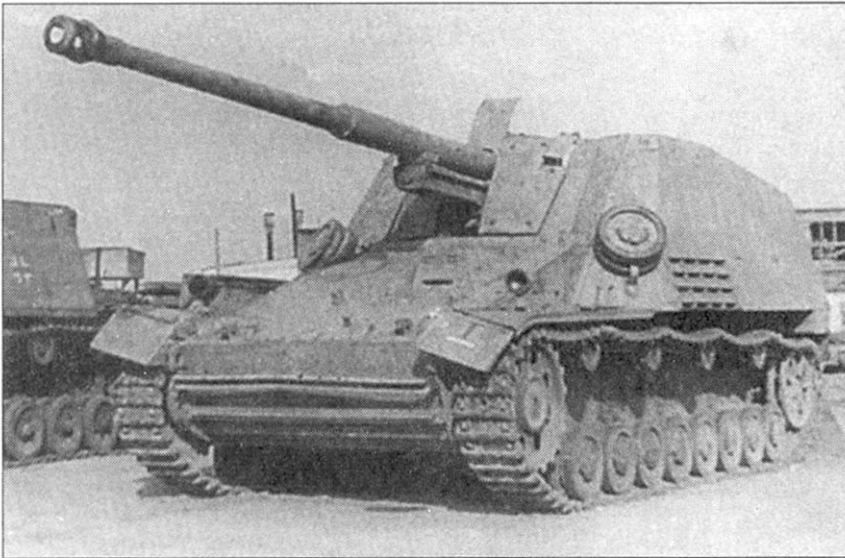
Захваченная в качестве трофея советскими войсками самоходная артиллерийская противотанковая установка «Насхорн» раннего выпуска. Машина принадлежит s.H.Pz.Jg.Abt. 560. Хорошо виден бронированный подвижный щит орудия.
