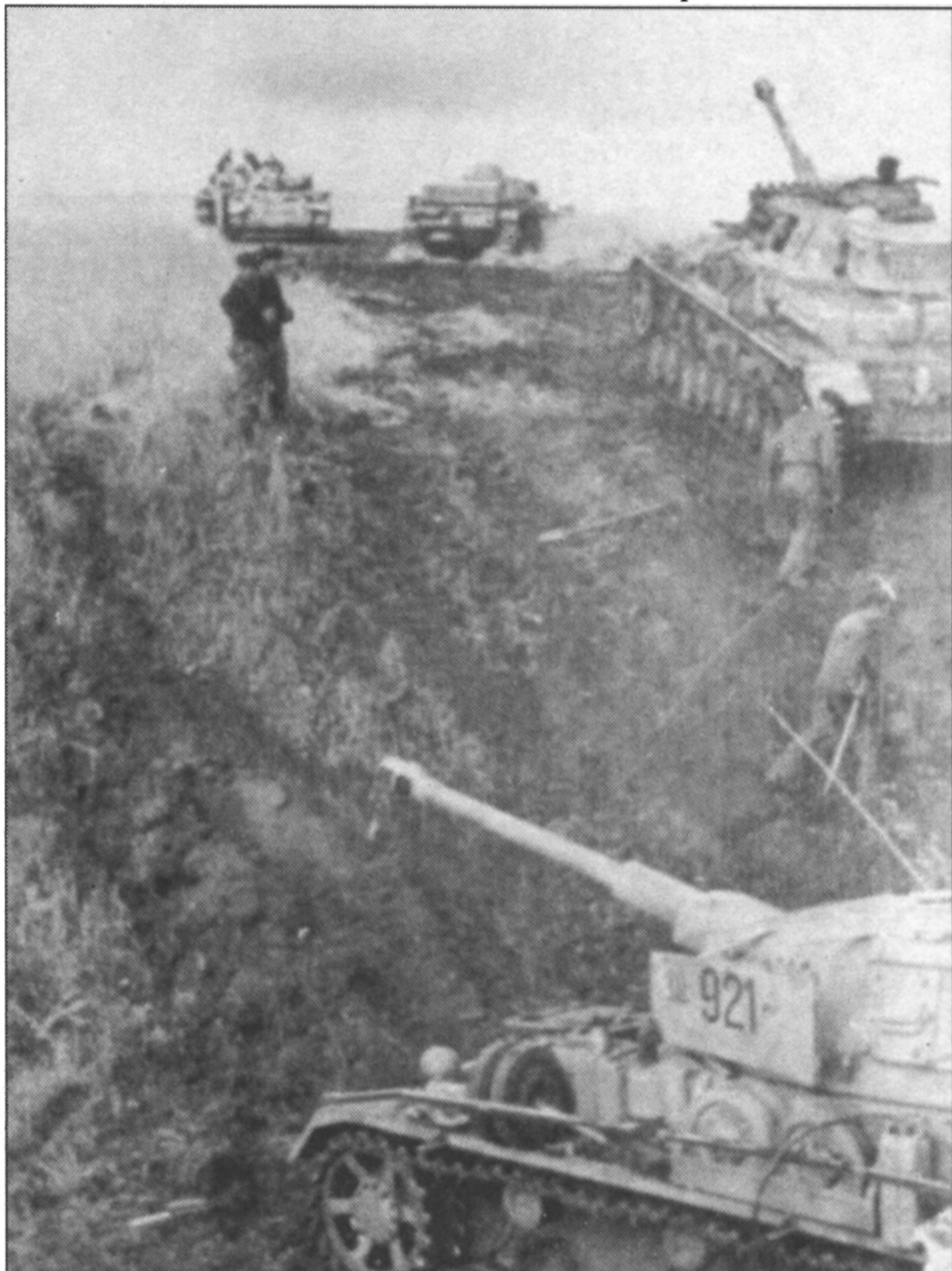
Танки дивизии СС «Мертвая голова» сфотографированы в период Курской битвы. «632»-й танк экранами не оснащен, «921»-й - с башенными и бортовыми экранами. Все танки окрашены в желтый цвет без зеленых и коричневых пятен.
