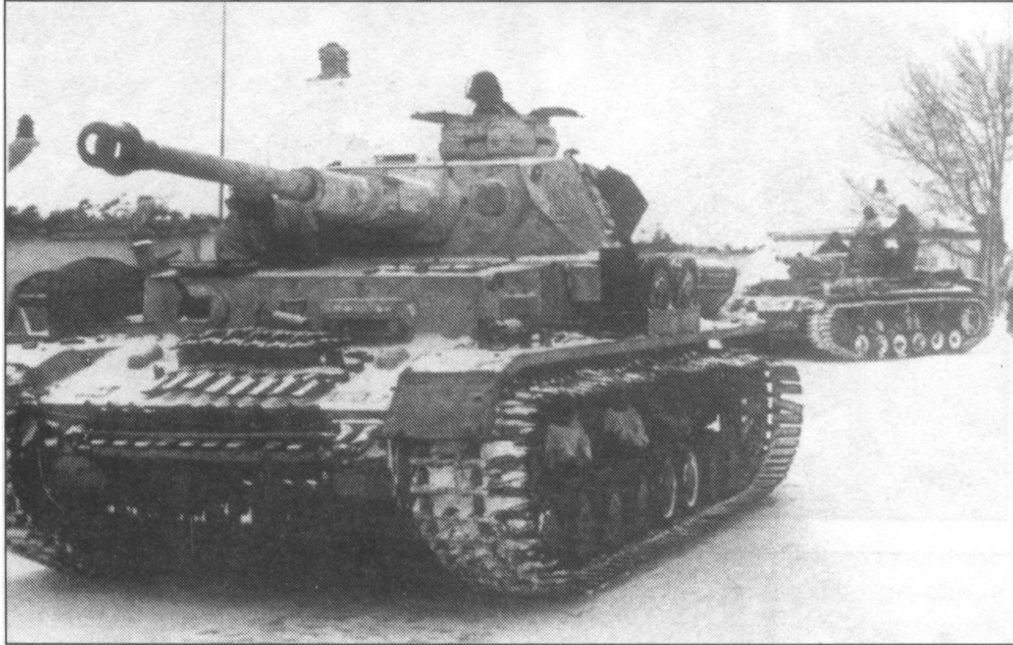
Серия фотографий танков PzKpfw IV Ausf. G из дивизии СС «Лейбштандарт Адольф Гитлер» в период боев за Харьков, февраль 1943 г. Танки оснащены замними расширенными гусеницами Осткеттен и покрыты белой смываемой краской. Обратите внимание, что на нижнем фото бортовой крест продублирован два раза.
