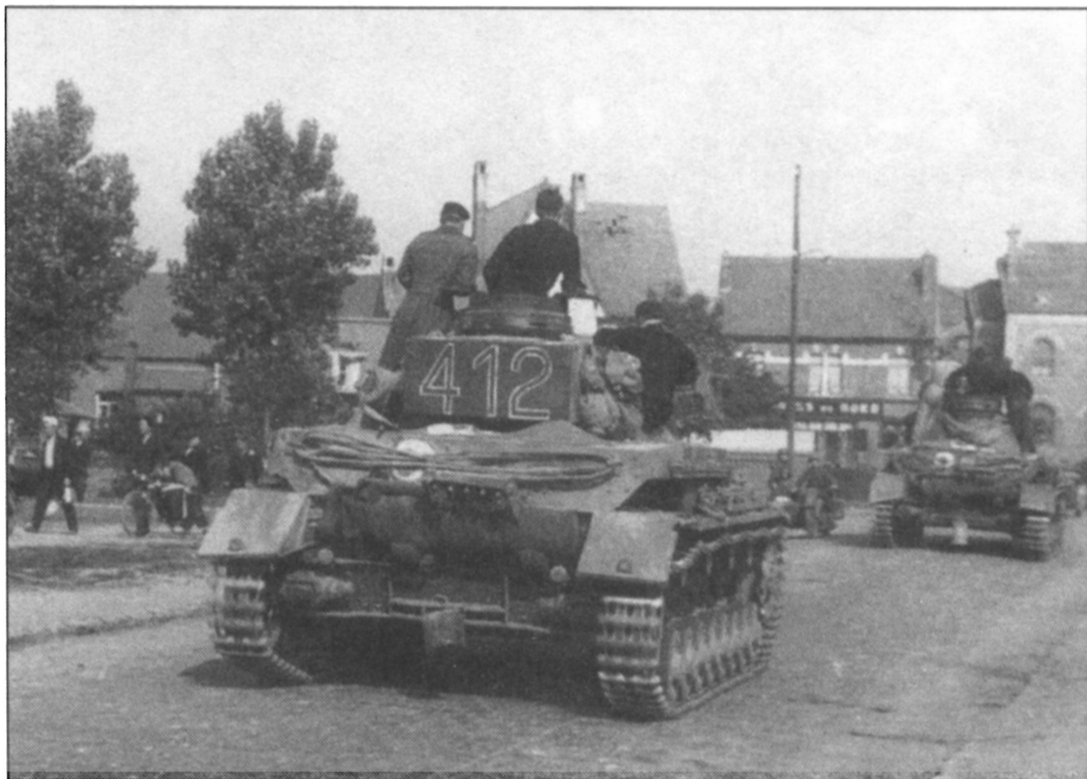
Panzer IV Ausf. D из 7-й танковой дивизии Эрвина Роммеля в одном из французских городов. К корме башни танка приварен импровизированный забашенный ящик, серийные ящики стали устанавливать позже.
