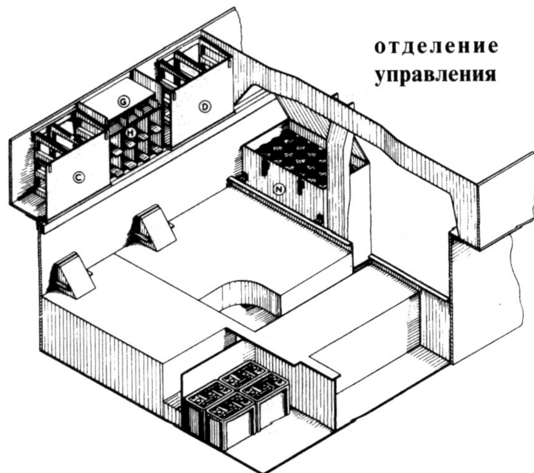
Боевое отделения танка Panzer IV, взгляд с двух ракурсов. Показано расположение боезапаса, топливных баков и аккумуляторов.
