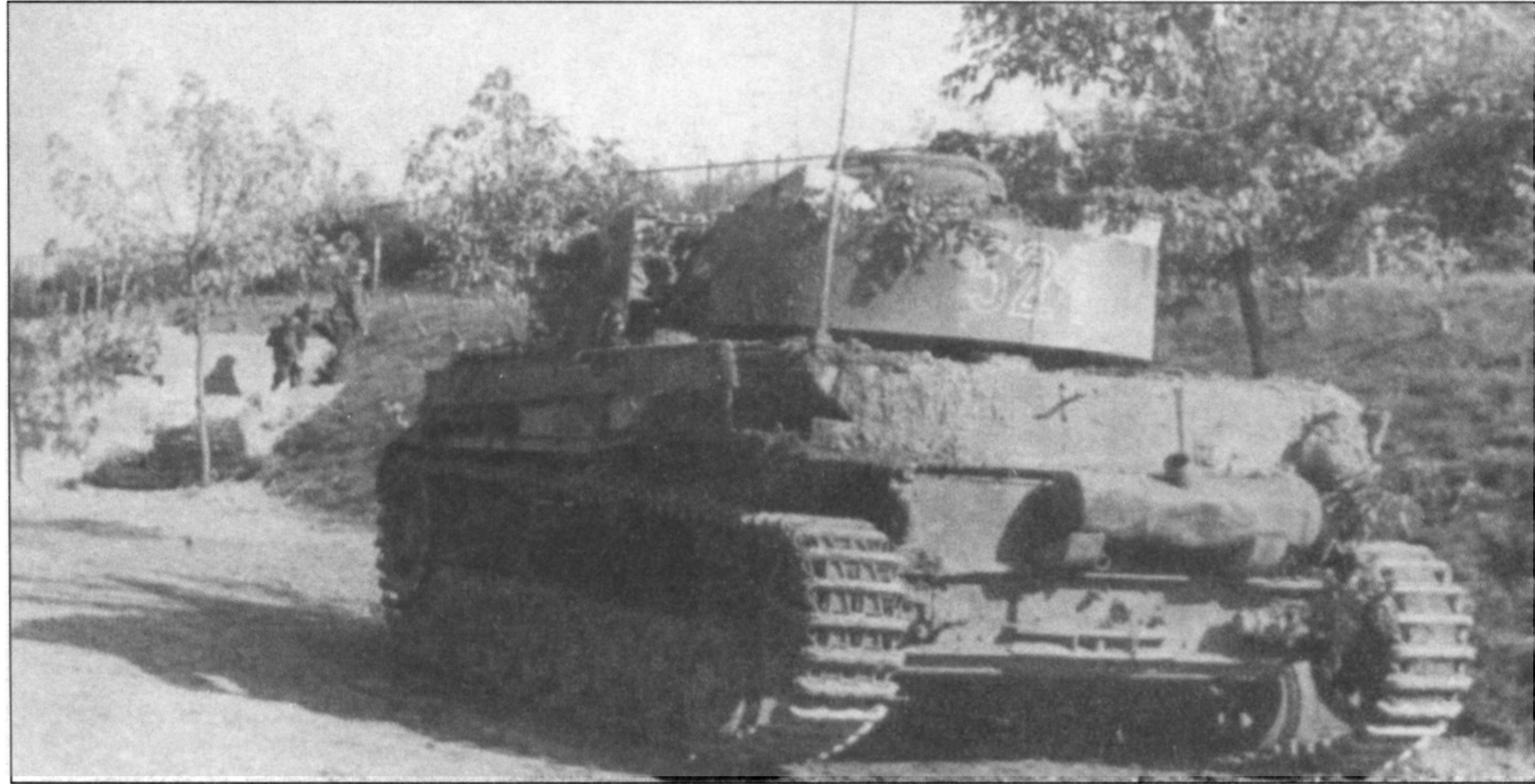
При отсутствии брызговиков корма танка сильно загрязнялась, как это видно на снимке. Танк PzKpfw IV Ausf. H лишился бортовых экранов и вместо них экипаж приспособил деревянную доску, которая вряд ли остановиткумулятивный боеприпас даже при его преждевременном срабатывании.
