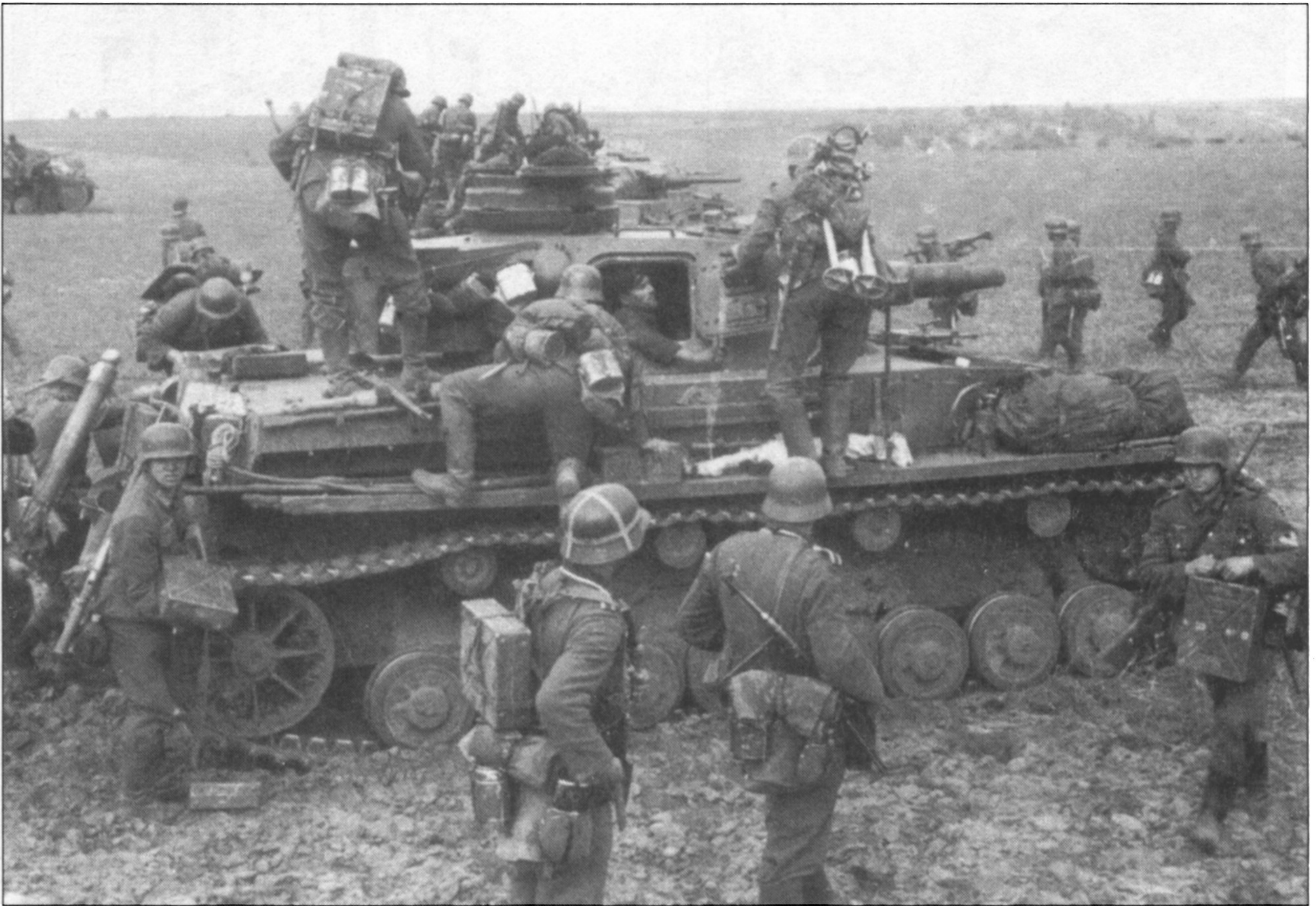
Мотопехота грузится на танки. Из-за постоянной нехватки бронетранспортеров немцы переняли у своих противников - русских тактику танкового десанта, ведь именно пехота должна закреплять достигнутые танками успехи. На переднем плане - PzKpfw IV Ausf. E, обратите внимание - вокруг забашенного ящика экипаж развесил котелки. На танк взбираются солдаты из секции 80-мм миномета: солдат позади несет ствол, боец справа - сошки, остальные - металлические ящики с минами.
