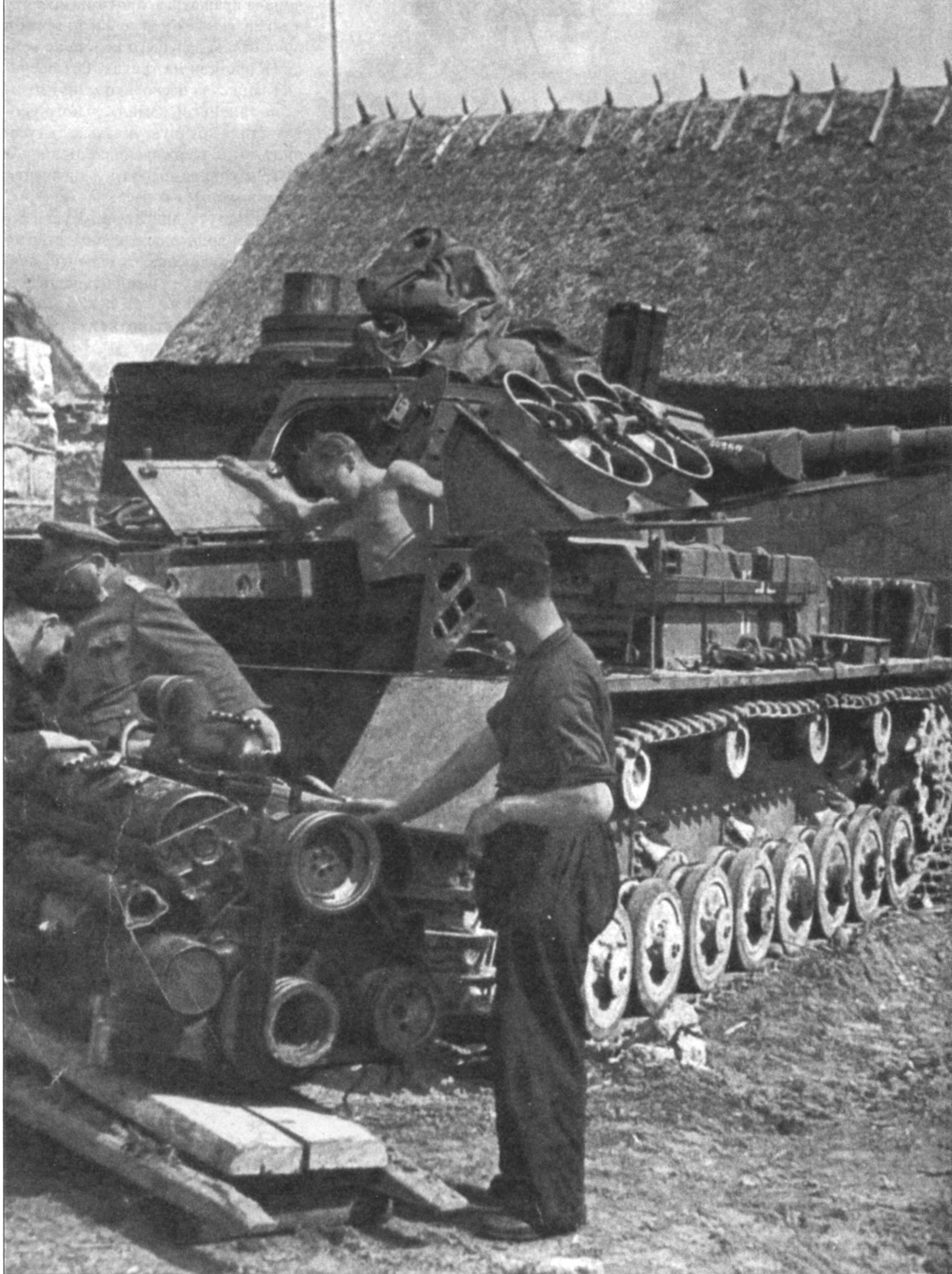
Ремонт PzKpfw IV Ausf. D в полевых условиях, Восточный фронт, лето 1941 г. Хорошо виден двигатель и вентиляторы охлаждения. Интерьер двигательного отделения танка окрашен в серый цвет, тогда как боевое отделение красилось белой краской. В передней части танка видна батарея канистр с бензином. Промышленность Рейха еще не была полностью переориентирована на военные нужды и производство танков велось слабыми темпами, поэтому хорошо поставленная ремонтная служба спасла немецкие panzerwaffe от полного уничтожения.
