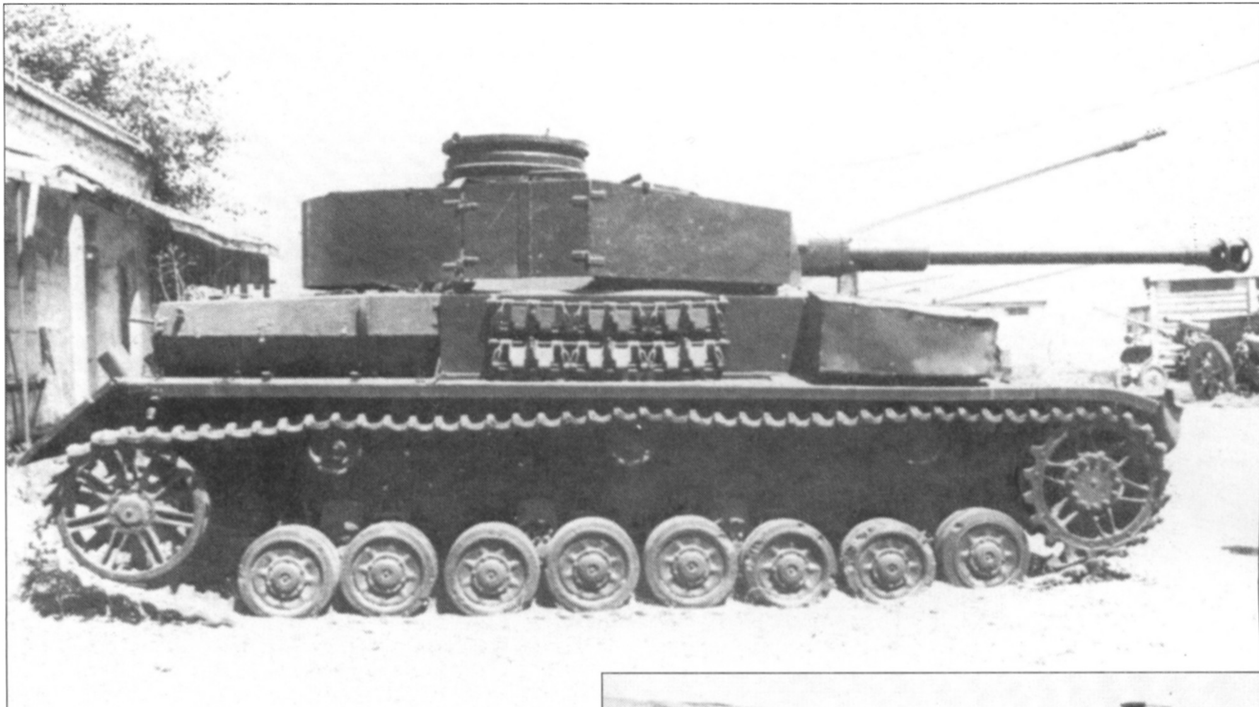
Вверху: два фото захваченного израильянами у сирийцев в июне 1967 года танка PzKpfw IV Ausf. J. Машина по-видимому получена из Испании и имеет некоторые доработки: командирская башенка приспособлена для установки советского пулемета ДШК, на бортах имеются ящики для имущества. Танк окрашен зеленой краской, обозначения на лобовом листе добавили уже израильяне.
