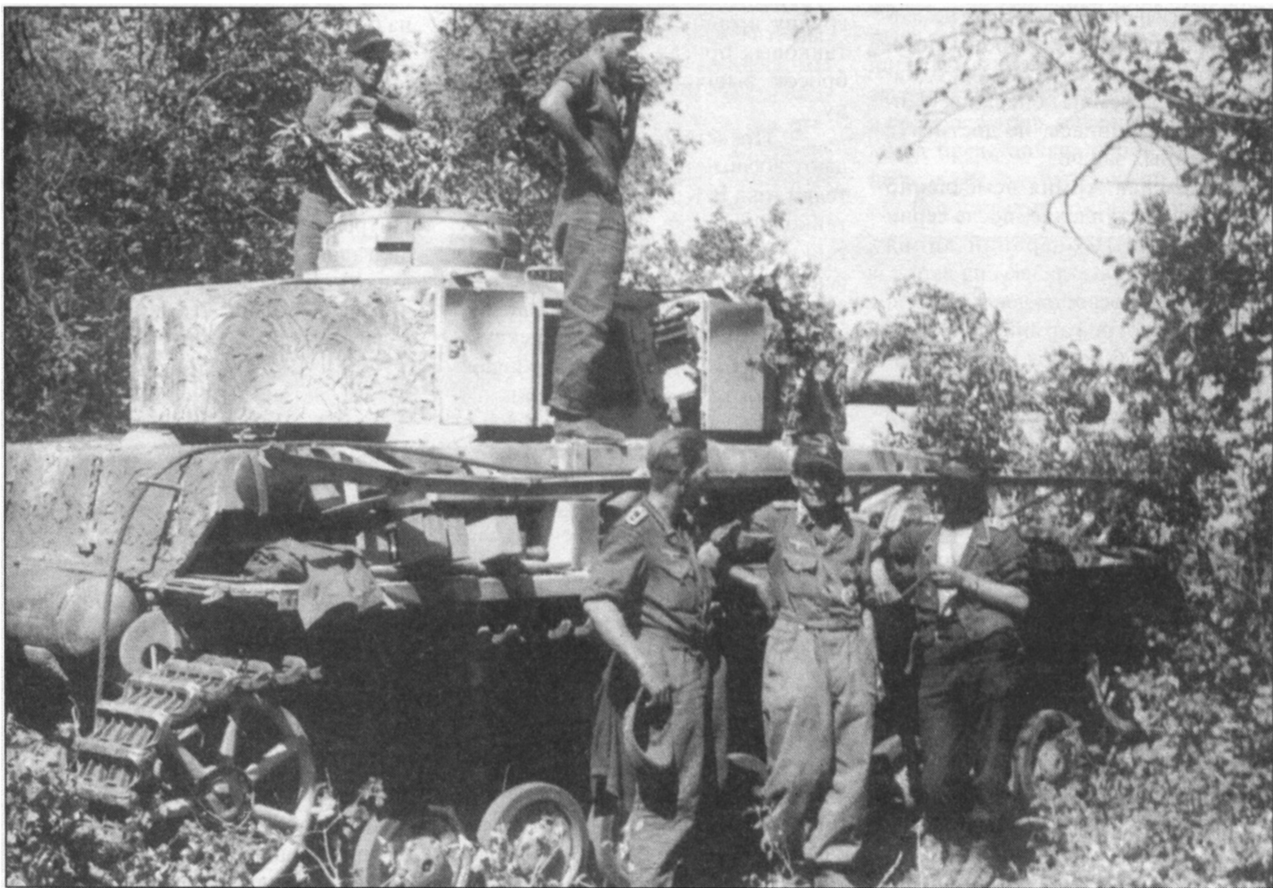
PzKpfw IV Ausf. H в засаде, операция «Цитадель», лето 1943 г. Циммеритное покрытие наносилось в полевых условиях - хорошо заметны неаккуратные разводы.
