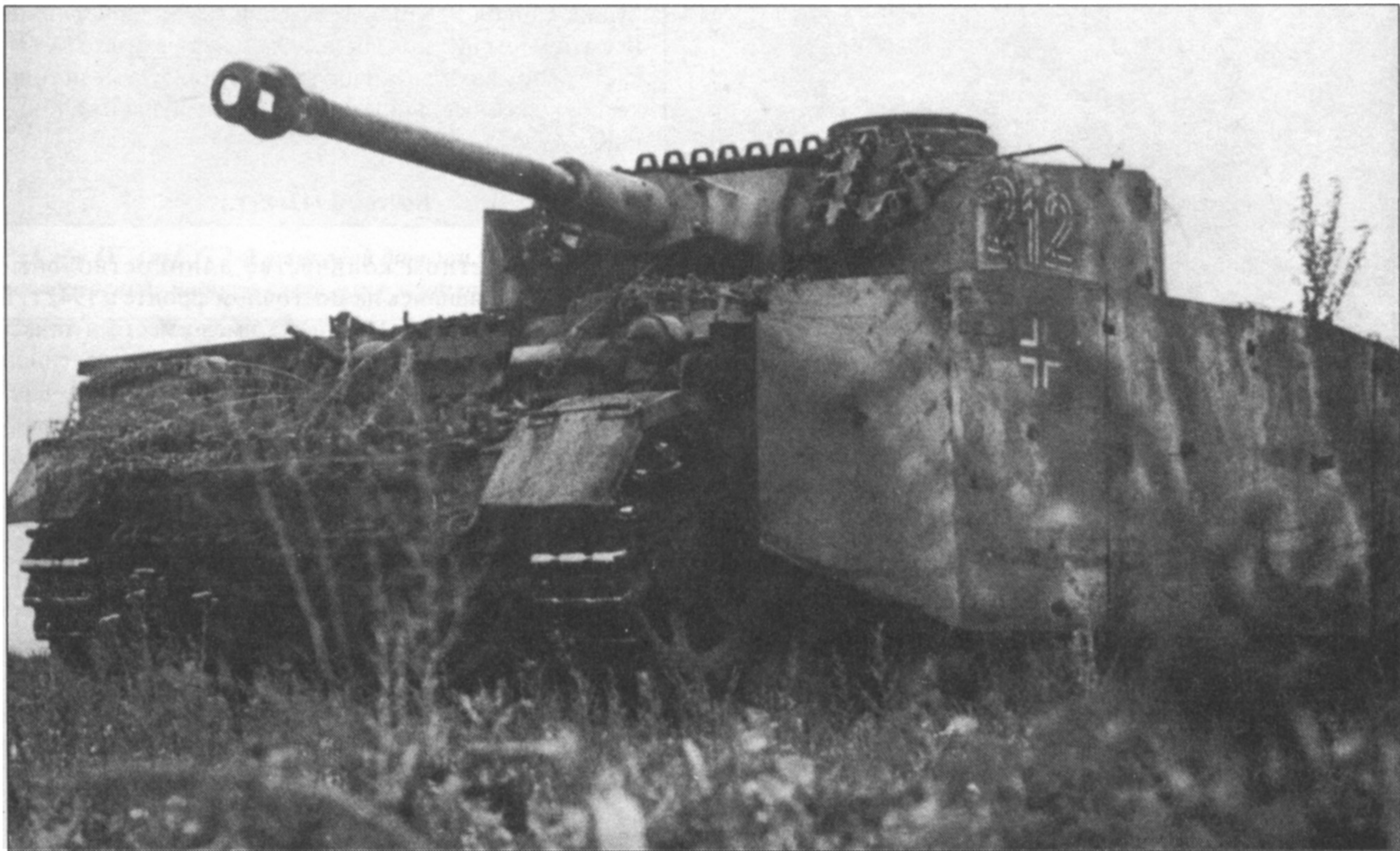
PzKpfw IV Ausf. G с полным комплектом бортовых экранов. Из-за них иногда трудно точно определить модификацию танка. В данном случае это можно сделать по ведущему колесу - явно модификации G. Танк увешан запанями траками для лучшей защиты, машина покрыта пятнами зеленого и коричневого цветов. Номер нанесен по трафарету, на борту возле креста видна таблица для железнодорожников с указанием типа транспортного средства.
