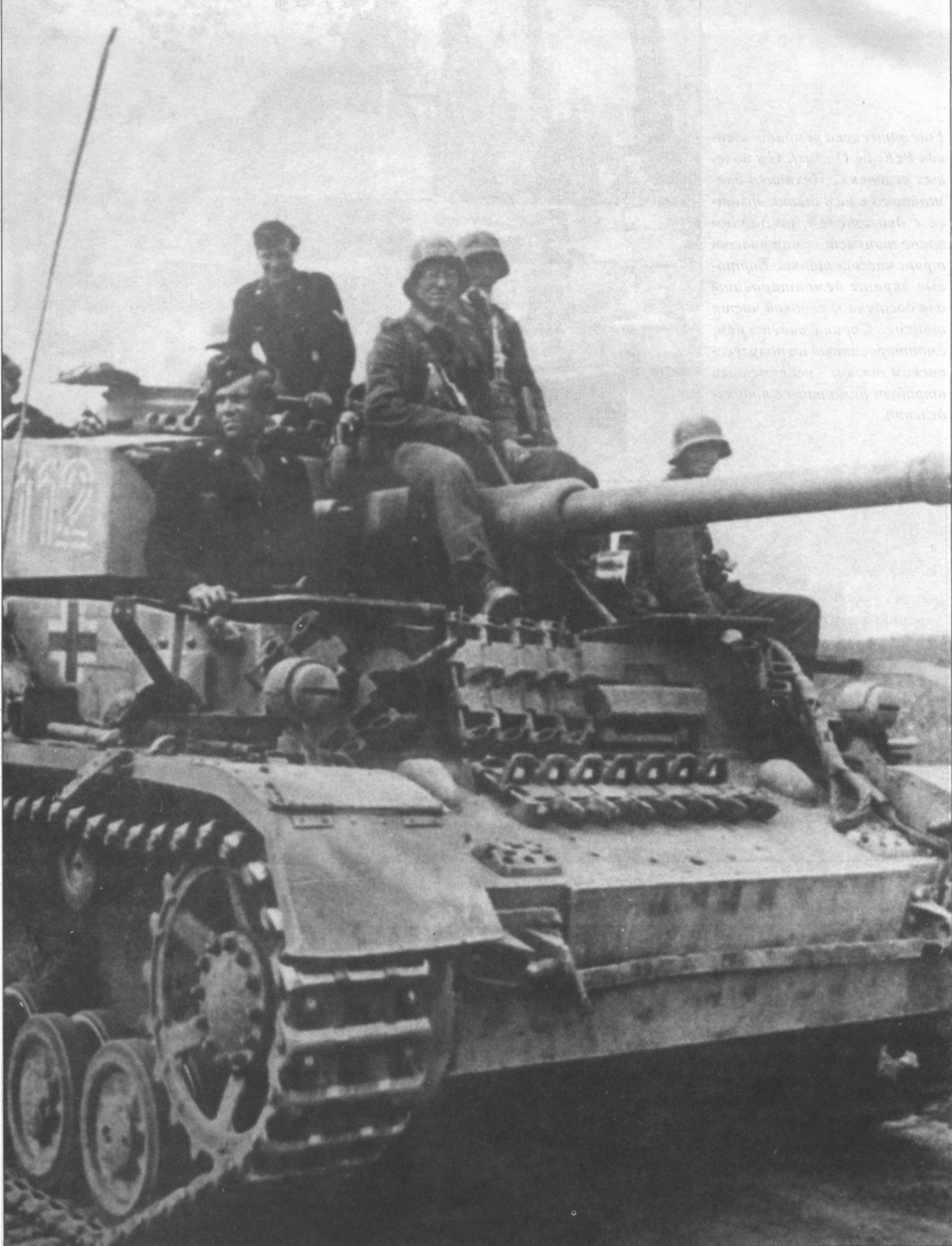
PzKpfw IV Ausf. G номер «112» сфотографирован осенью 1943 г. У танка остались только башенные экраны - бортовые потеряны в ходе боев, только остались их крепления. Хорошо видны приваренные дополнительные ббронеплиты в лобовой части корпуса и надстройки.
