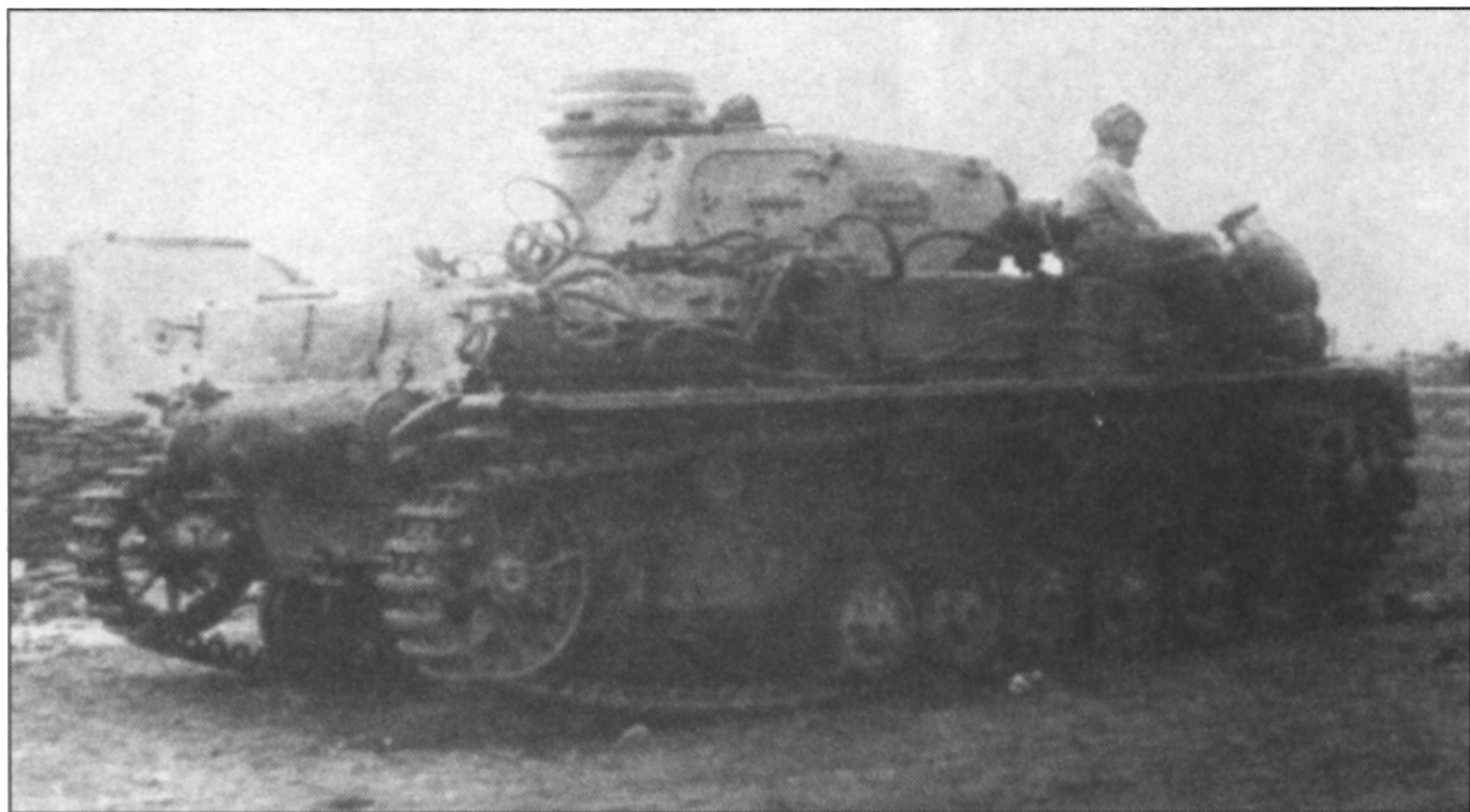
Советский экипаж осваивает трофей - Panzer IV Ausf. D. Обратите внимание на отсутствие задней тележки. Танк увешан тросами - по-видимому его буксировали перед тем как отремонтировать.
