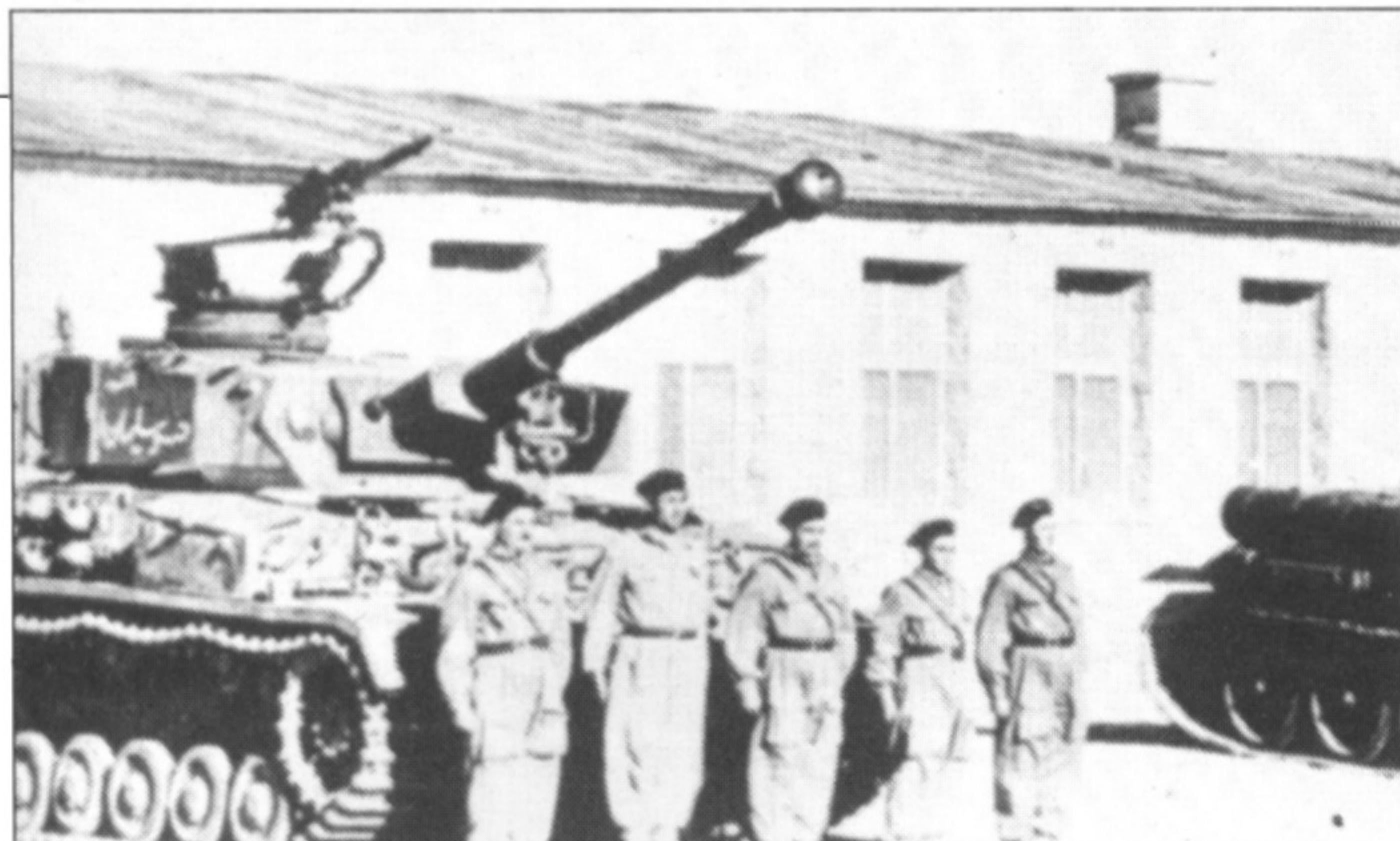
Вверху: два фото захваченного израильянами у сирийцев в июне 1967 года танка PzKpfw IV Ausf. J. Машина по-видимому получена из Испании и имеет некоторые доработки: командирская башенка приспособлена для установки советского пулемета ДШК, на бортах имеются ящики для имущества. Танк окрашен зеленой краской, обозначения на лобовом листе добавили уже израильяне.
