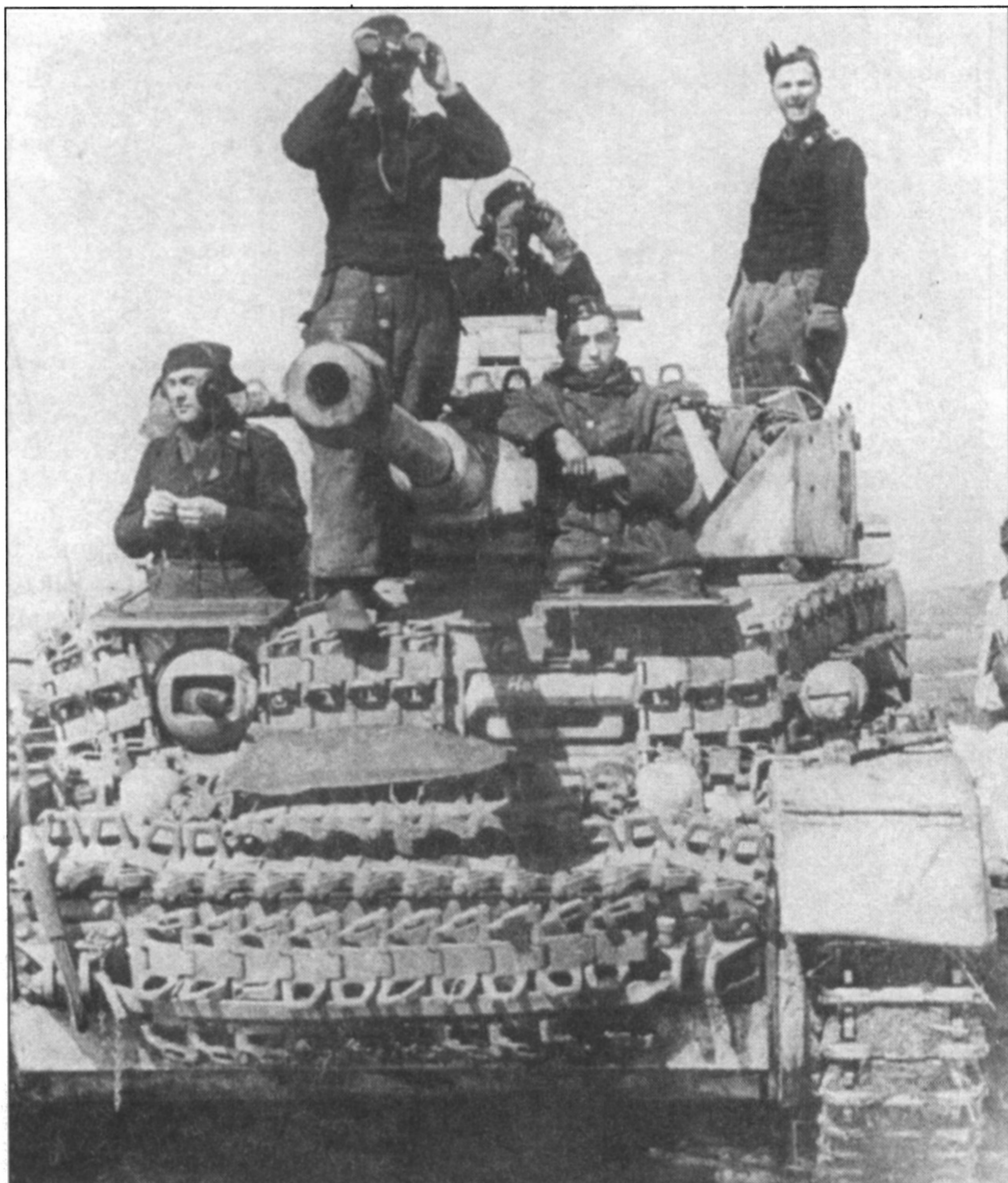
Весь экипаж PzKpfw IV Ausf. G позирует фотографу. Танк максимально увеличан гусеничными траками, на смотровом приборе механика-водителя имеется надпись «Heidi».
