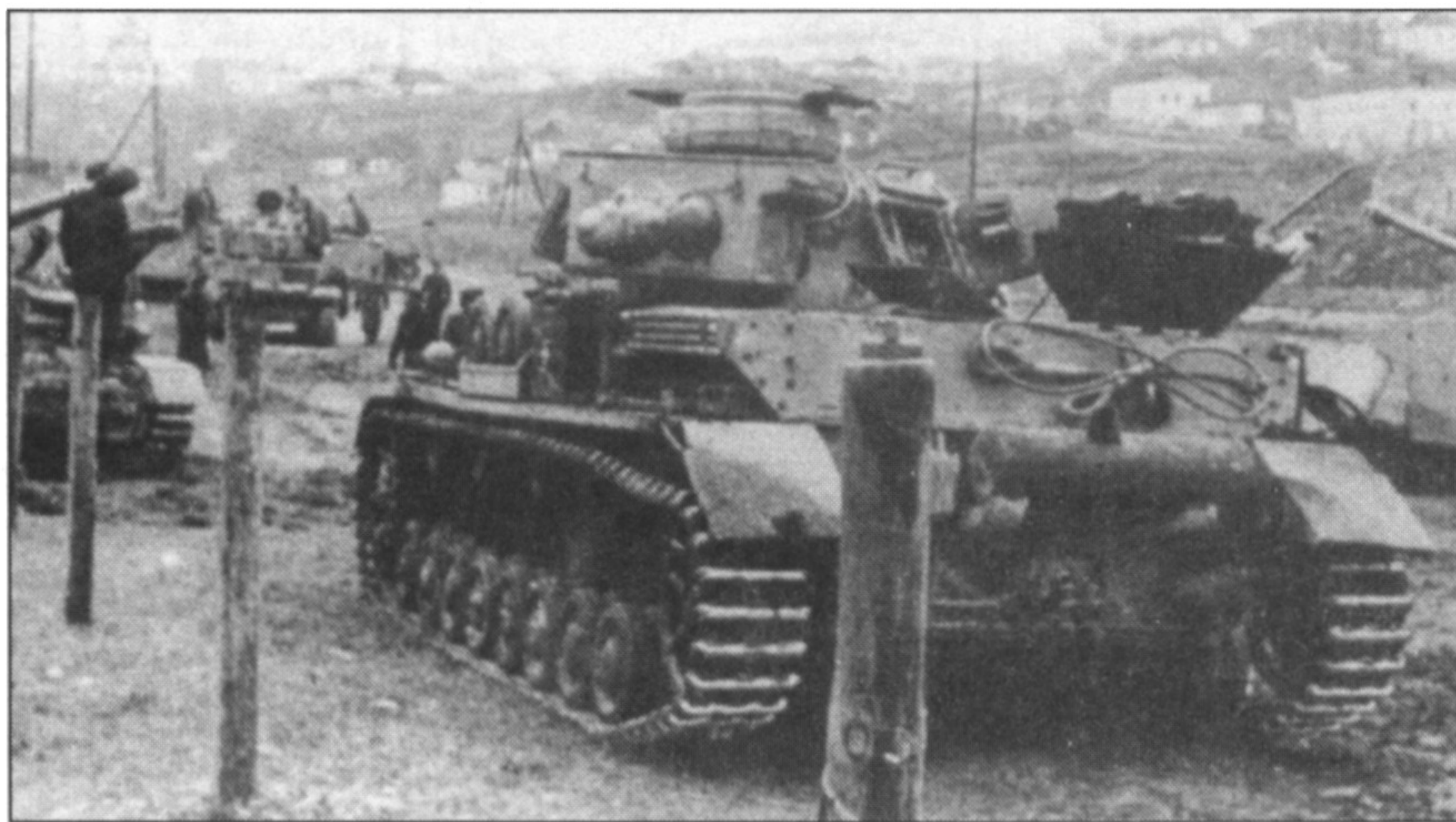
Танки PzKpfw IV Ausf. G на окраине одного из украинских городов, сентябрь 1943 г. Ближайший к нам танк не оснащен бортовыми экранами, крышки его моторного отделения откинуты для ремонта, к замкам забашенного ящика прикручена проволока, к которой привязаны каски экипажа.
