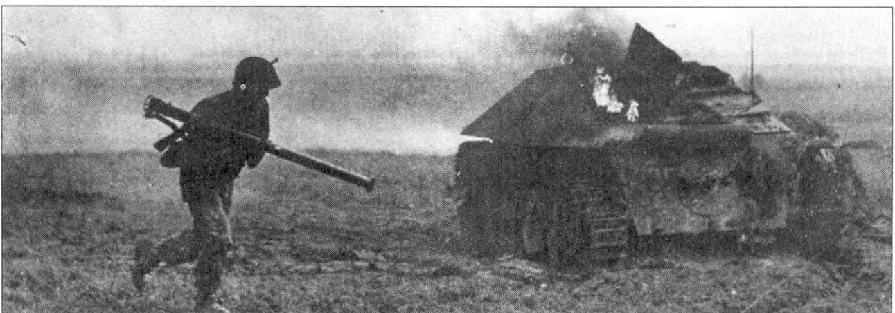
Американец с «базукой» пробегает мимо горящего «Хетцера». Бесплезный против «Тигров» и «Пантер», этот гранатомет представлял собой большую опасность для легкобронированных «Хетцеров».
