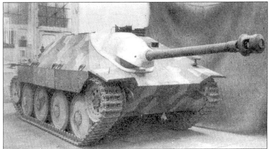
Испытательный образец (шасси номер 323815) истребителя танков для армии Швейцарии. Неокрашенная пушка с дульным тормозом установлена в машину, имеющую стандартную камуфляжную раскраску вермахта.
