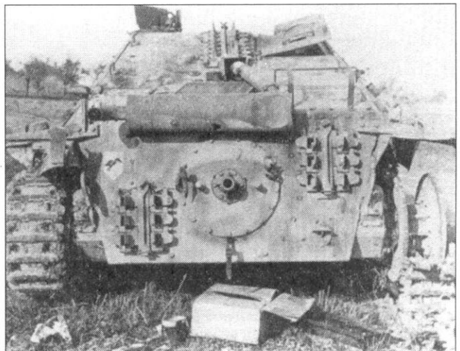
Подбитый истребитель танков «Хетцер» раннего выпуска, Западная Европа. Левый борт машины выглядит нетронутым, справа - сорвана гусеница. На броне заметна проволока для крепления листового камуфляжа.
