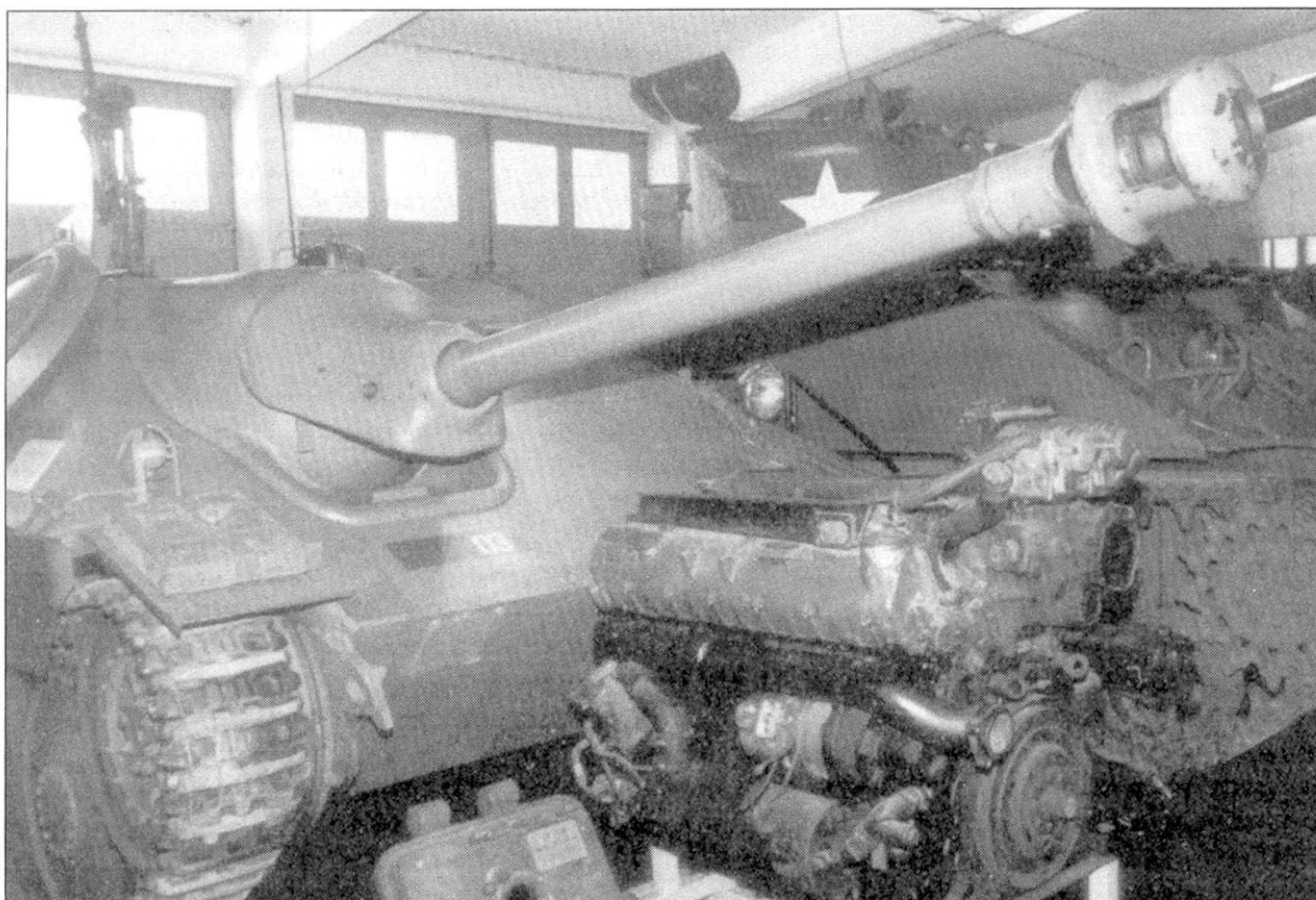
Швейцарские «Хетцеры» легко идентифицировать по орудью с дульным тормозом. Перед машиной выставлен дизель Заурер «Арбон» CH2DRM. Снимок сделан в шведском танковом музее Аксуалл.
