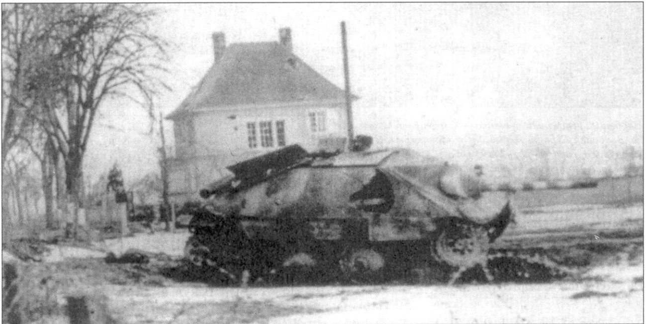
Еще один подбитый на Западном фронте истребитель танков «Хетцер». Большой пролом в борту машины свидетельствует о прямом попадании снаряда. Бортовая броня толщиной 20 мм защищала экипаж лишь от огня легкого стрелкового оружия.
