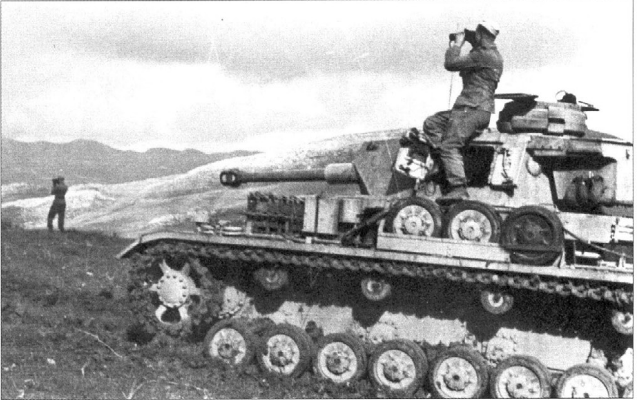
Командир PzKpfw IV Ausf. G всматривается в даль на холмах Туниса. Хорошая оптика и мощная пушка позволили немцам расстреливать танки союзников еще до того как они попадут в зону действенного огня своих пушек. Танк окрашен желтой краской. Ствол имеет другой оттенок - по-видимому он не окрашивался или краска слетела в результате нагрева. Обратите внимание, что внутренняя поверхность створок башенного люка покрашена в белый цвет, что довольно редко встречается на фотографиях.
