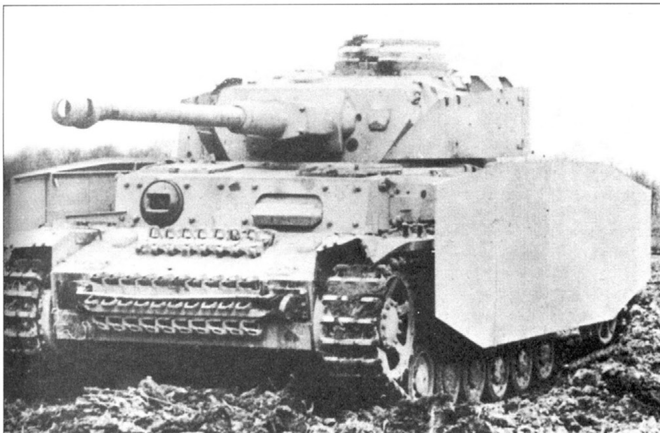
РзКрфв IV Ausf. G с прикрученной болтами 30 мм накладной броней в лобовой части корпуса и полным комплектом противоккумулятивных экранов.
