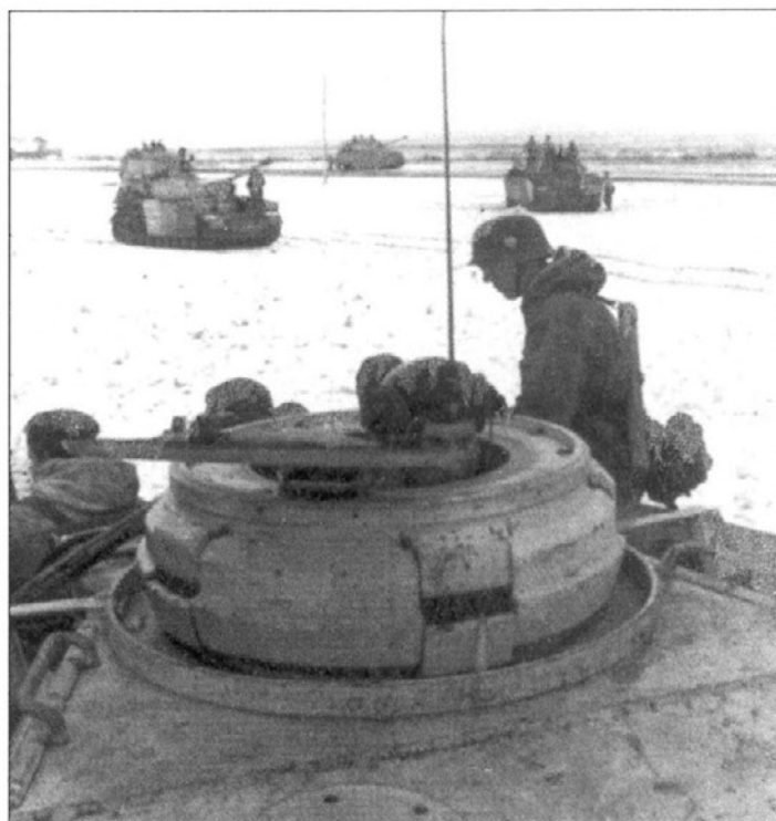
Командирская башенка имела пять смотровым прибором с вертикально сдвигающимися бронезаслонками. По крыше башенки шла отбортовка, которая служила для отражения осколков снарядов. На переднем плане заметна часть бронеколпака вентилятора.
