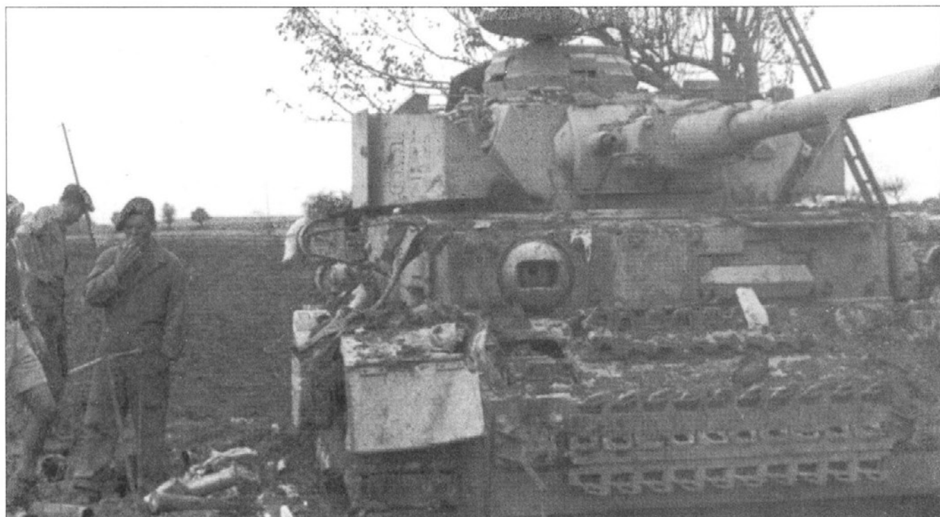
Солдаты союзных войск осматривают разбитый PzKpfw IV Ausf. H (заводской номер шасси 88696), окрестности Термоли, Италия, конец 1943 г. Машина представляет собой пеструю смесь «экстерьеров», характерных для различных моделей «четверки»: накладная броня, как приваренная, так - и на болтах; установлен дефлектор сбоку от ствола орудия, хотя антенна перенесена в кормовую часть машины; смонтированные на башне дымовые гранатометы, одностворчатый люк командирской башенки, ведущие колеса и бронеколпаки опорных катков старого типа, обрезиненные ролики. Tактический номер намечен черным контуром по основной темно-желтой окраске.
