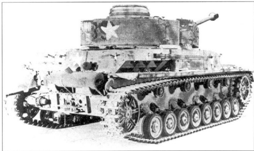
Экспериментальный танк PzKpfw IV с гидростатическим приводом фирмы Цахирдфабрик Аугсбург. Обратите внимание на характерную форму кормовой части корпуса танка и заднее расположение ведущих колес.
