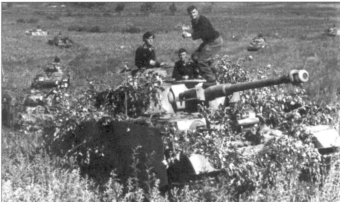
На танках модификации Ausf. G впервые появились противокумулятивные экраны, «schurzen». Экраны крепились к бортам корпуса, кормовой части и бортам башни. Экраны корпуса могли легко сниматься, в то время как башенные экраны накрепко крепились болтами.
