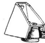
Дополнительное бронирование (50 мм + 30 мм) поздние Ausf. G - ранние H
