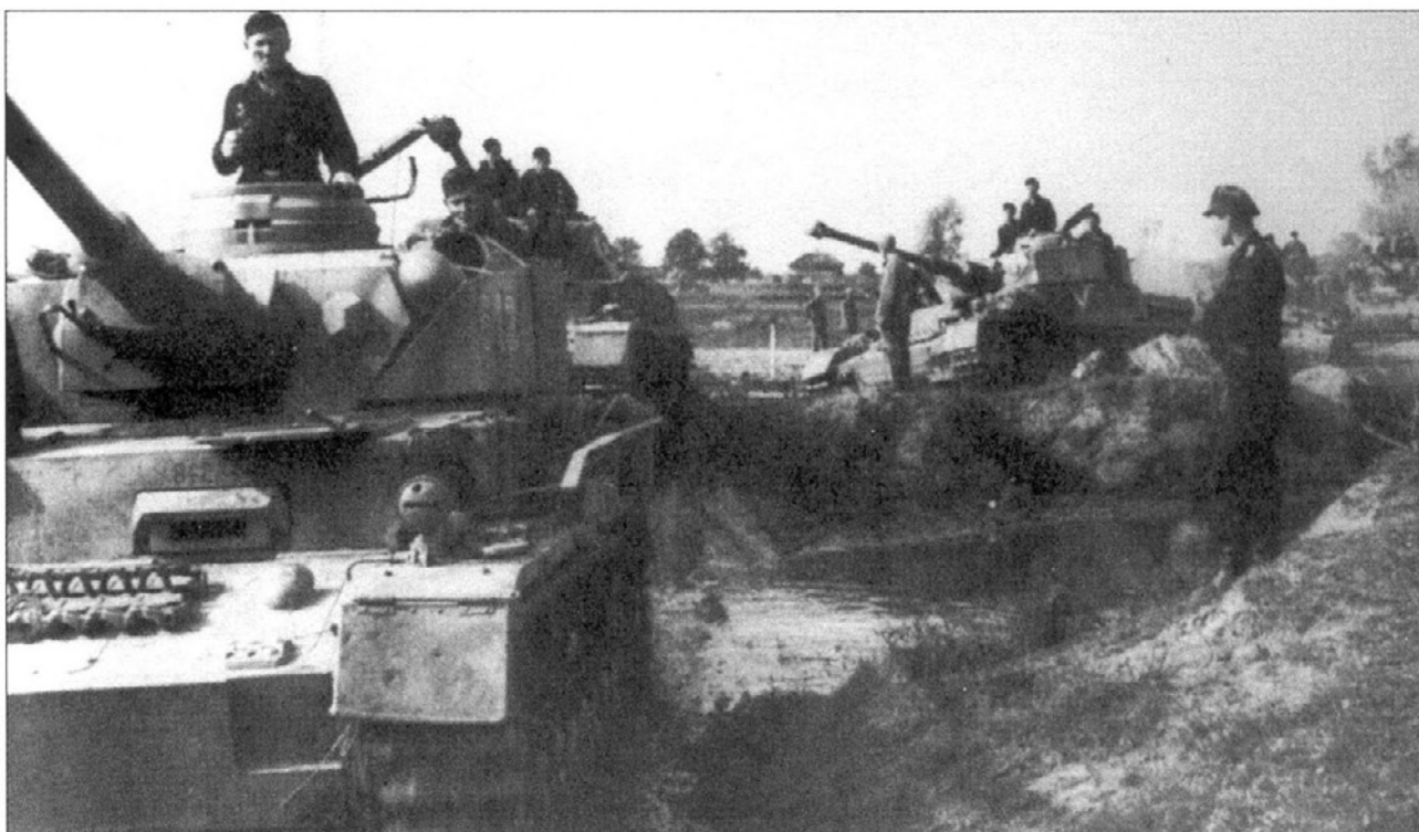
Поздние PzKpfw IV Ausf. G из 5-й танковой дивизии, весна 1944 г. Танк на переднем плане «потерял» левую буксирную петлю, что позволяет оценить толщину накладного бронелиста. Брызговик посечен пулями, над смотровым прибором механика-водителя выдён номер шасси - 84274. Обратите внимание на небольшой дефлектор для антенны на правой стороне маски пушки. Такая конструкция применялась не на всех танках. Между вторым и третьим танком заметна фигура советского военнопленного в телогрейке. Возможно он участвовал в подготовке склонов речушки для прохода танков.
