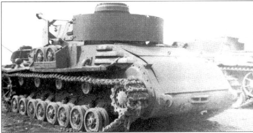
Экспериментальный танк PzKpfw IV с гидростатическим приводом фирмы Цахирдфабрик Аугсбург. Обратите внимание на характерную форму кормовой части корпуса танка и заднее расположение ведущих колес.
