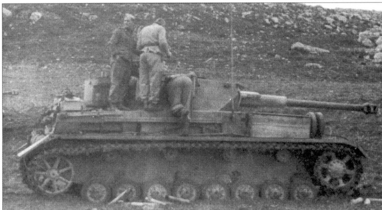
На танках РзКрфв IV Ausf. G устанавливались те же самые 43-калиберные 75-мм пушки, что и на машинах модификации Ausf. F2, однако однокамерный дульный тормоз с целью уменьшения импульса отдачи заменили двухкамерным. На лобовых скулах танков Ausf. G отсутствовали смотровые приборы, благодаря чему несколько возросла прочность башни и, как следствие, устойчивость к попаданию снарядов. Запечатленный на снимке танк оборудован большим деревянным контейнером для имущества, смонтированным в передней правой части корпуса, на крыше моторного отделения виден ящик от снарядов.
