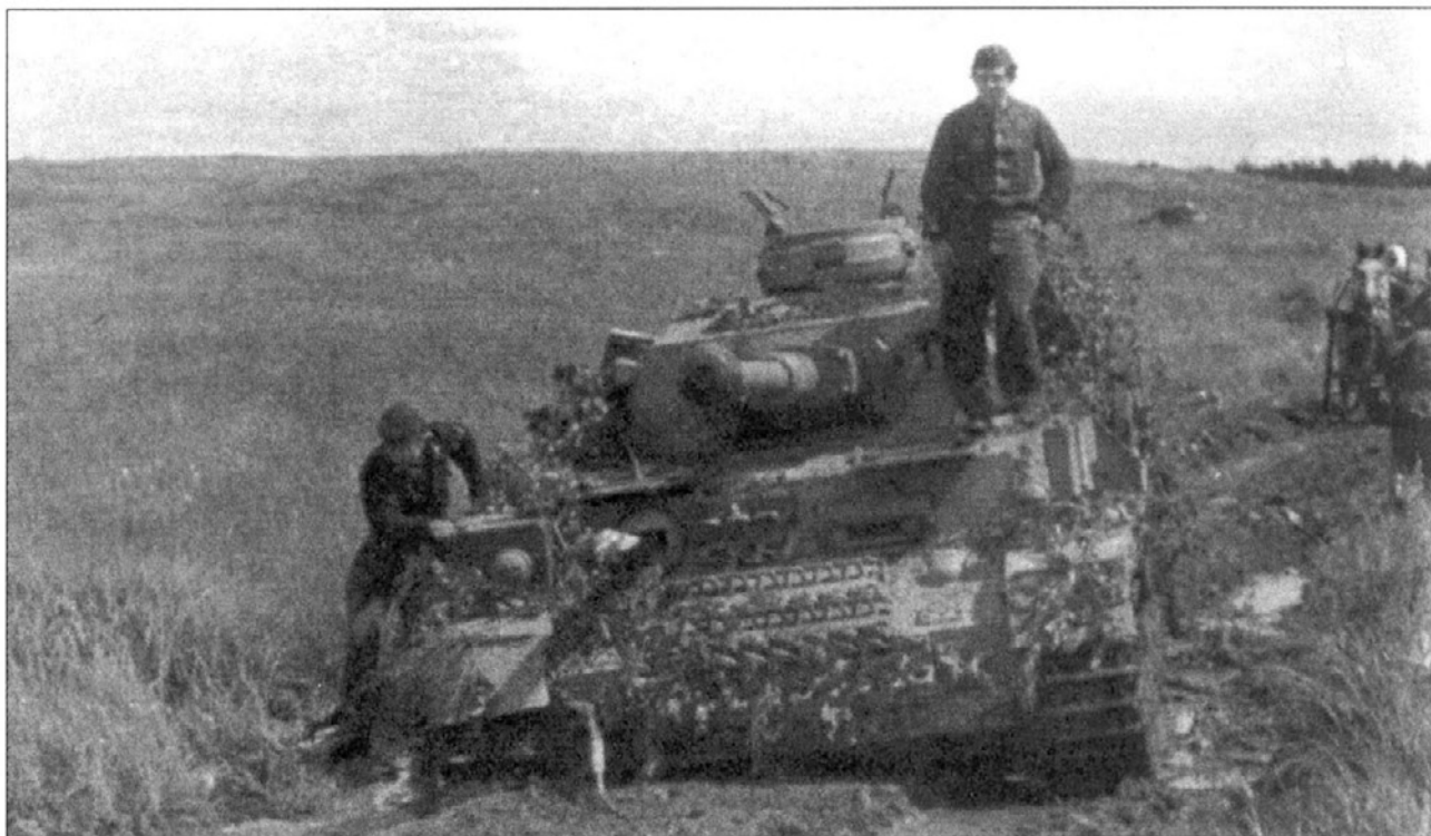
Танк PzKpfw IV Ausf. G, похоже, проиграл схватку со знаменитым русским генералом по имени «грязь», российский проселок, 1943 г. На лобовые части корпуса и надстройки наварена 30-мм накладная броня. Под ветками на правом крыле можно различить ящик для снаряжения. Подобные контейнеры ставились как в заводских условиях непосредственно при изготовлении танка, так и в полевых мастерских. Командирская башенка оборудована двустворчатым люком.
