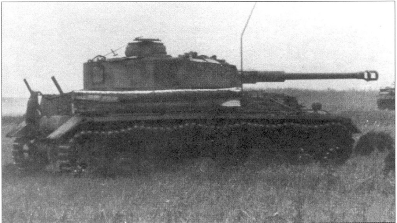
Танки PzKpfw IV Ausf. G в степи на Восточном фронте, 1943 г. В кормовой части корпуса просматривается некая конструкция, которая, вероятнее всего, служит для закрепления ящиков или какого-нибудь другого имущества. Противоккумулятивные экраны с бортов корпуса демонтированы, на башне экраны остались. Бревна по бортам корпуса использовались как дополнительная защита. Штырь радиоантенны изогнут.
