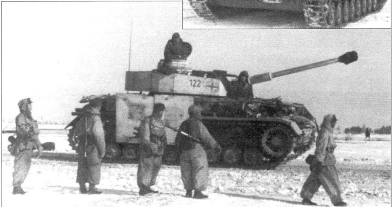
Пехотинцы перекинулись парой слов с командиром танка PzKpfw IV Ausf. H, Восточный фронт. Танкист одет в утепленный комбинезон темного цвета, на пехотинцах - такие же комбинезоны, но белого цвета. Большинство секций бортового противоккумулятивного экрана танка демонтировано. Пространство между надстройкой корпуса и экранами часто использовалось для хранения и перевозки различного имущества танкистов. На опорных катках машины установлены бронеколпаки нового типа, однако ролики имеют обрешетку.
