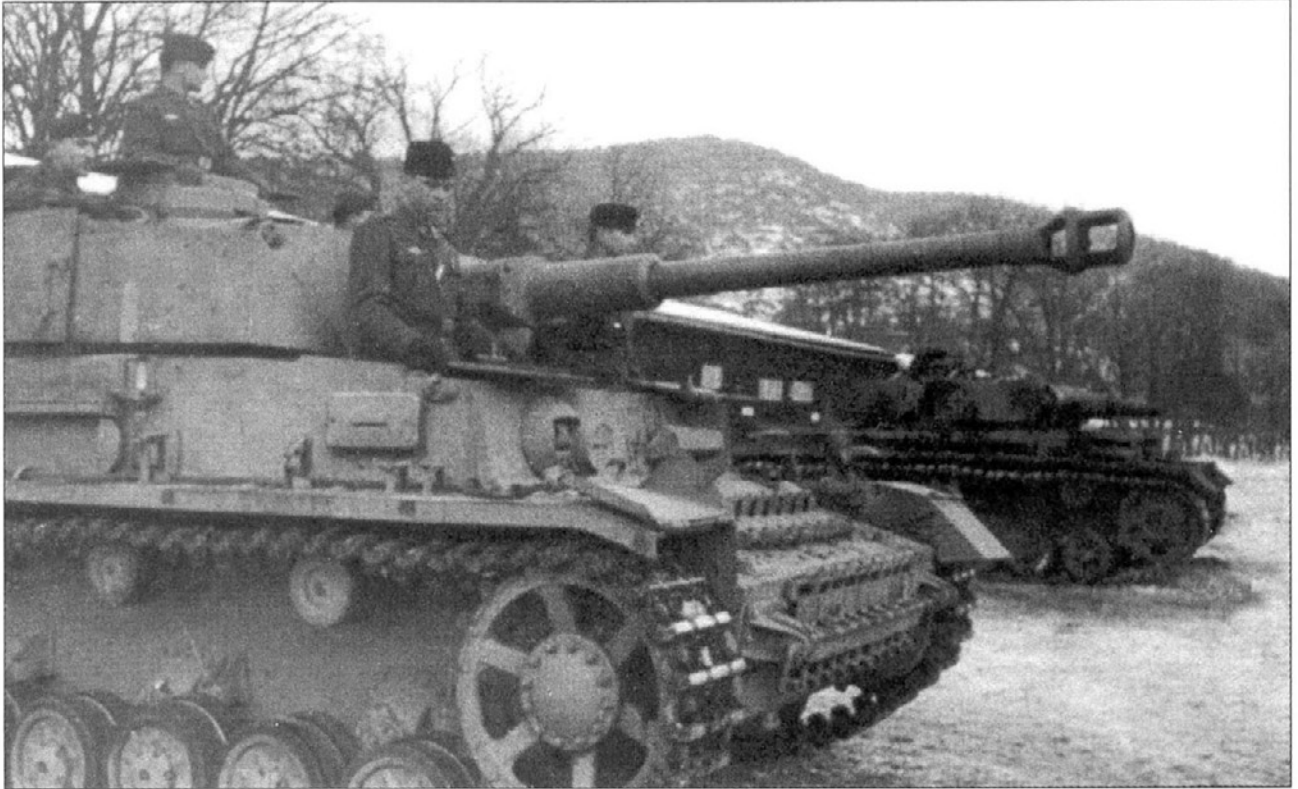
На этом танке PzKpfw IV Ausf. G демонтированы бортовые противоккумулятивные экраны корпуса, в то время как экраны на башнях остались. В бортовых экранах башни имелись двустворчатые дверцы для доступа к башенным люкам. На танках Ausf. G поздних выпусков радиоантенна монтировалась в другом месте, на этой машине антенный ввод пока не перенесен, мачта антенны убрана в специальный контейнер.
