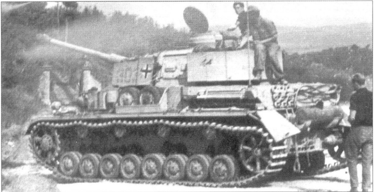
На машинах PzKpfw IV Ausf. H продолжали использоваться навесные противоккумулятивные экраны, хотя на этом танке экраны, закрывающие ходовую часть отсутствуют. На снимке - один из танков модели Ausf. H, что можно определить по форме ведущих колес. Мачта радиоантенны перенесена в кормовую часть левого борта корпуса, установлен одностворчатый люк командирской башенки. Интересная особенность - крест нарисован на внутренней, а не на внешней части откидной створки башенного экрана, возможно это говорит о том, что створка чаще была откинута, чем закрыта.
