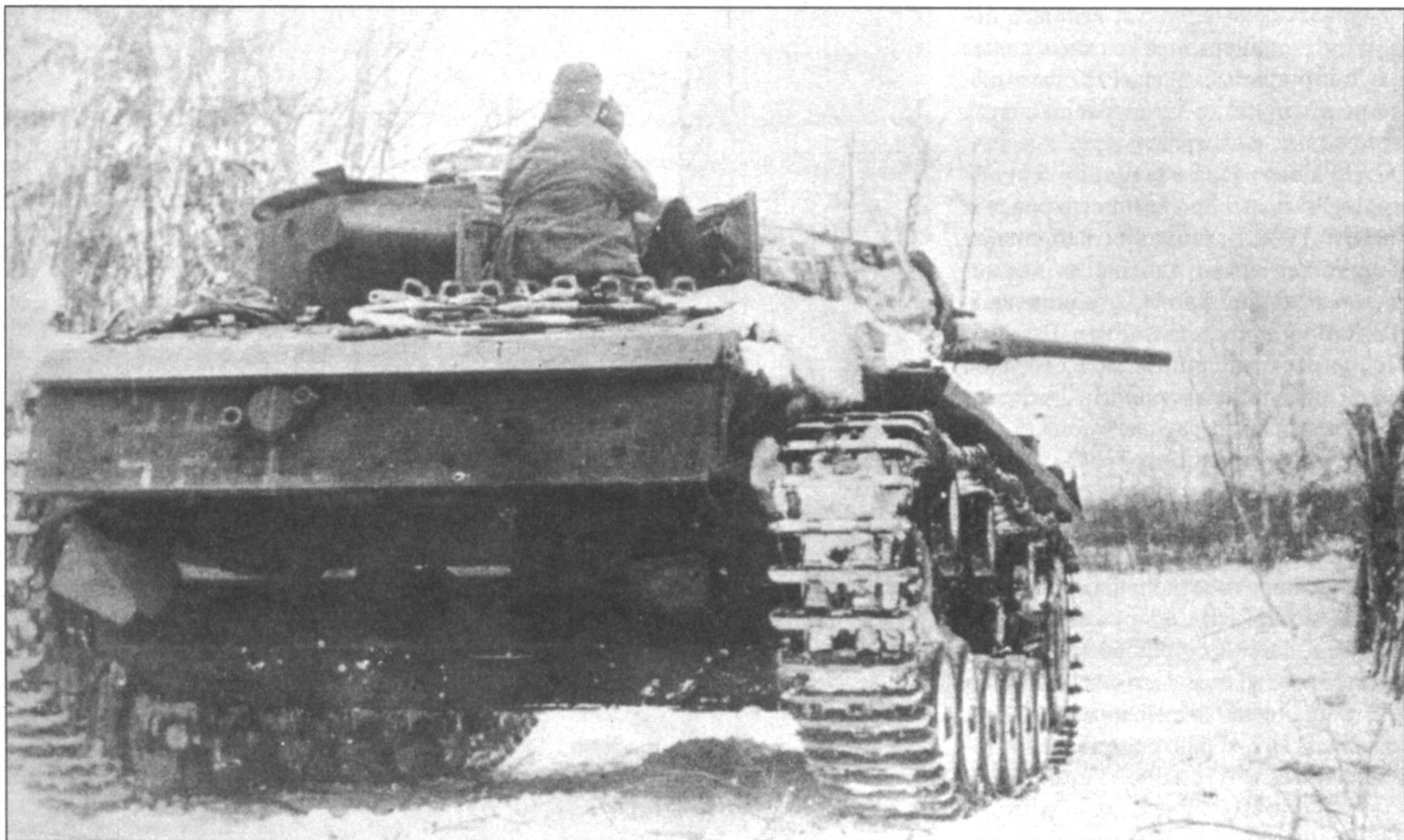
Танковый дозор, PzKpfw III Ausf.H в России, февраль 1942 г. Танк окрашен белой краской в зимний камуфляж. Обратите внимание на «ящик Роммеля», укрепленный на задней стенке башни.
