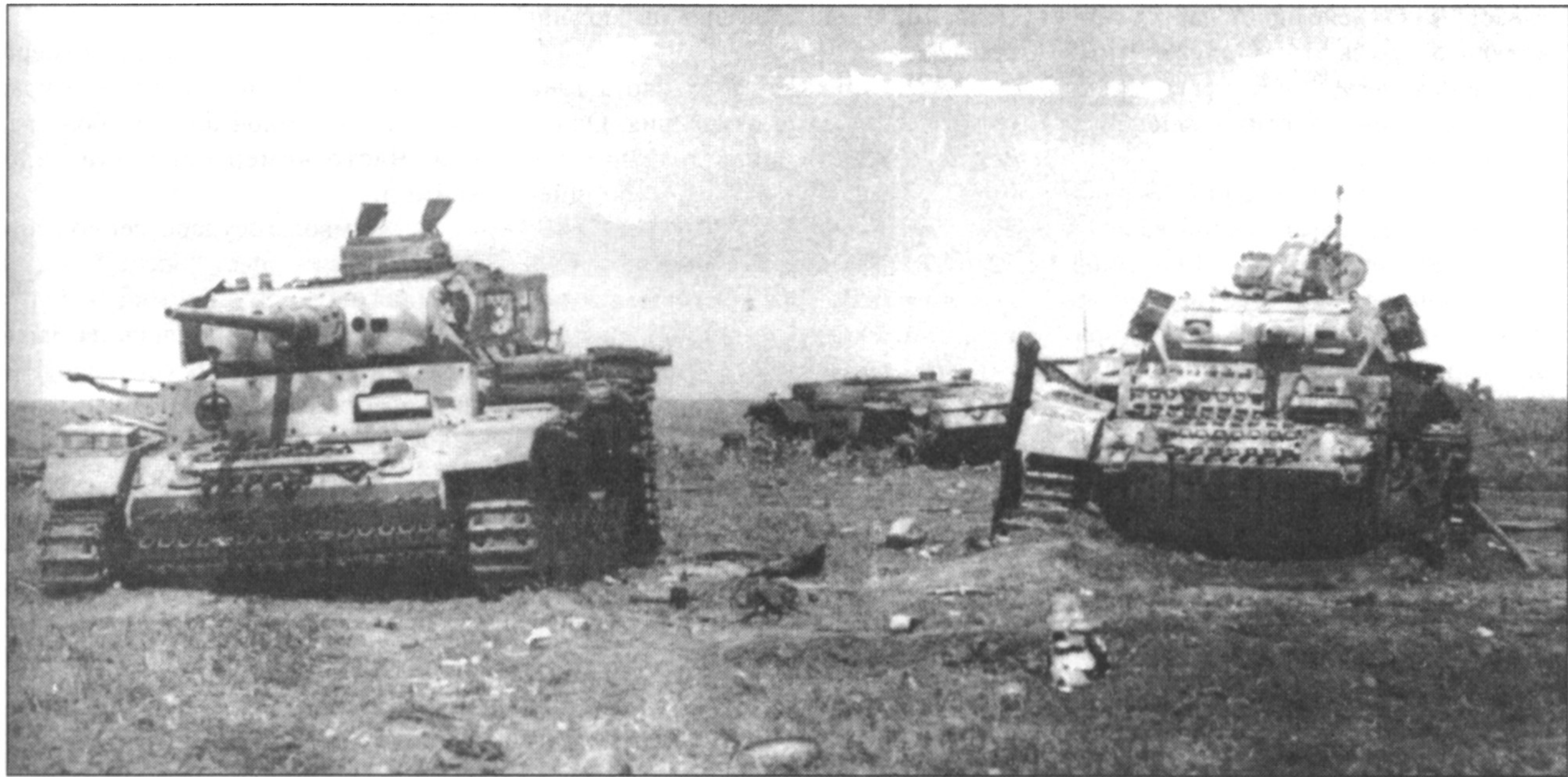
В 1943 г., в преддверии операции «Цитадель», значительное количество PzKpfw III получили противоккумулятивные экраны. На борту башни подбитого Ausf. M - эмблема 3-го танкового полка 2-й панцердивизии. На фото справа - командирский PzBefWg III Ausf. H, обратите внимание на фальшивый ствол 37-мм пушки; 9-мм мачта радиомачты слегка приподнята.
