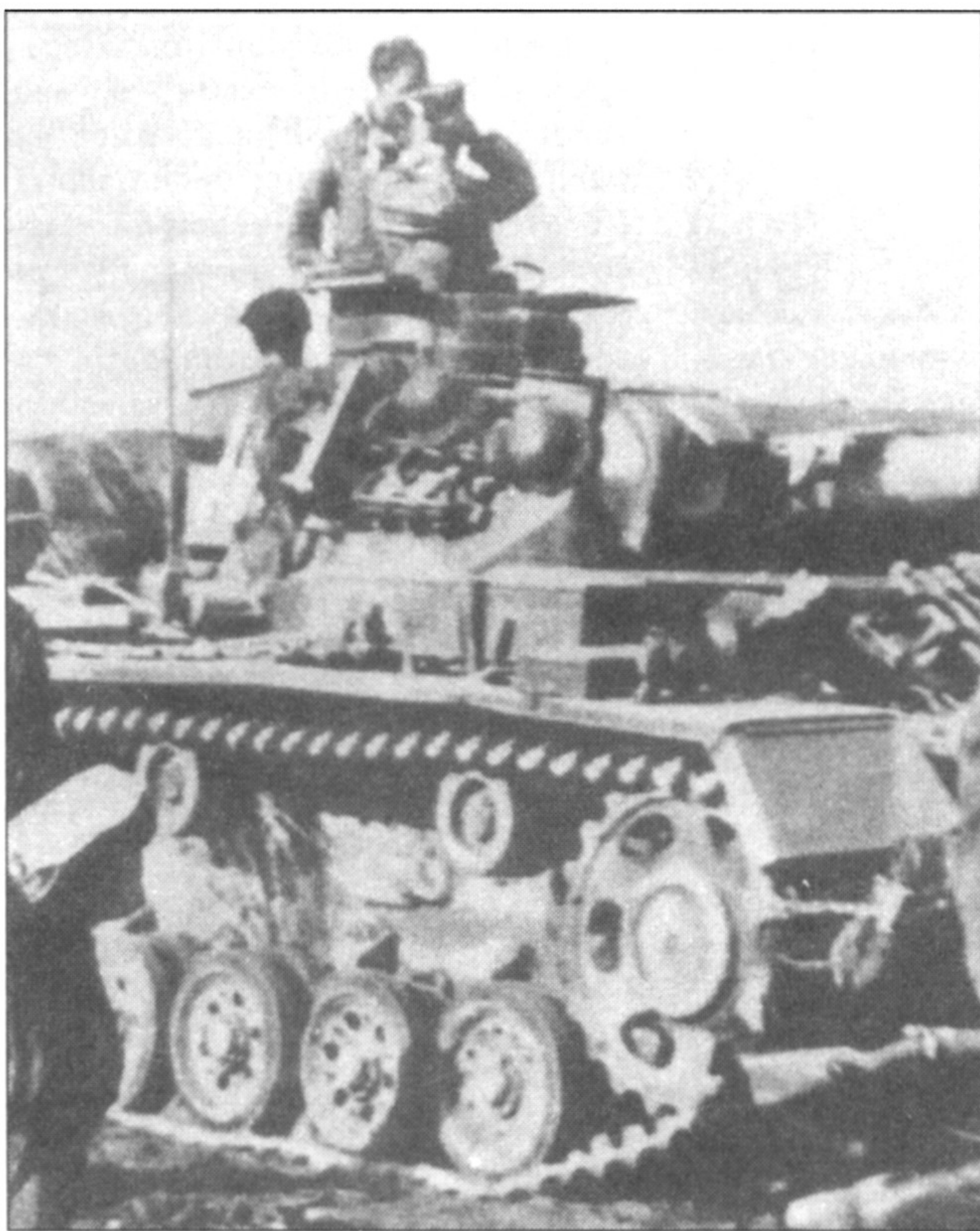
PzKpfw III Ausf.J имели бронезаслонки наблюдательных приборов толщиной 37 мм, вместо ранее использовавшихся толщиной 50 мм. Один из наблюдательных приборов в маске пушки открыт - бронезаслонка сдвинута вверх. Обратите внимание на каски, висящие на борту башни поверх гусеничных траков.
