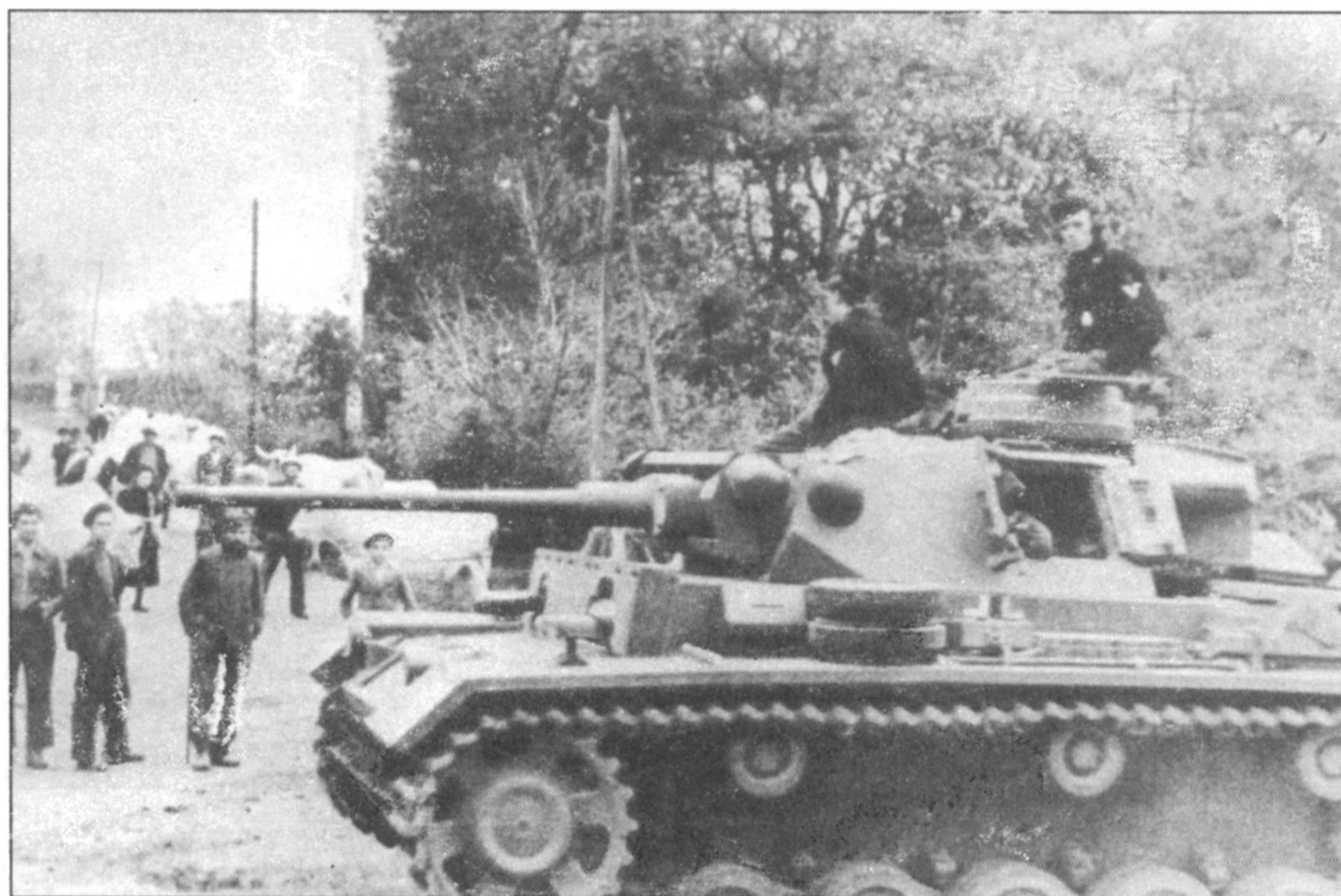
PzKpfw III Ausf.L, окрашенный белой краской, зима 1943 г. На Ausf.L была изменена форма воздухозаборников системы охлаждения двигателя и люков в крыше моторного отделения. Наблюдательные приборы в бортах башни отсутствуют.
