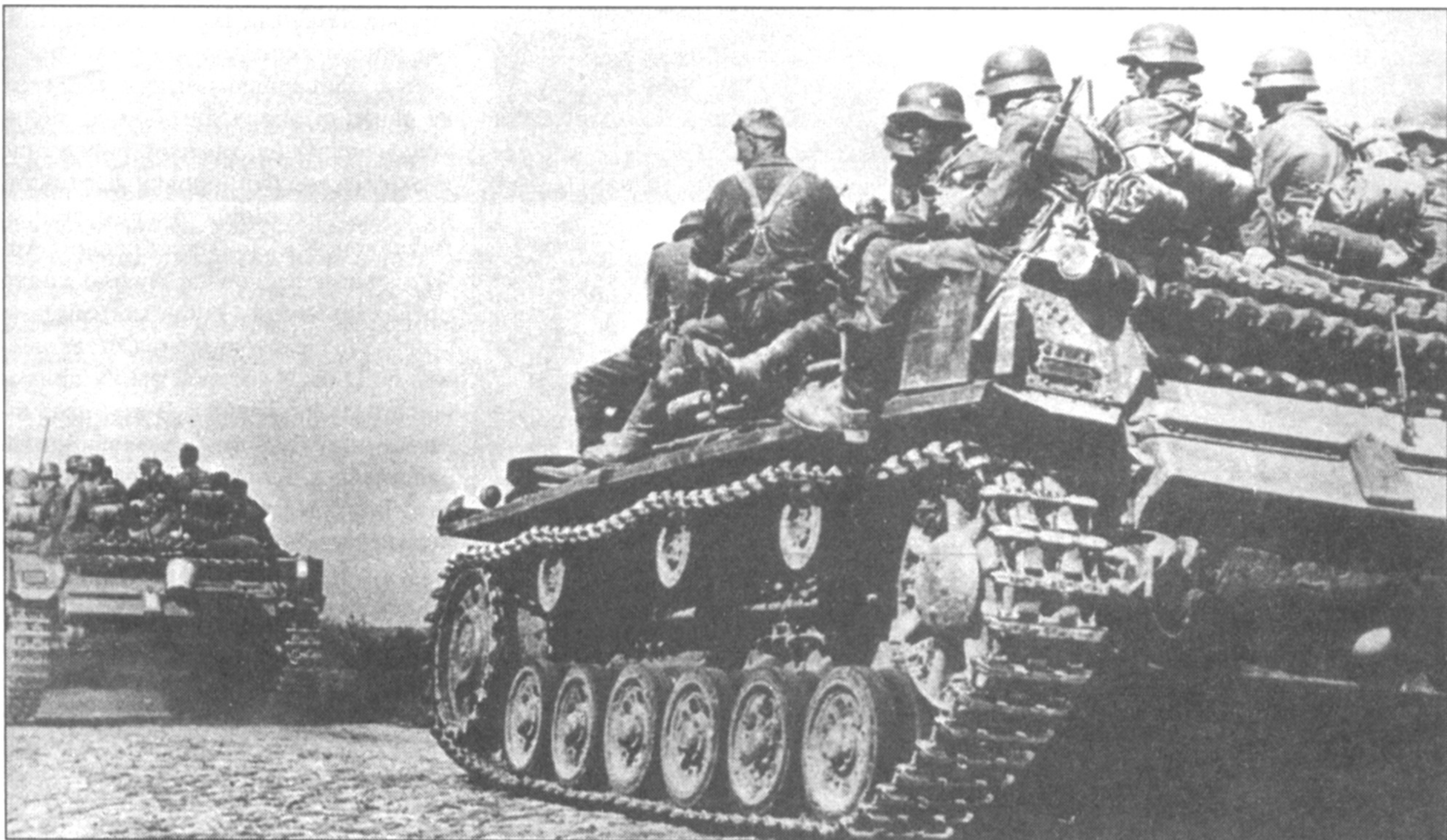
Два Ausf.F двигаются к передовой. На броне танка разместилось отделение пехоты. Передвижение на броне танков экономило силы пехотинцев, с другой стороны, десант был полезен в бою, защищая боевую машину от пехоты противника. Последние 100 построенных Ausf.F вооружались 50-мм 42-калиберными пушками, большинство ранее изготовленных танков этой модификации были перевооружены такими же пушками.
