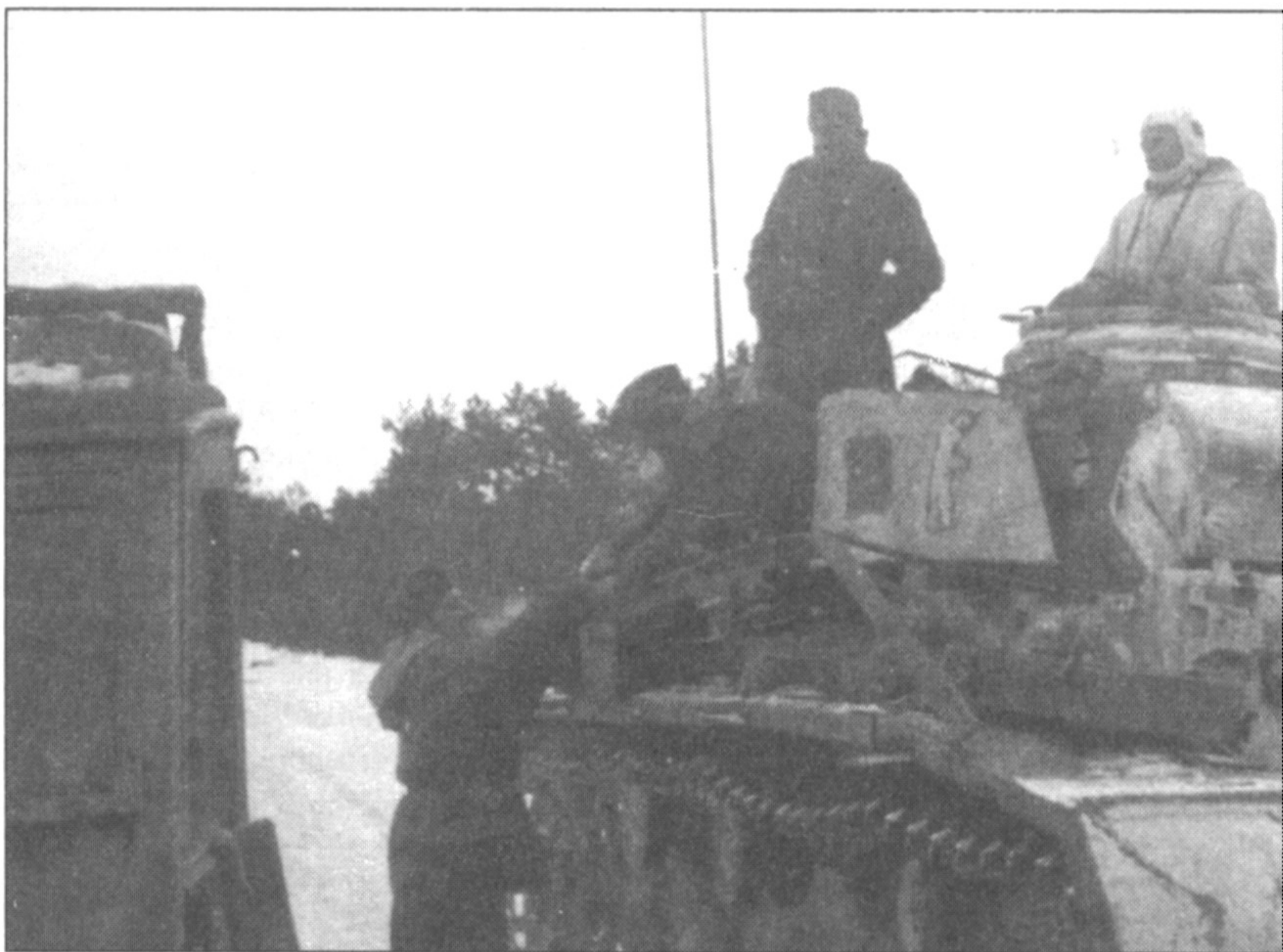
Ausf.L с демонтированными бортовыми противоккумулятивными экранами, под башенным экраном виден блок дымовых грантометов. На башенном экране изображен медведь - эмблема 3-й танковой дивизии.
