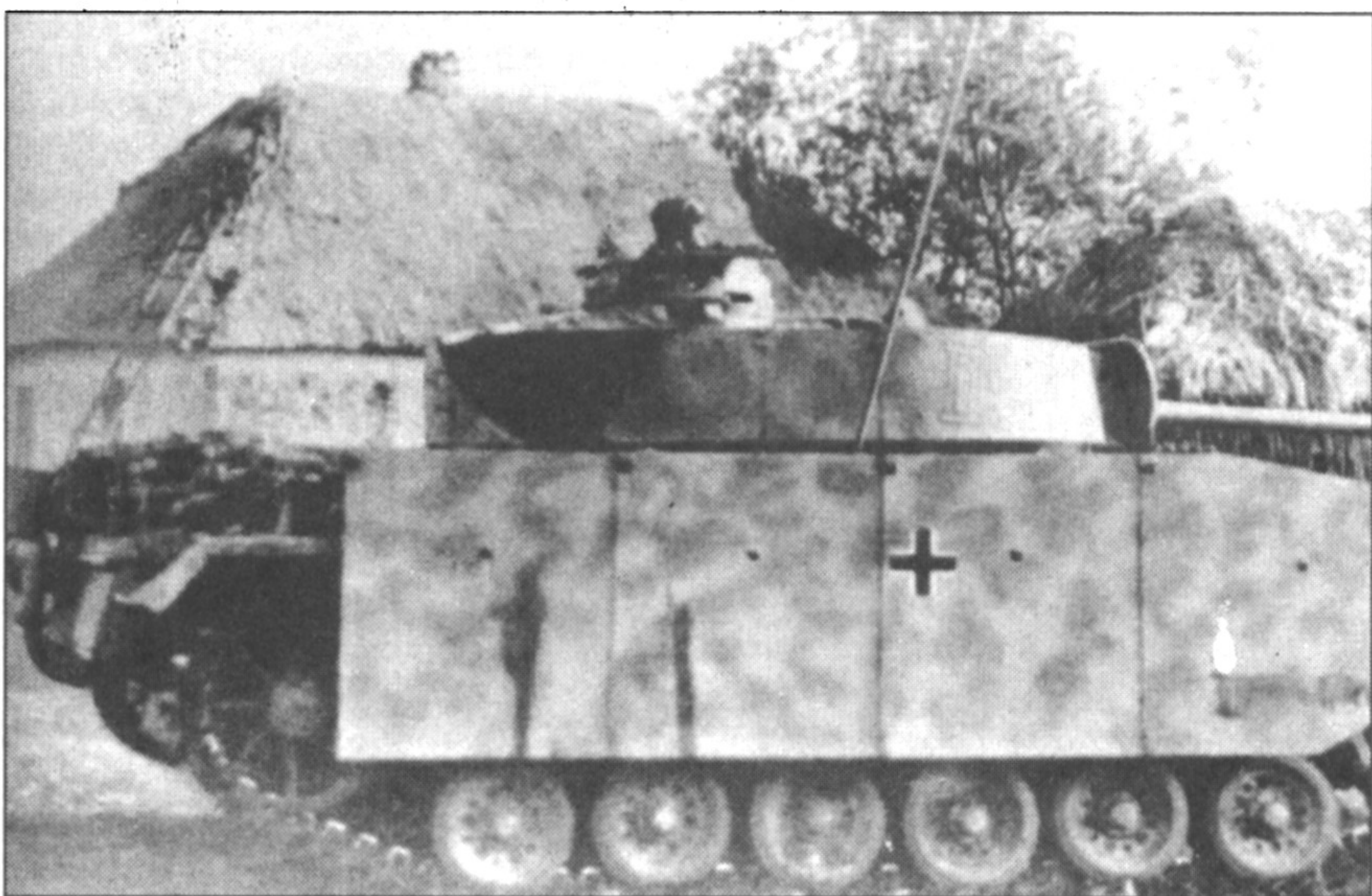
Поединок брони PzKpfw III со снарядами русских противотанковых пушек продолжался всю войну. В 1943 г. на танки Ausf.M и часть Ausf.L начали устанавливать экраны Seitenschurzen, ослабляющие поражающее действие кумулятивных боеприпасов. Этот Ausf.M сфотографирован на улице украинского села.
