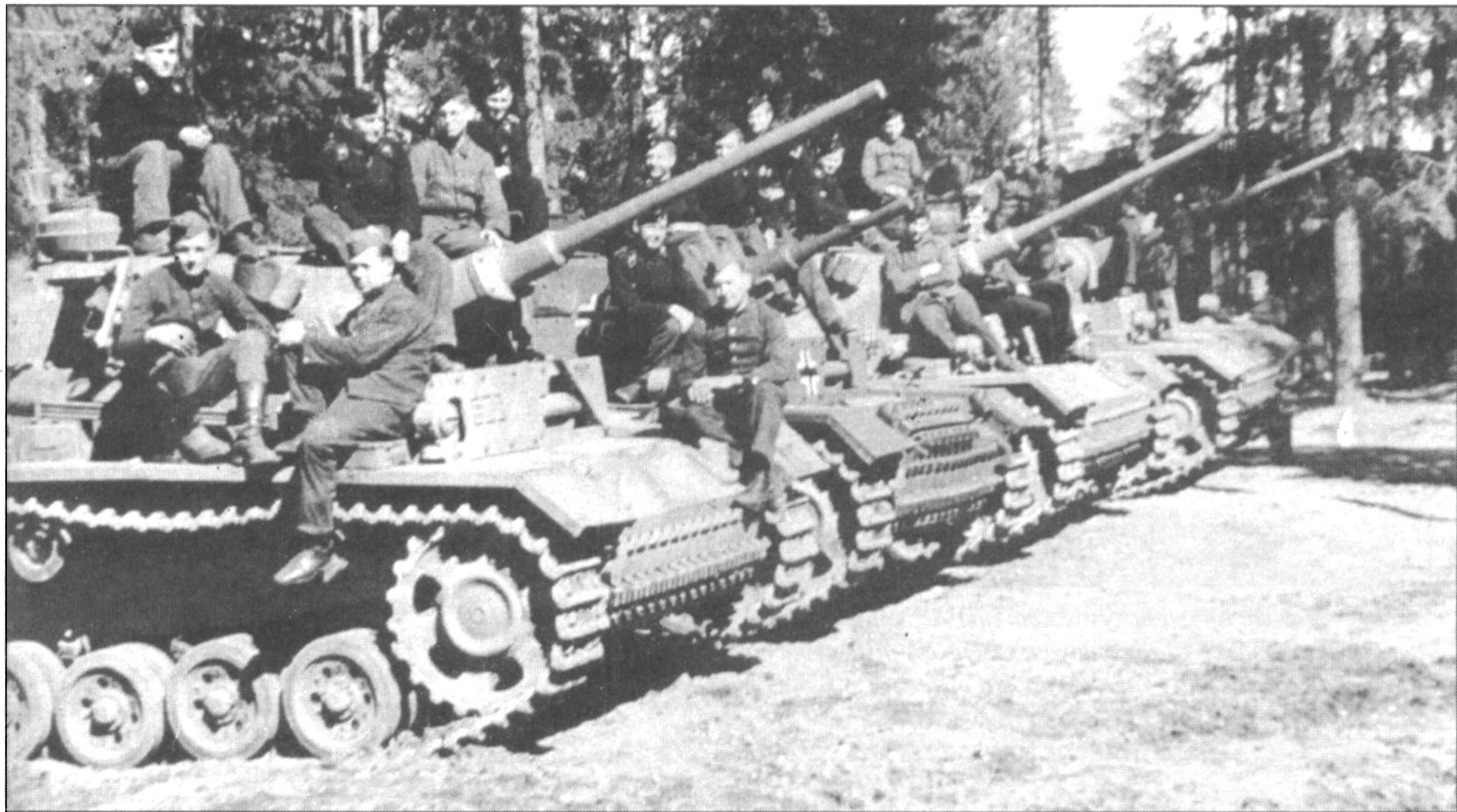
Гитлер всегда очень интересовался военной техникой, он лично приказал устанавливать на PzKpfw III 50-мм орудия с длиной ствола 60 калибров. Удлиненный ствол бросается в глаза на данной фотографии шеренги Ausf.M., на башнях танков варианта «М» монтировались два блока строчных дымовых гранатометов.
