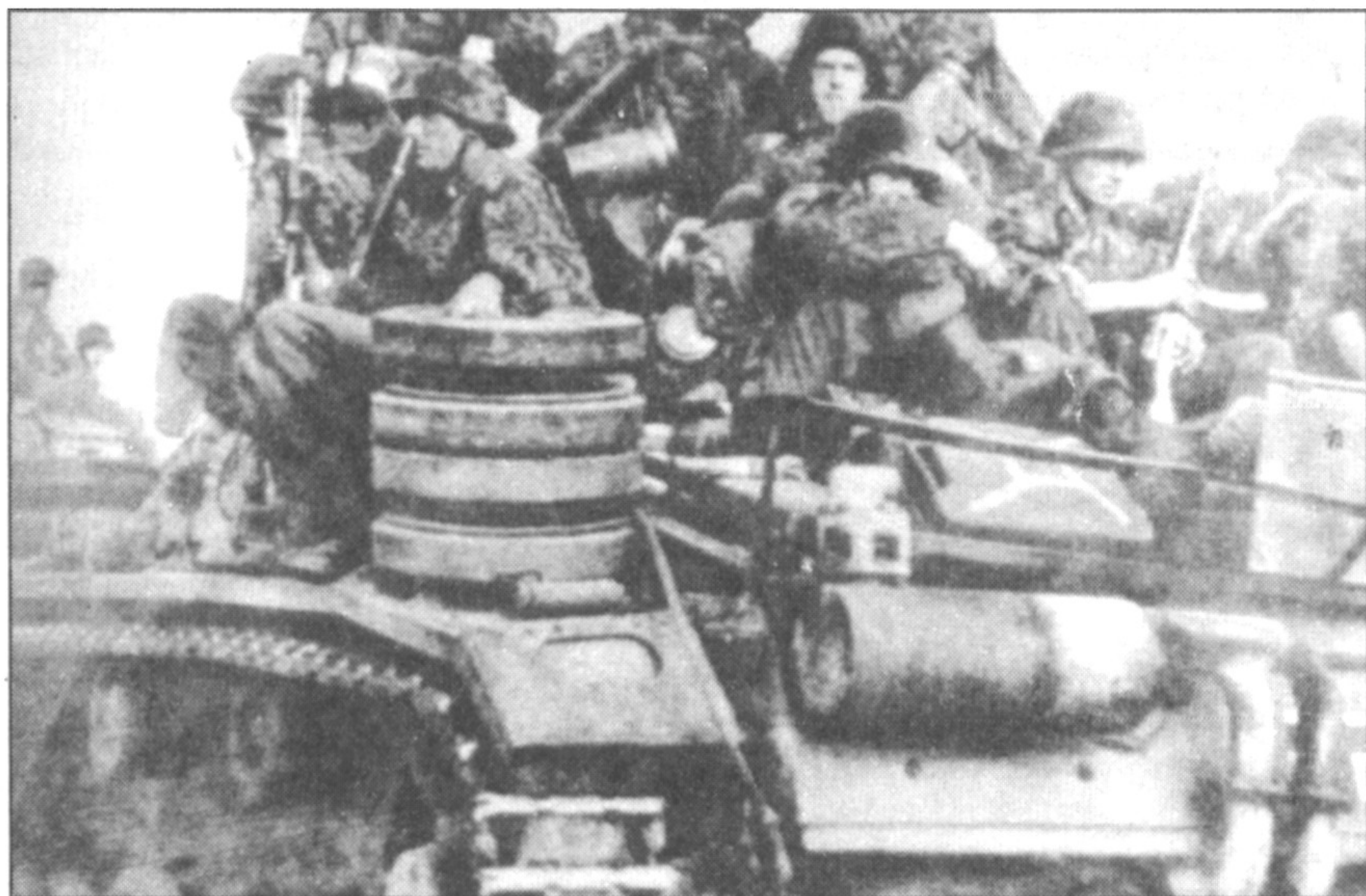
PzKpfw III Ausf.M, отличительная особенность машин этой модификации - глушитель характерной формы на выхлопном патрубке двигателя. Обратите внимание на укладку запасных опорных катков.
