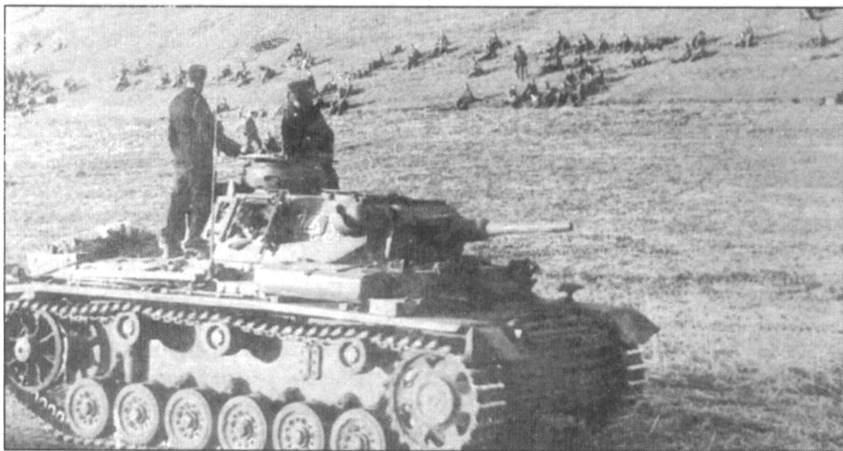
Вооруженный короткоствольной 50-мм пушкой Ausf. J, на заднем плане - пехота на привале. Тактический номер «143» на борту башни танка красного цвета с белой окантовкой.
