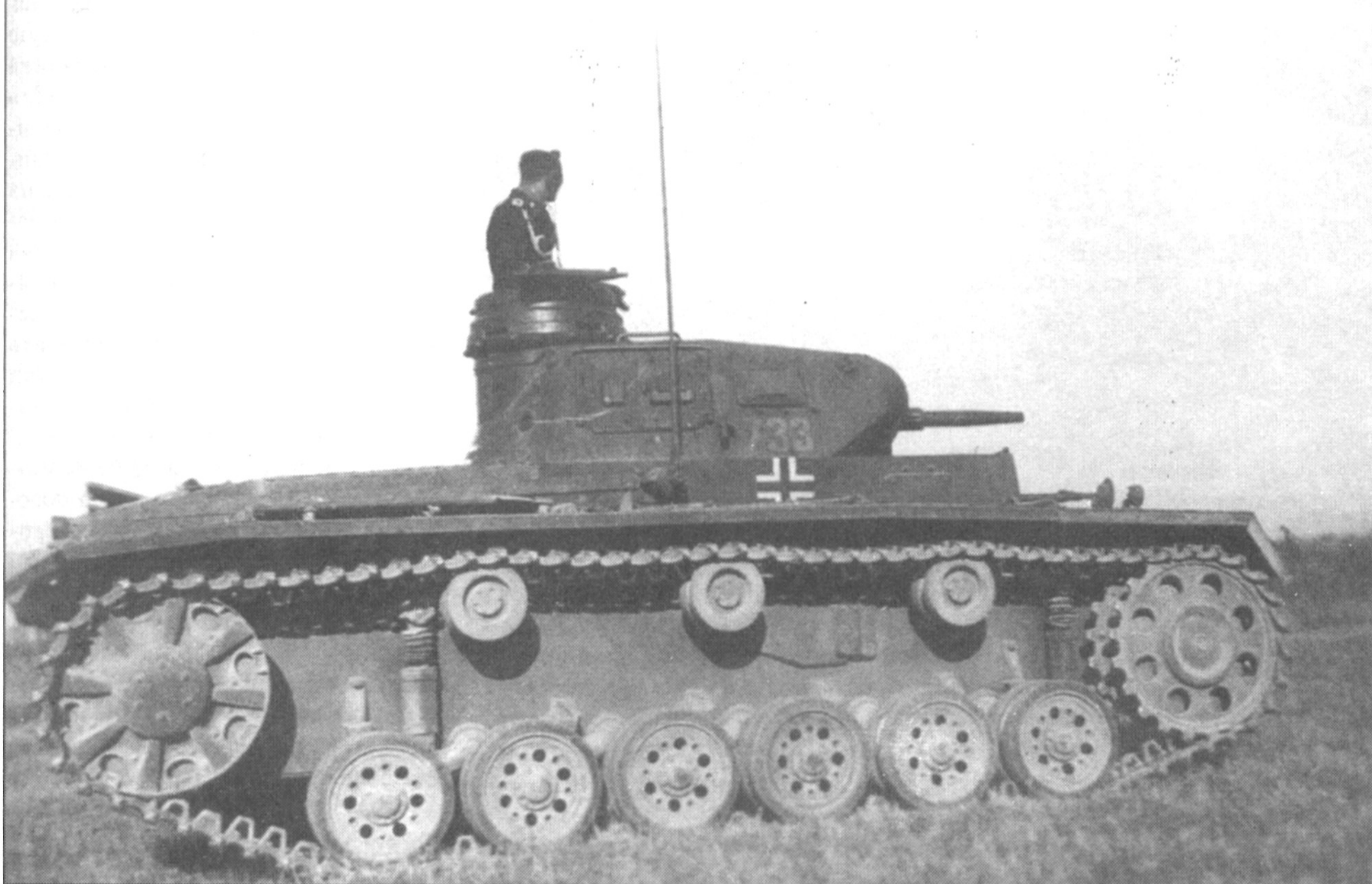
PzKpfw III Ausf.F сфотографирован 5 декабря 1940 г. на учениях в Ярговисте. Tактический номер «733» на башне - скорее всего желтого цвета. На снимке очень хорошо видна ходовая часть танка, состоящая из шести опорных катков с индивидуальной торсионной подвеской, ведущего колеса спереди и ленивца сзади. Обратите внимание на аварийный люк в борту корпуса.
