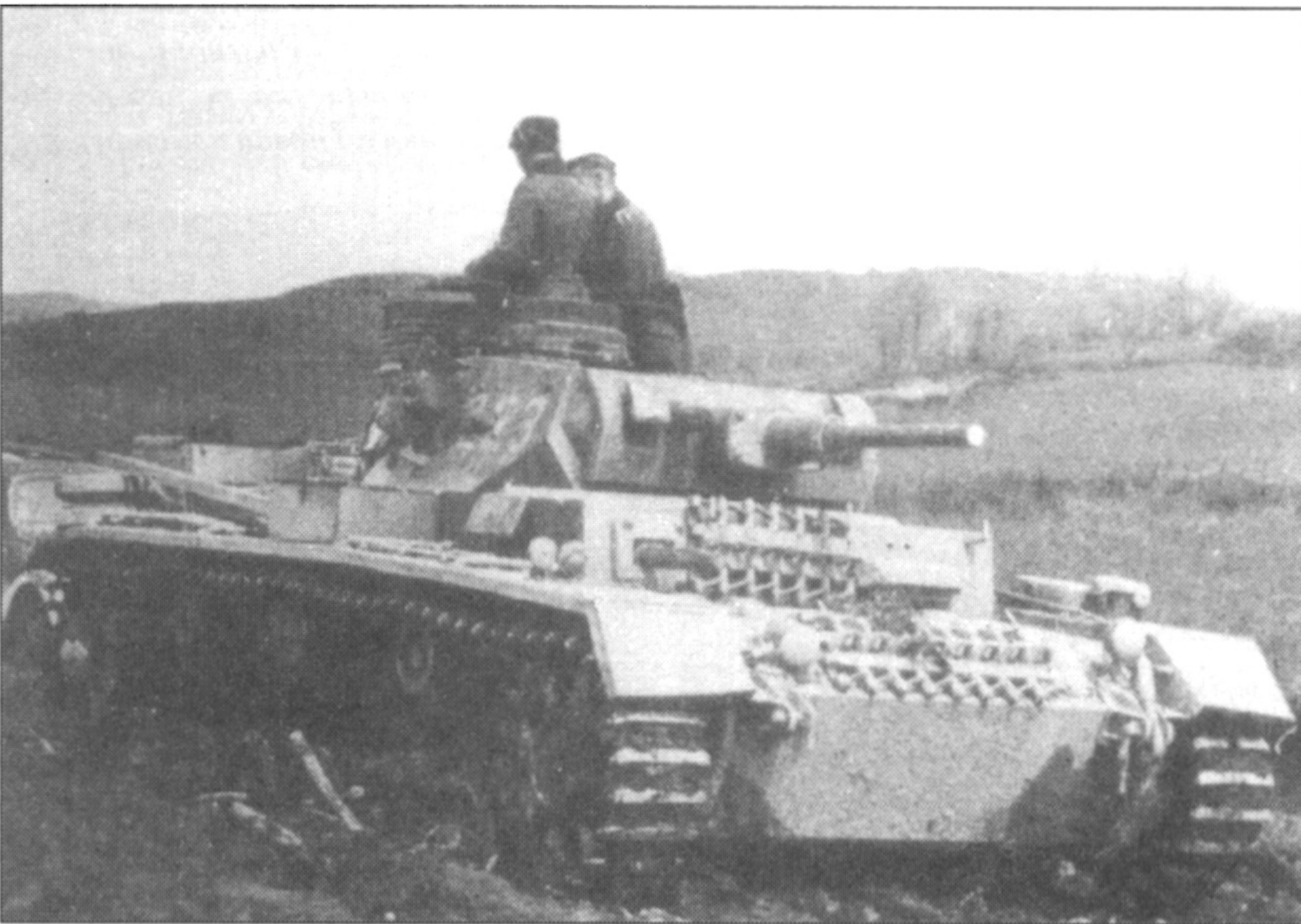
PzKpfw III Ausf.G на полевых учениях. Машины этой модификации ранних выпусков вооружались 37-мм пушкой, показавший в боях свою неадекватность, в конце 1940 г. на танки начали ставить короткоствольные 50-мм пушки.
