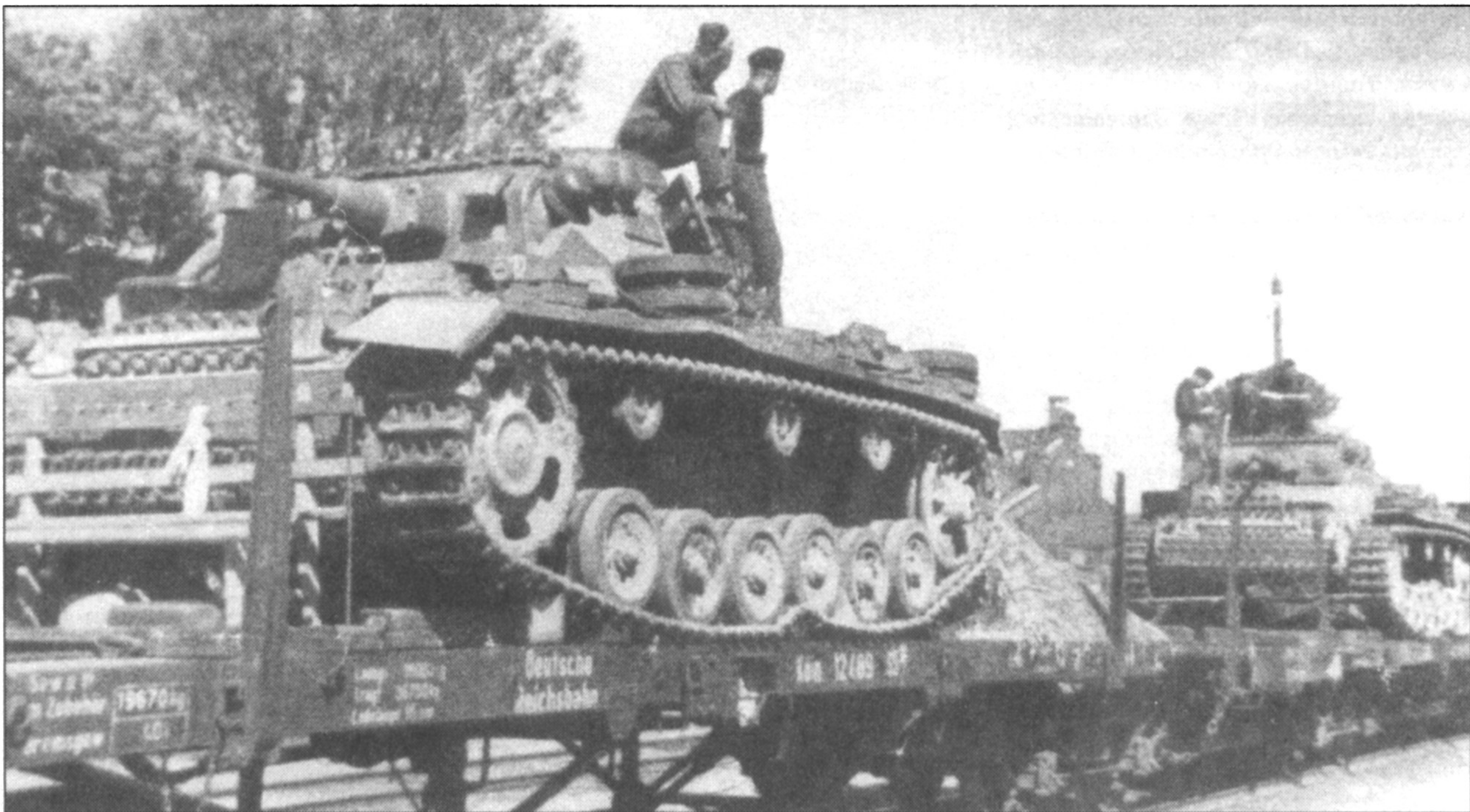
PzKpfw III Ausf. J на железнодорожной платформе, за танком видны сложенные брезентовые чехлы.
