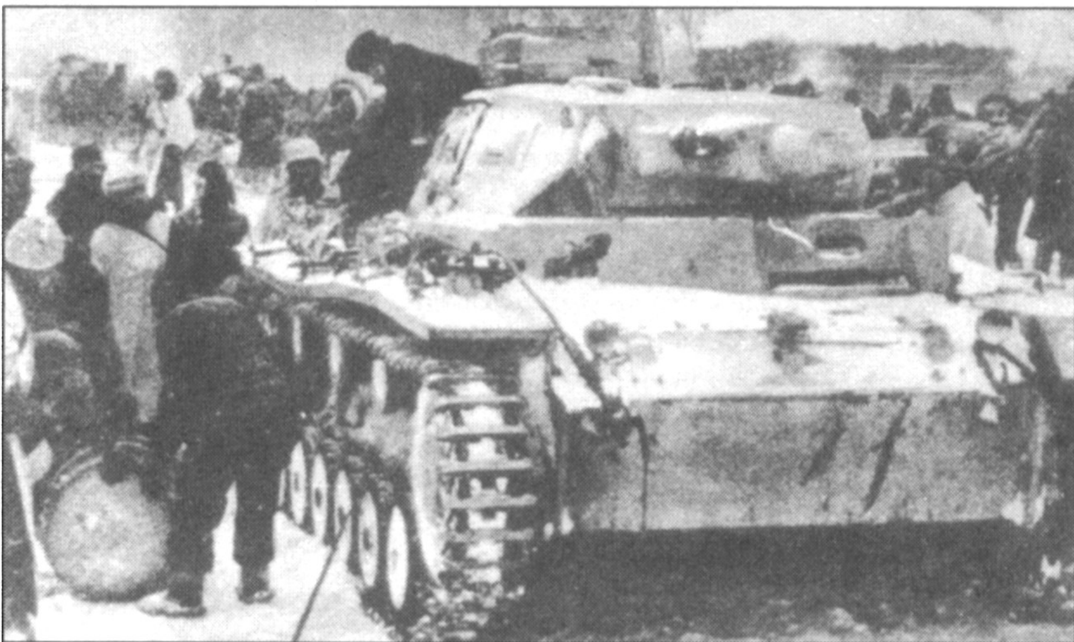
Перекрашенный в зимний белый цвет PzKpfw III Ausf.F, Восточный фронт, 1942 г. Экипаж готовит танк к бою. Танки Ausf.F проходили переоборудование, в ходе которого на лобовые части корпуса и надстройки монтировалась накладная броня толщиной 30 мм и устанавливалась 50-мм пушка с длиной ствола 42 калибра.
