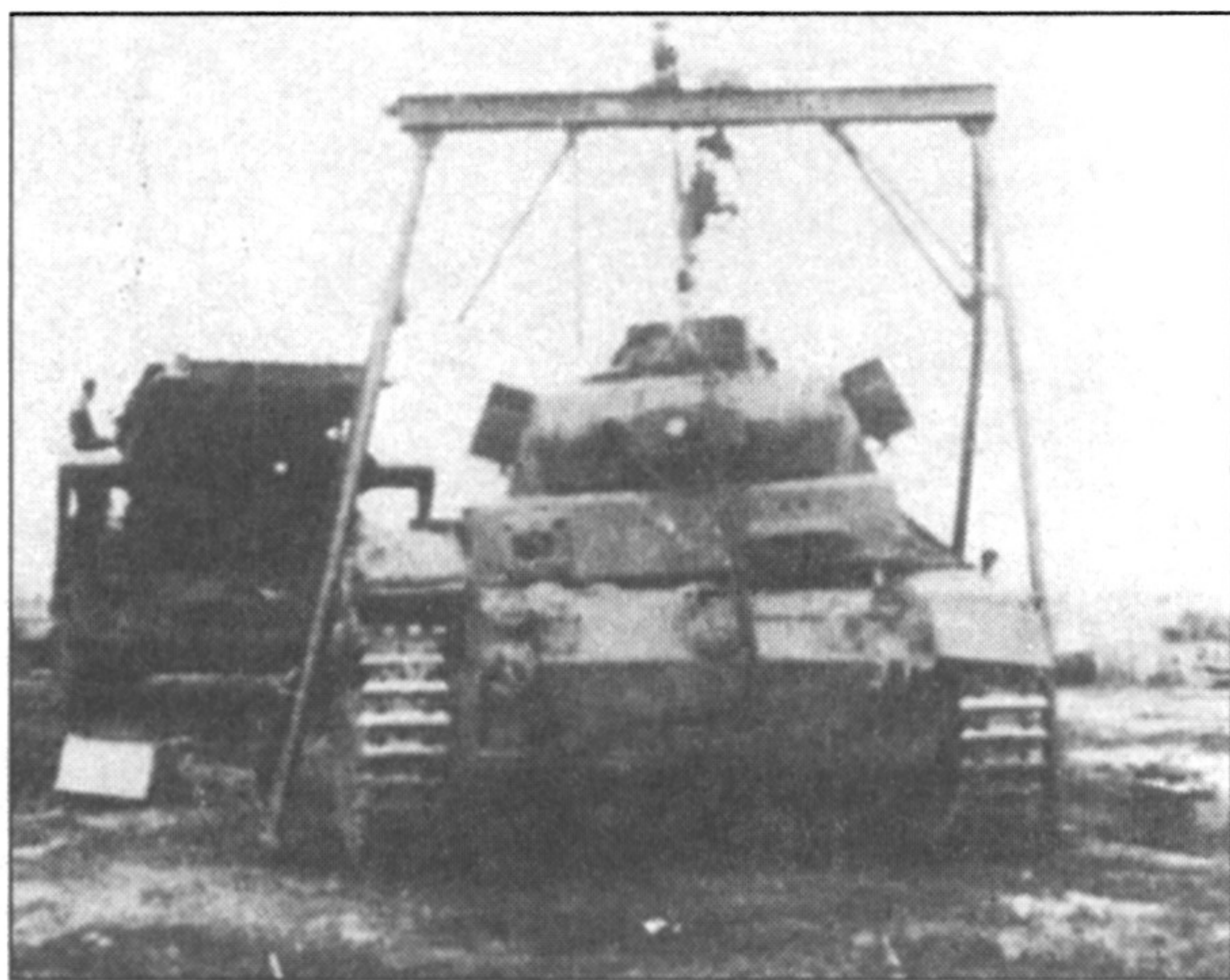
Ремонт Ausf. G в полевых условиях, с помощью козлового крана демонтируется надстройка корпуса вместе с башней.
