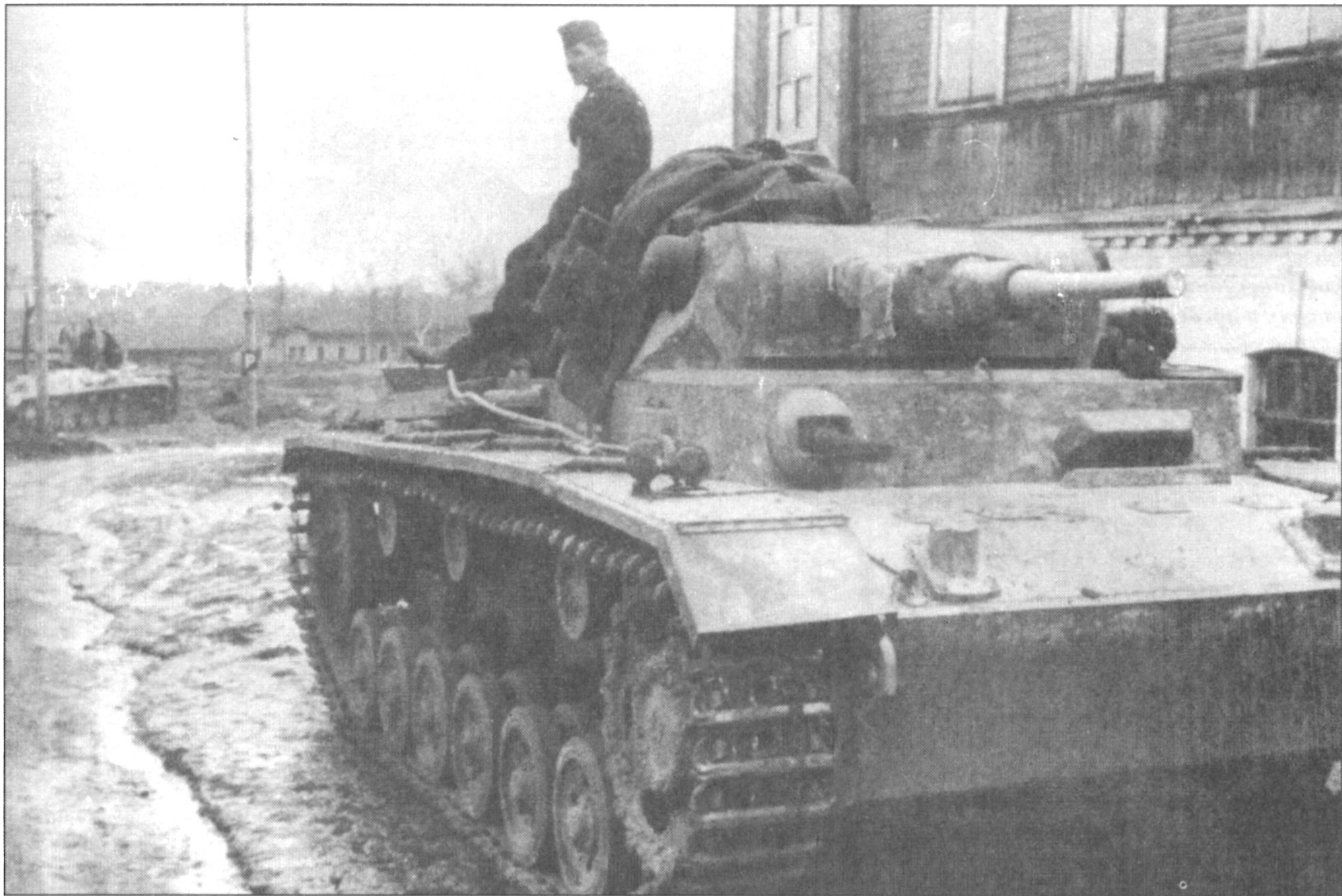
Белая краска почти совсем слезла с запечатленного на фотографии Ausf.J. Хорошо видна новая установка курсового пулемета в прямоугольной амбразуре и буксировочные кронштейны новой формы на лобовом бронелисте корпуса. Начиная с танков модификации «J», форма корпуса была несколько упрощена.
