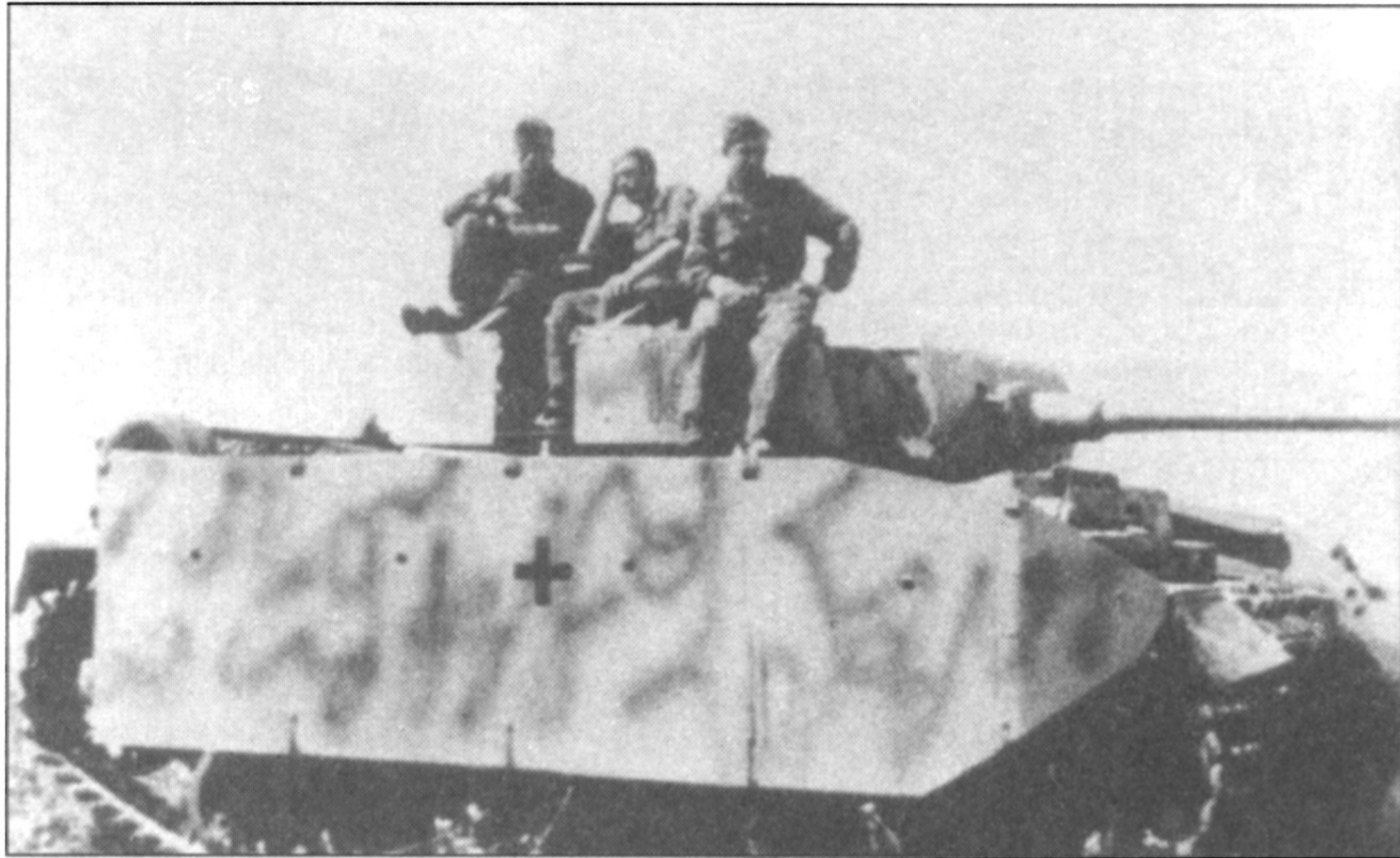
Оборудованный противоккумулятивными экранами PzKpfw III Ausf.L. Крест - черного цвета, без белого контура, камуфляжные полосы темно-зеленого и красно-коричневого цвета нанесены поверх основного песочно-желтого тона из пульверизатора.
