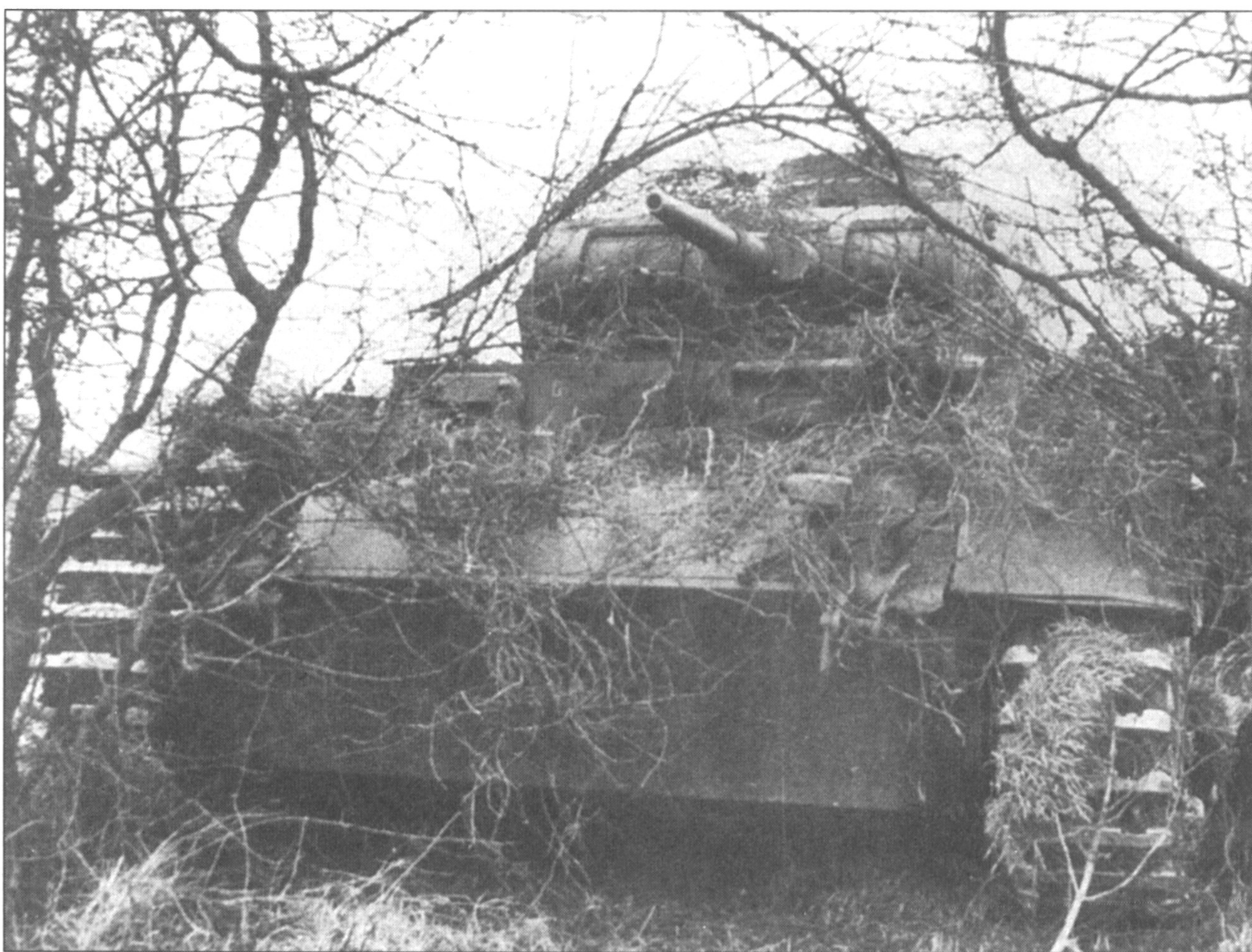
Замаскированный Ausf.E готов к бою. Хорошо видна 37-мм пушка. Особенностью ранних модификаций «тройки» являлась «внутренняя» маска пушки, которая была сильно уязвима от огня противотанковых средств.
