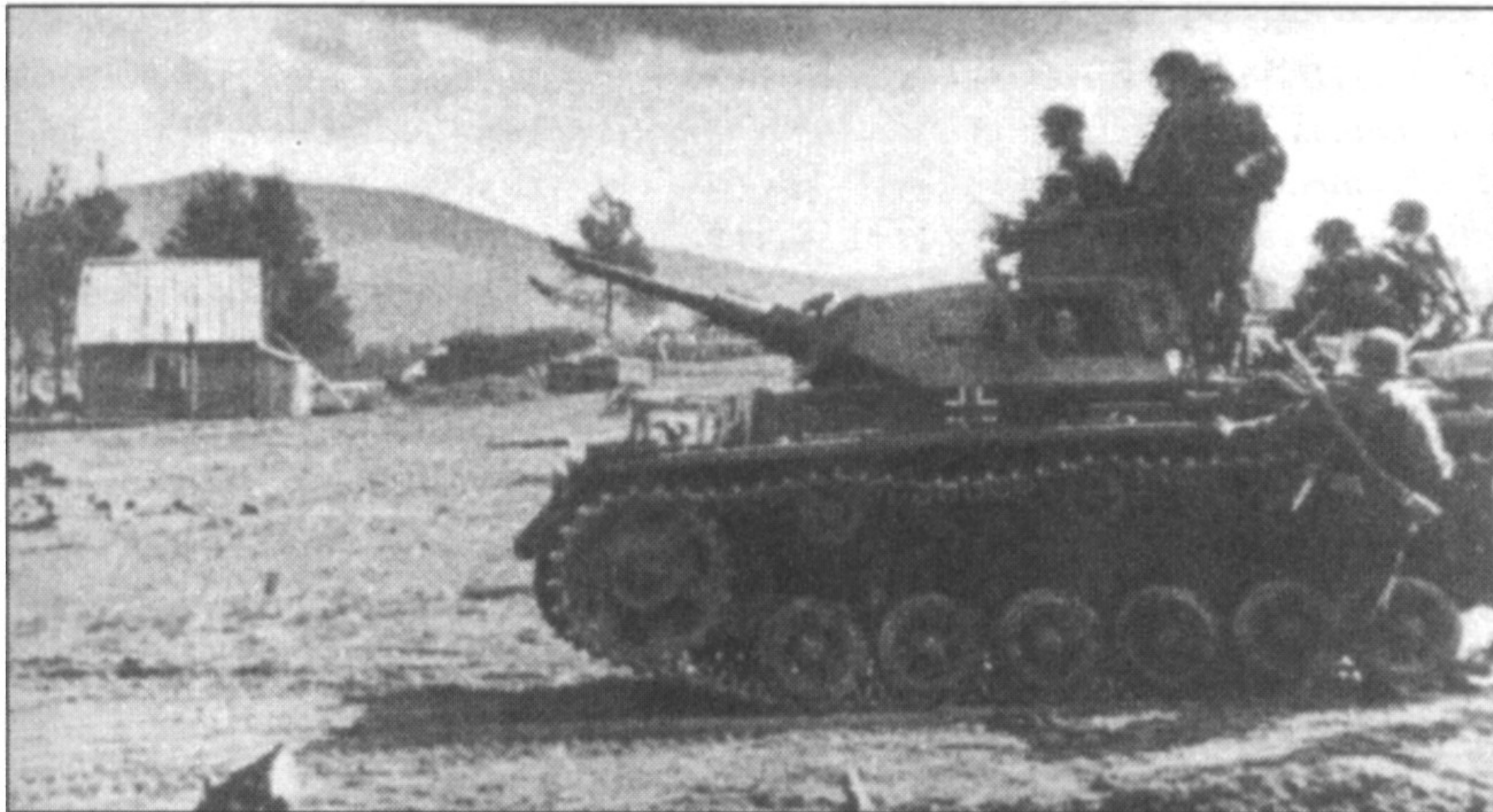
Где-то в России, PzKpfw III Ausf.H вместе с пехотой; рекогносцировка перед атакой. Ходовая часть танков Ausf.H была приспособлена под 40-см гусеницу, на танках варианта «H» устанавливались гидроамортизаторы другой формы, а первый поддерживающий ролик - сдвинут ближе к передней части корпуса.
