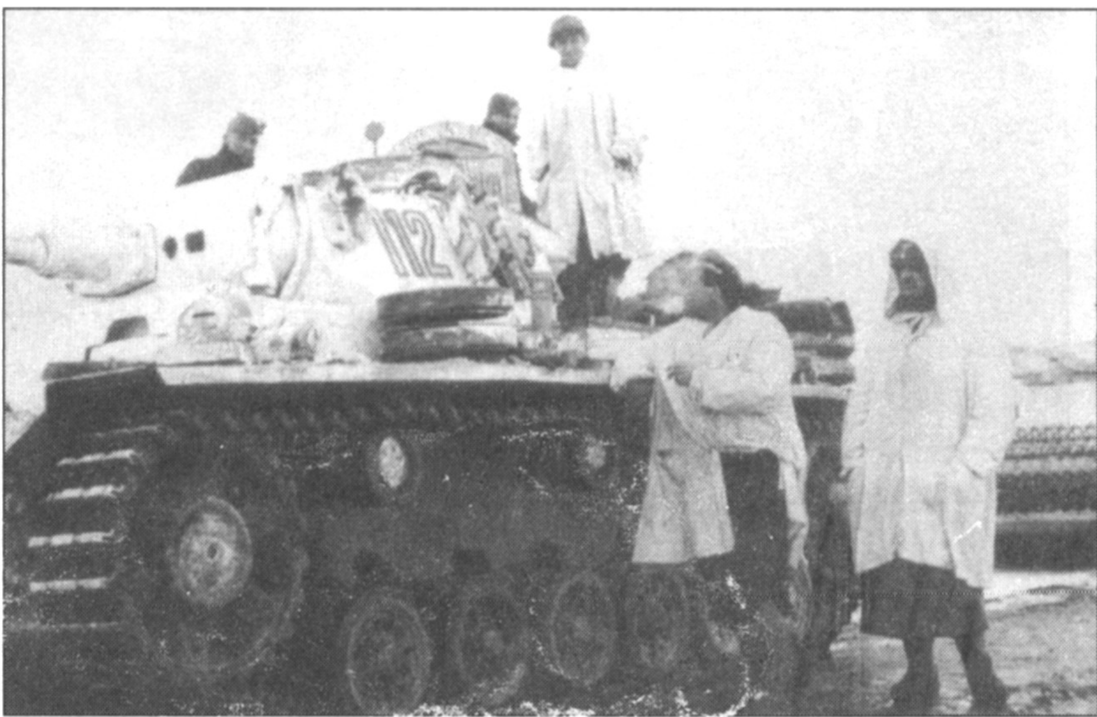
PzKpfw III Ausf.L, окрашенный белой краской, зима 1943 г. На Ausf.L была изменена форма воздухозаборников системы охлаждения двигателя и люков в крыше моторного отделения. Наблюдательные приборы в бортах башни отсутствуют.
