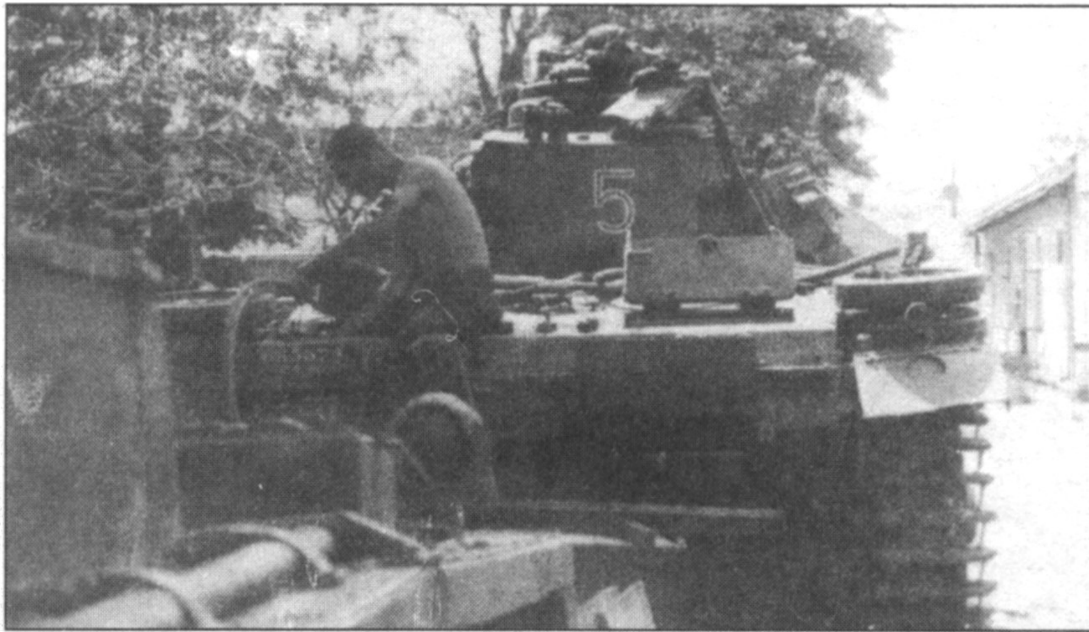
Осмотр двигателя на PzKpfw III Ausf.H 5-й танковой дивизии, август 1941 г., район Потсдама. Заметен написанный белой краской на кормовом листе корпуса заводской номер шасси - «66557». Tактический номер на башне красного цвета с белой окантовкой.
