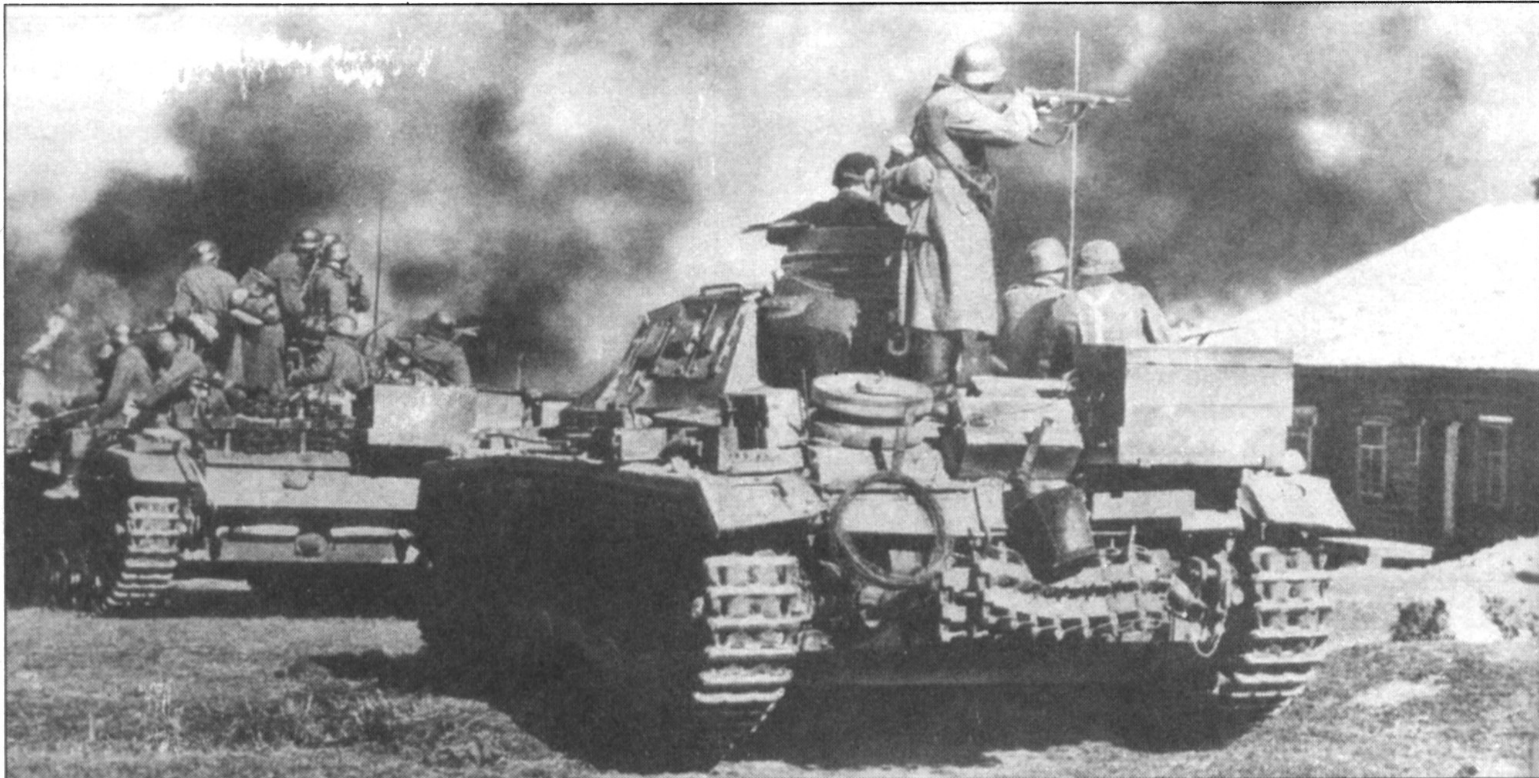
Россия, танки PzKpfw III медленно передвигаются по горящей деревне. Впереди идет Ausf.G, за ним следует Ausf.J. Машины увешаны дополнительным снаряжением.
