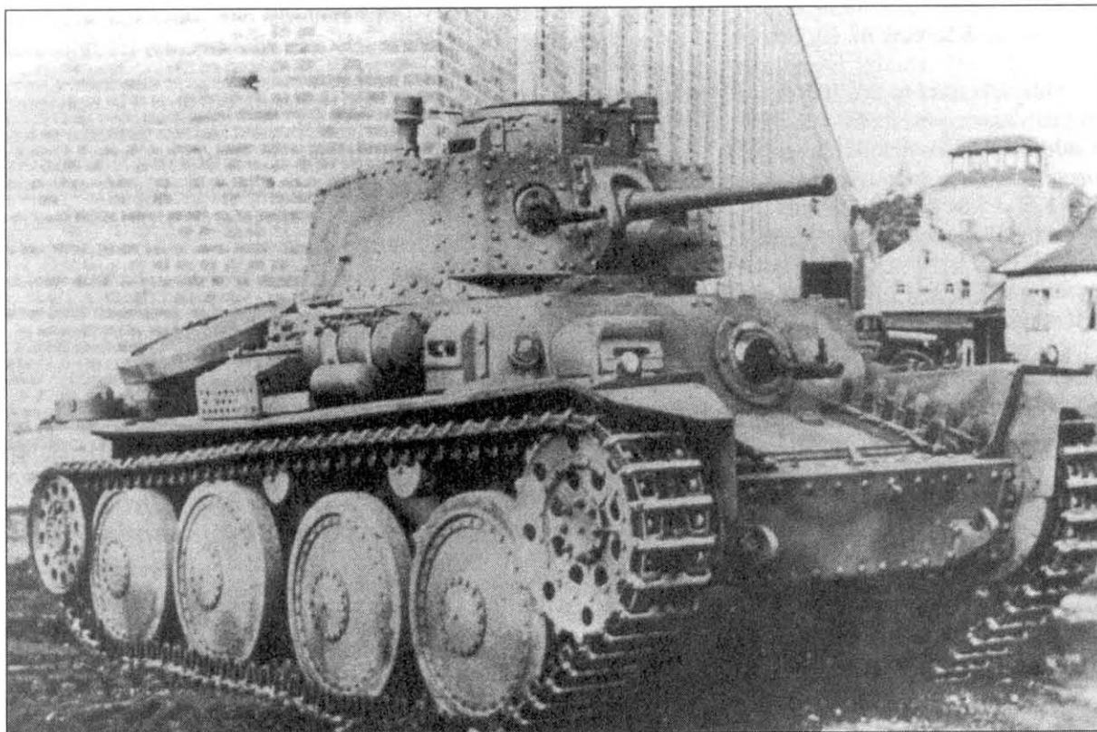
Танки LT vz.38 выпускались по лицензии в Швеции под обозначением Styr m/41. От LT vz.38 шведский танк отличался вооружением: пушка 37-мм Vofors m/38 и 8-мм пулеметы m/39.
