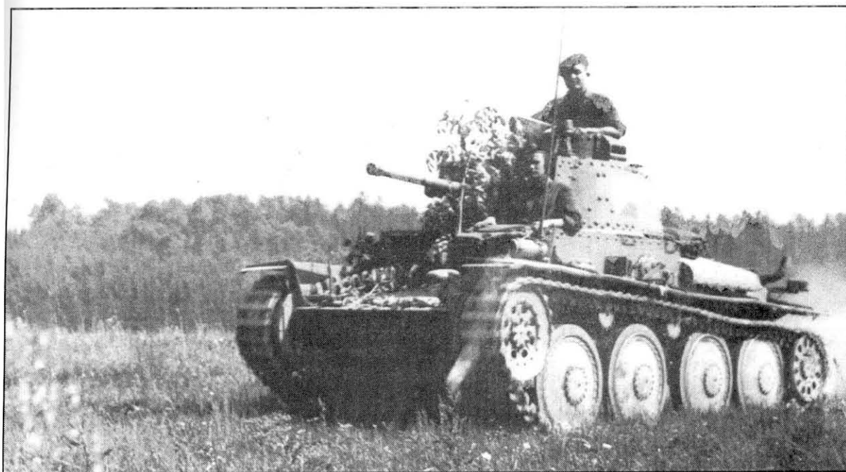
Этот чехословацкий LT-38/37 сфотографирован вскоре после войны. Фашистскую символику замазали, а на бортах башни изображили большие чехословацкие флаги. Цилиндрический предмет на передней части левого крыла - огнетушитель. На некоторых машинах огнетушители хранились на корме.
