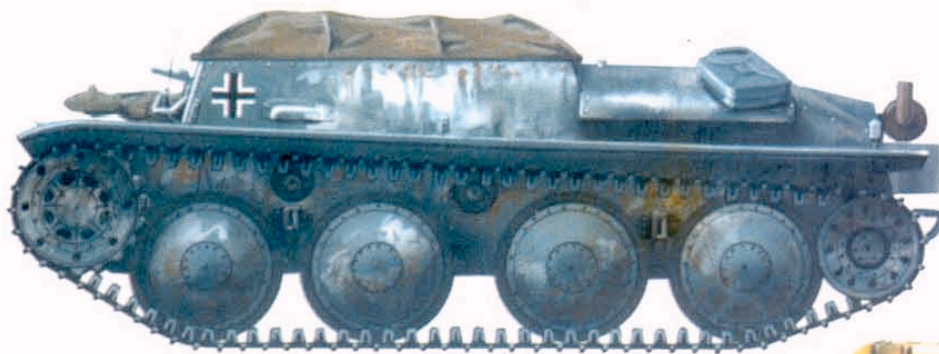
Транспортер боеприпасов на базе PzKpfw 38(t), Сталинград, зима 1942 г.
