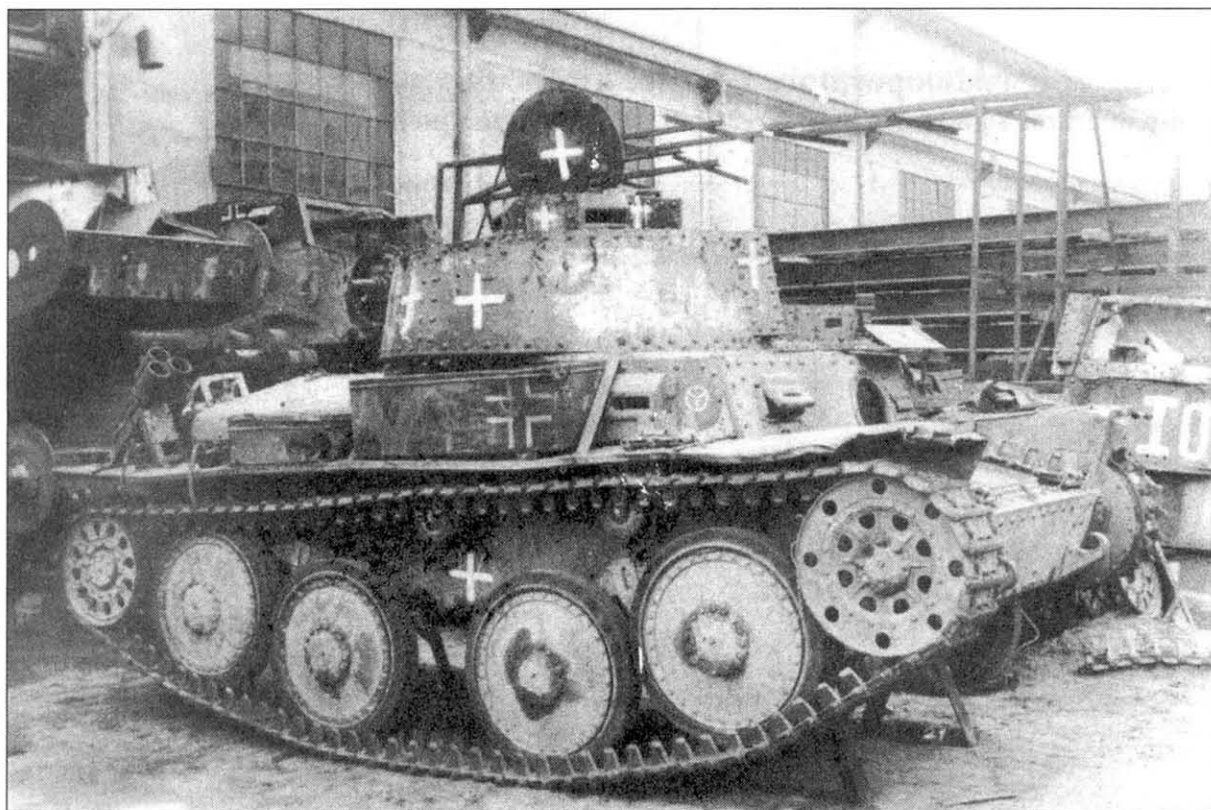
Крупный ремонт танков PzKpfw 38(t) обычно проводили на заводе. Этот танк, отправленный на завод для ремонта, оснащен гранатометами для метания дымовых и зажигательных гранат.
