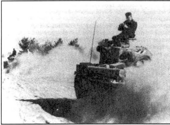
Лето 1941 года. PzKpfw 38(t) Ausf. C едет по России. Танк обвешан дополнительными предметами оснащения, что было обычным делом на Восточном фронте.
