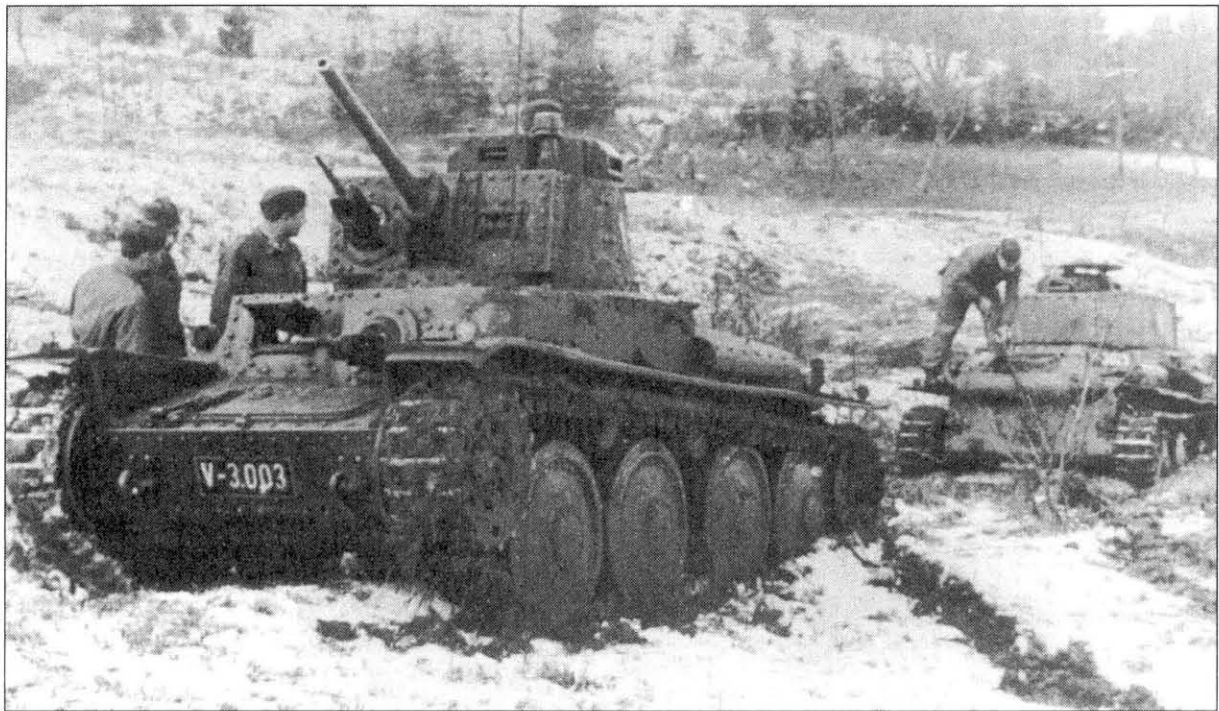
Словацкий LT-38. Этот танк соответствовал чехословацкому LT vz.38 и немецкому PzKpfw 38(t) Ausf. A.
