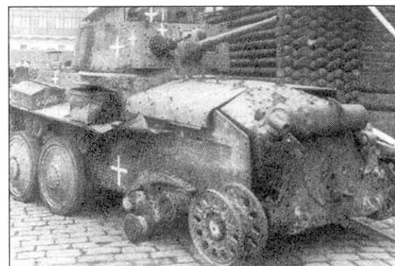
Любопытный гибрид: башня Ausf. G на корпусе Ausf. D. Глушитель поднят вверх. Обратите внимание на вертикальное крепление в центральной части глушителя.
