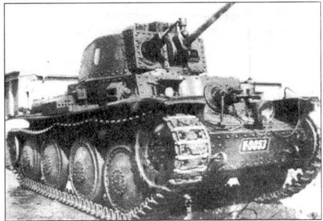
На этой редкой фотографии хорошо видны съемное осветительное оборудование танка. Такое оборудование также несли словацкие LT-38 и немецкие PzKpfw 38(t).
