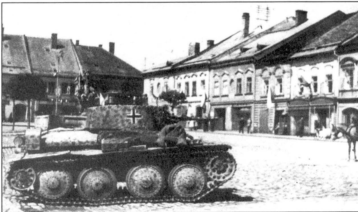
РзКрфw 38(t) в необычном камуфляже. Эта фотография сделана в начале мая 1945 года на главной площади богемского города Полчка. В металлическом ящике на правом крыле танка находится пальная лампа, с помощью которой облежали пуск двигателя в холода.
