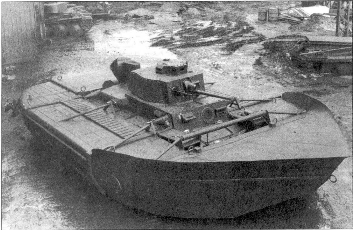
Редчайшая фотография танка PzKpfw 38(t), оснащенного понтоном AP-1. С помощью этого понтона танк мог плавать.
