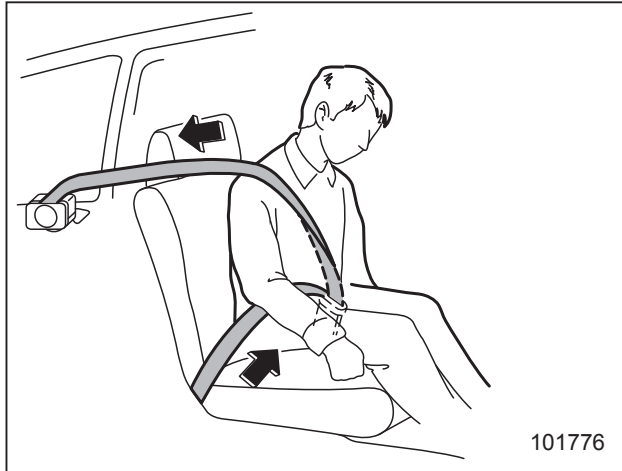
Преднатяжитель ремня безопасности заднего сиденья
