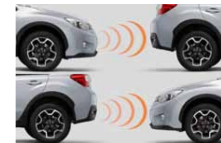
65 Voor / achter ultrasoon parkeerhulpsysteem. SEBOYA2100/SEBOYA2000 Veilig en gemakkelijk parkeren met behulp van 4 sensoren. Acoustische en visuele waarschuwing. Aansluitbekabeling noodzakelijk
