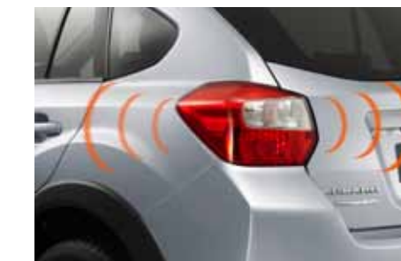
66 Noodstopverlichting H705EFJ000 Dubbelwerkend systeem. Zijknipperlichten knipperen 4 maal en de alarmverlichting treedt in werking bij een noodstop
