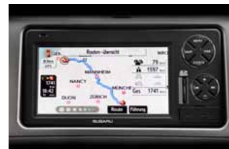
63 Navigatiesysteem SEAWF26000 5,8" touchscreen met "click and slide" bediening. Op SD-card gebaseerd navigatiesysteem met verbindingsopties naar persoonlijke mediaplayers en mobiele telefoons.
