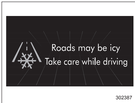
Экран предупреждения о возможном обледенении дорожного покрытия
