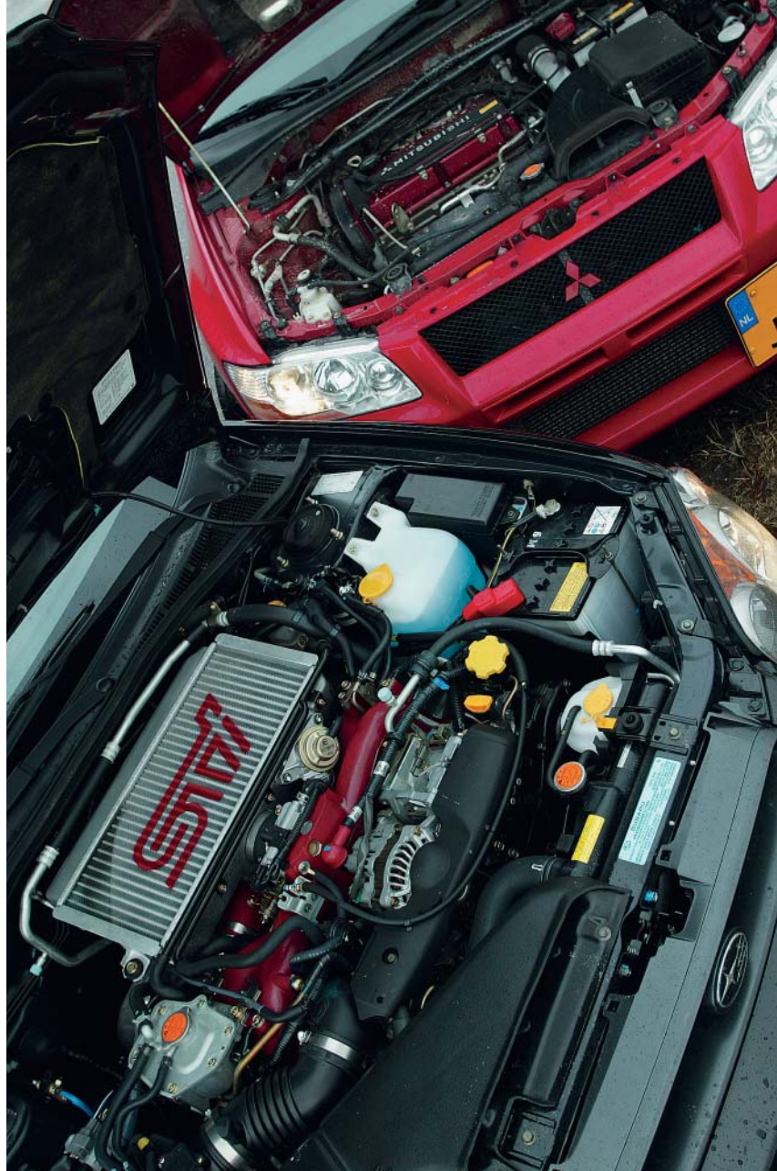
Twee keer een geblazen tweeliter. De boxer van de Subaru Impreza haalt er 265 pk en 343 Nm uit. De Mitsubishi schopt het tot 280 pk en 383 Nm. De trekkracht onderin de boxer valt tegen. Als bij 4.000 de turbo mee gaat doen, wordt 't leuker.
